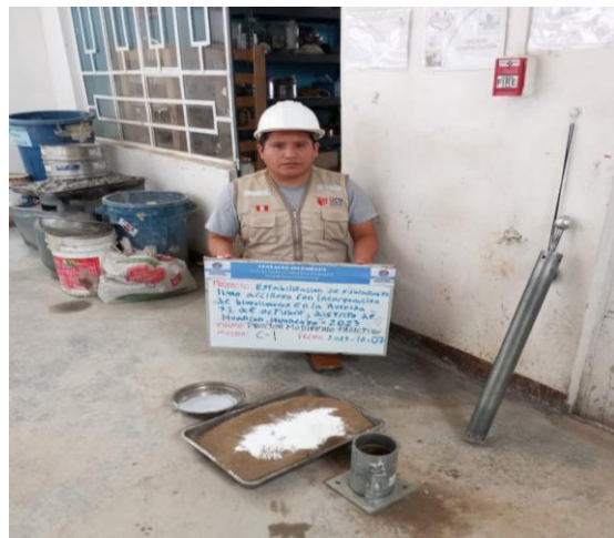
Figura 6. Ensayo de Proctor modificado
