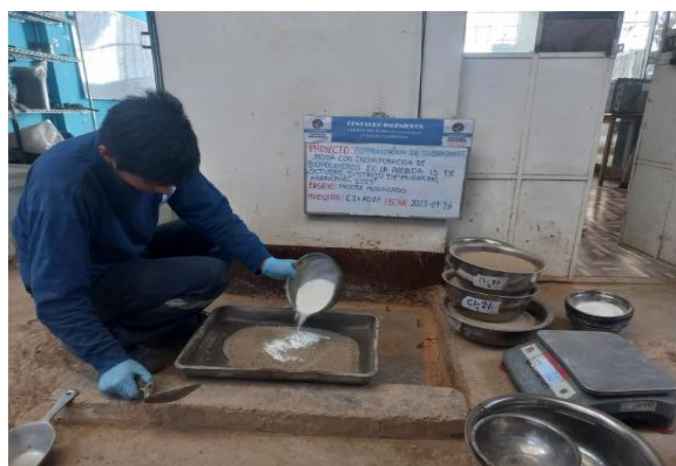
Figura 8. Reforzamiento del suelo con goma xanthan
