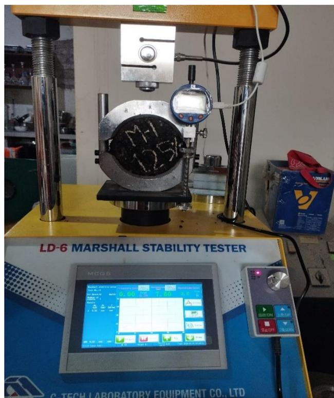
**Figura 115.** Pastillas de asfalto reciclado mediante el fresado en frío y RC-250
