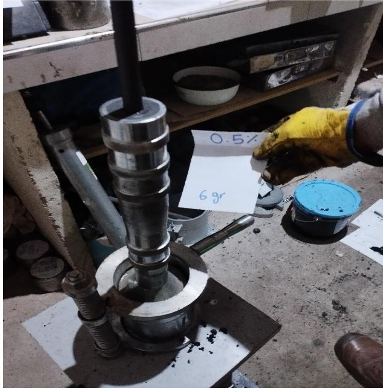
**Figura 101.** Compactación y preparación de pastilla de asfalto
