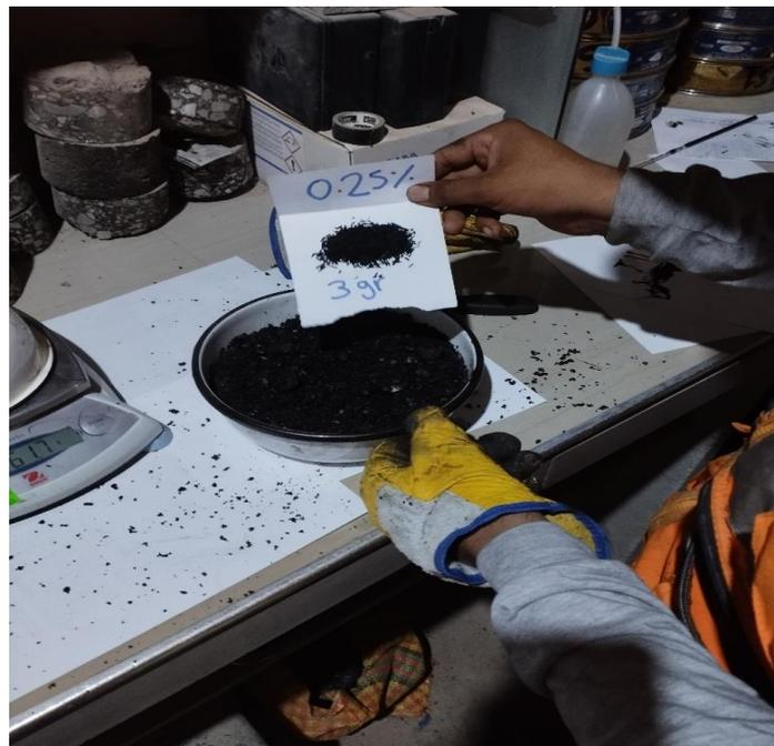
**Figura 100.** Adición del 0.25% de fibra de caucho
