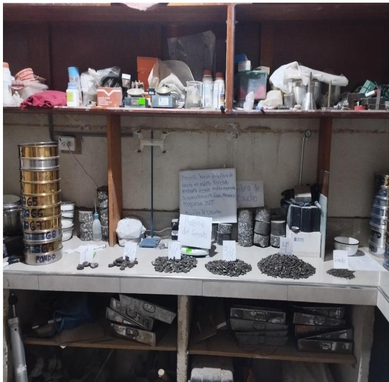
**Figura 31.** Granulometría del material del asfalto
