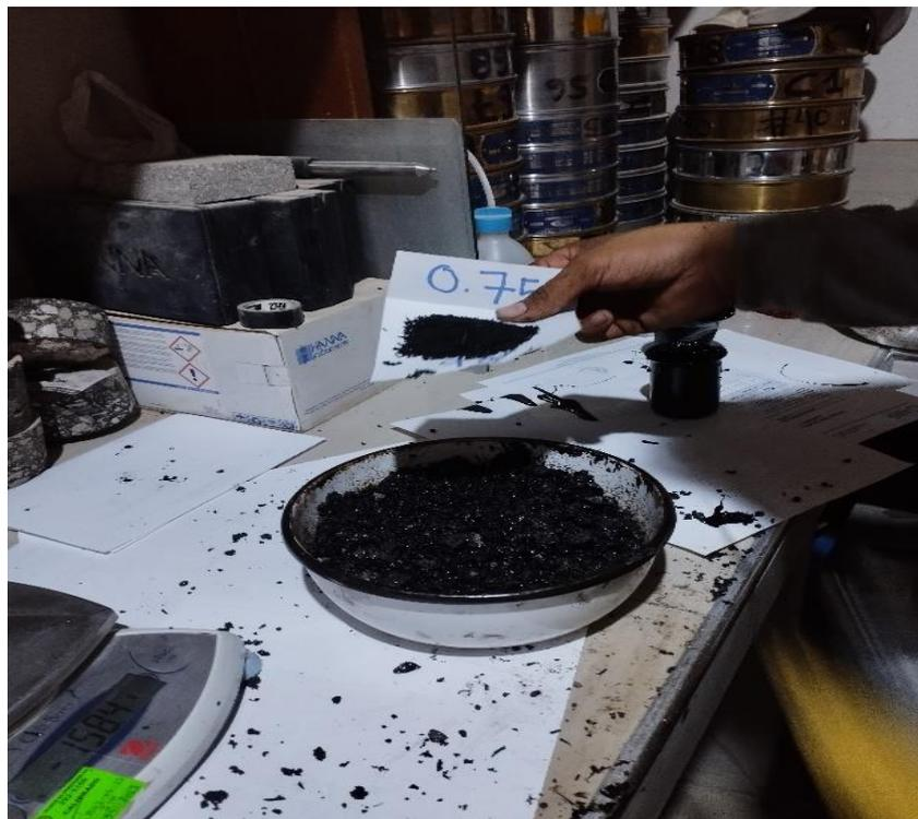
**Figura 102.** Preparación de pastilla de asfalto
