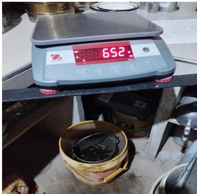
**Figura 55.** Peso de la muestra sumergida del agregado grueso
