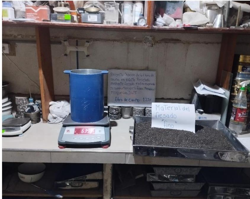
Figura 42. Muestra del agregado fino del material del asfalto reciclado
