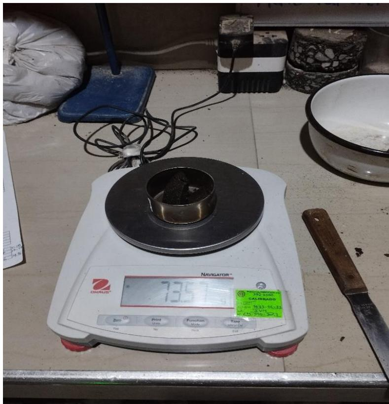
Figura 69. Peso de la muestra húmeda del material
