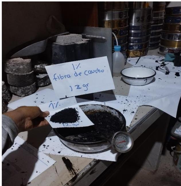
**Figura 104.** Adición de 1% de fibra de caucho
