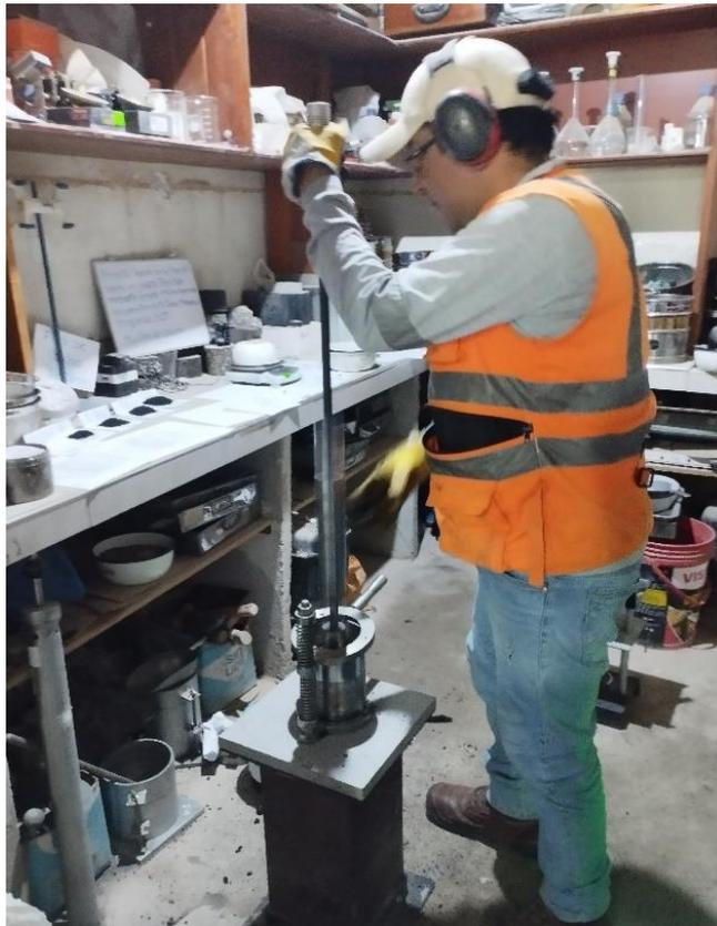
**Figura 106.** Compactación al 1% de fibra de caucho
