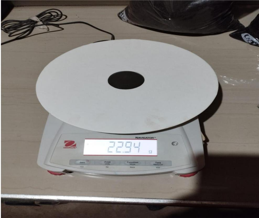
Figura 18. El peso del filtro para el asfalto reciclado
