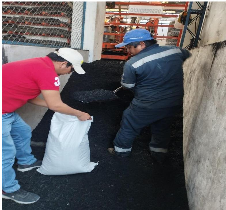
**Figura 77.** Muestra de fibra de caucho reciclado de las llantas
