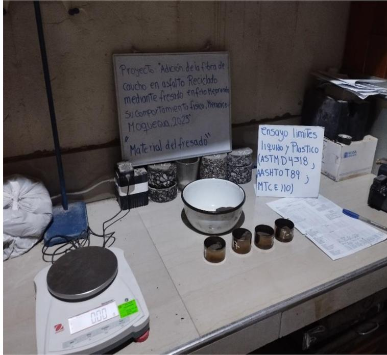
Figura 70. Límite líquido del material de fresado en frío
