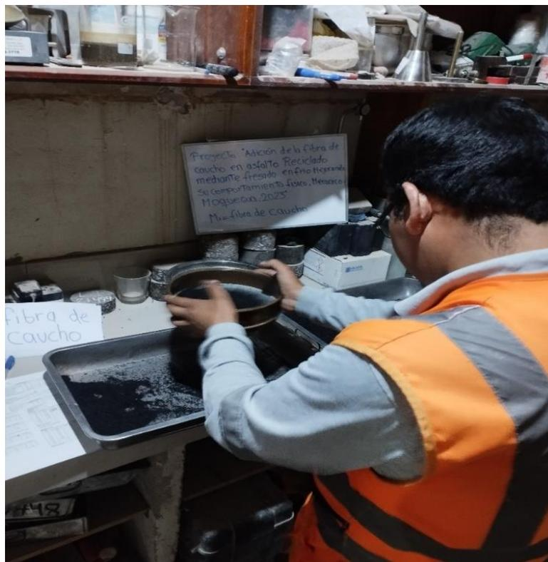
**Figura 83.** Tamizaje de fibra de caucho
