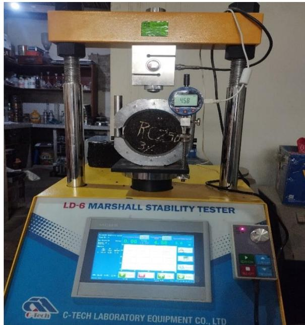
**Figura 112.** *Pastillas patrón de asfalto reciclado con RC-250 al 3%*
