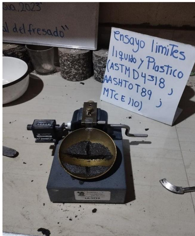
Figura 67. Ensayo de límites de plasticidad del material reciclado
