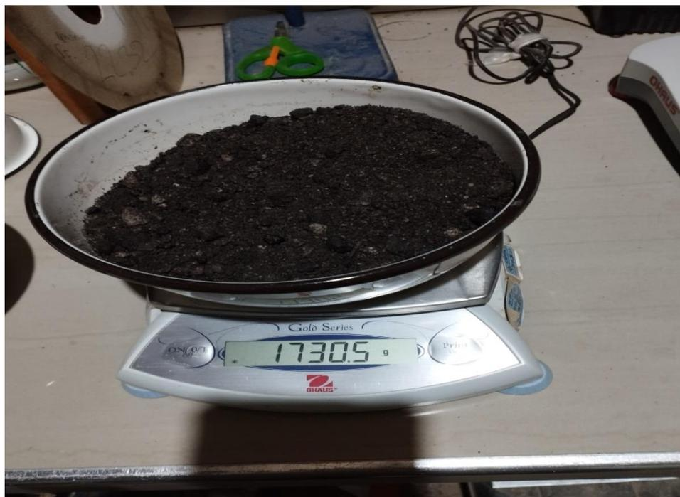
Figura 17. Muestra asfalto reciclado mediante el fresado en frío 110°
