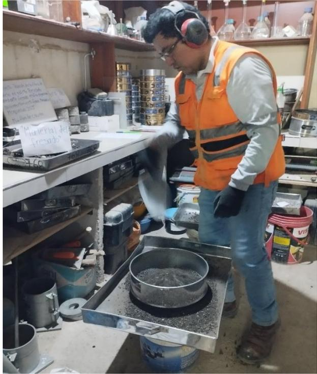
Figura 28. Separación del agregado por la malla N°4
