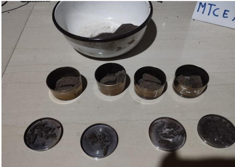
Figura 72. Muestra del límite plástico del material
