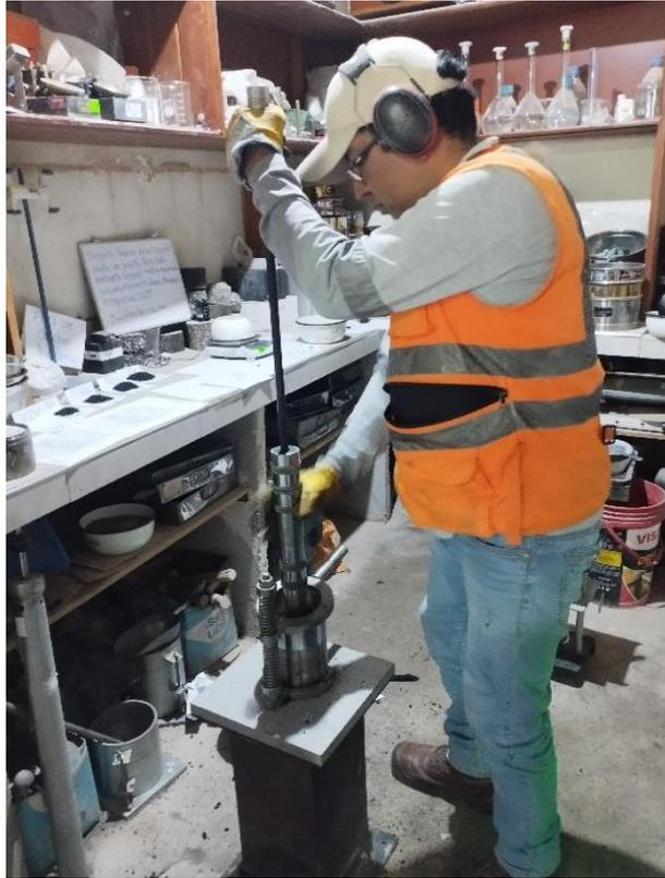
**Figura 103.** Compactación con la adición del 0.75% de fibra de caucho
