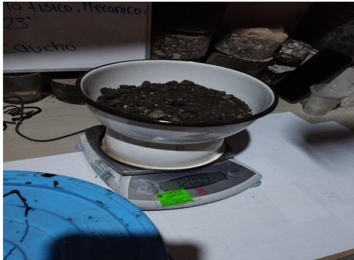
**Figura 99.** Muestra de 1200gr de asfalto reciclado
