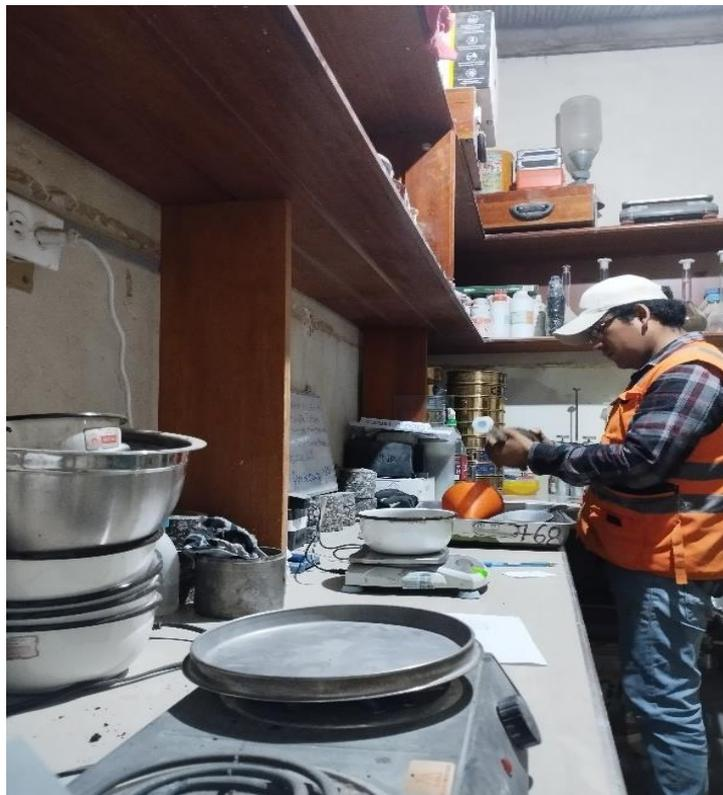
**Figura 51.** Muestra saturada en una fiola
