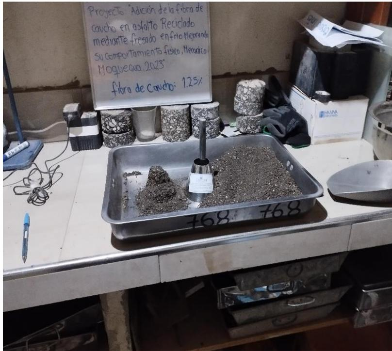
**Figura 48.** *Compacta a 25 golpes por capa con una varilla*
