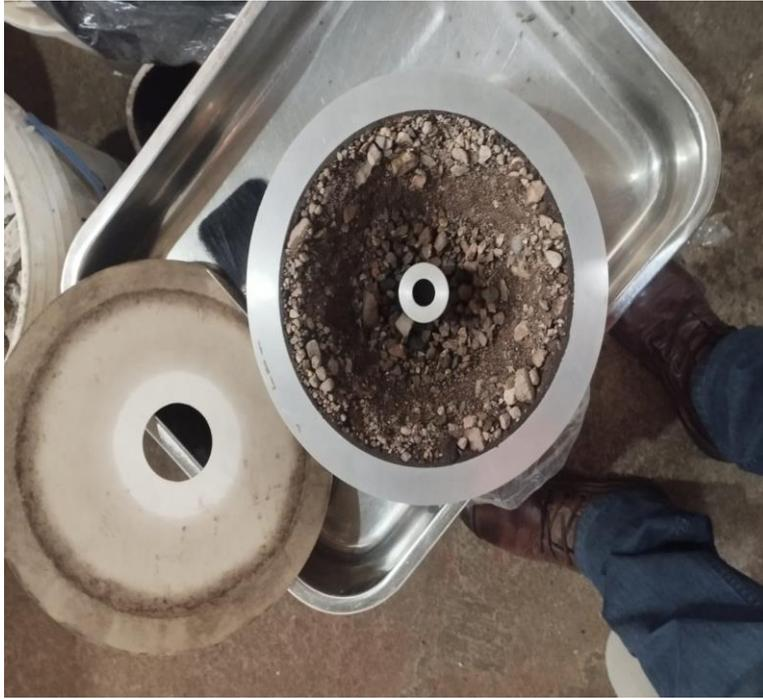
**Figura 24.** *Muestra de asfalto reciclado mediante el fresado en frio*
