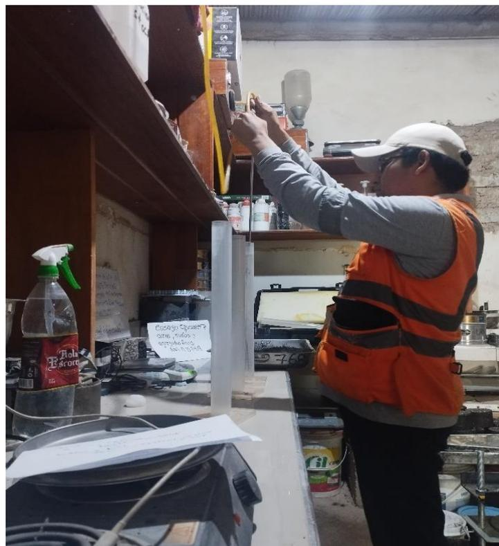
**Figura 61.** Llenado de probetas con solución stock hasta las 4 pulg
