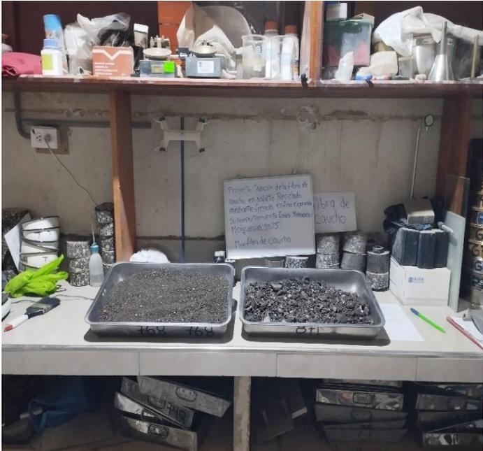
Figura 29. Material pasante de la malla N°4 del agregado fino
