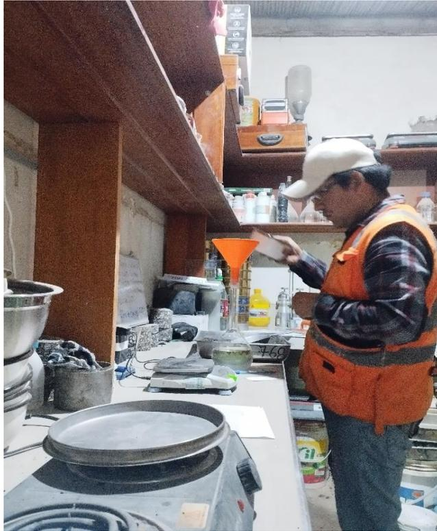
**Figura 50.** Muestra es saturada en una fiola
