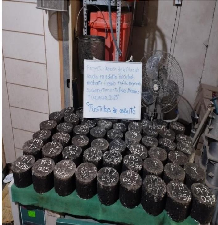
**Figura 107.** Pastillas con RC-250 y fibra de caucho
