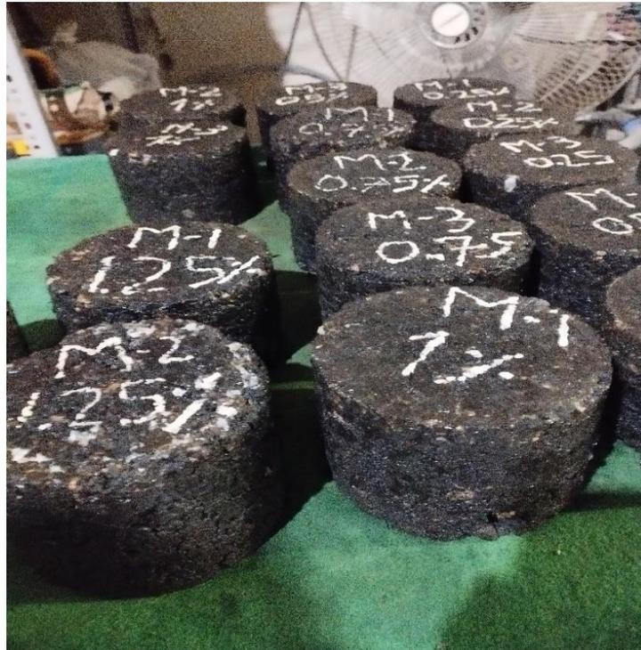
**Figura 110.** Pastillas de asfalto reciclado saturados
