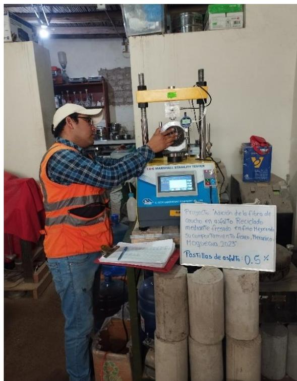
**Figura 114.** Pastillas de asfalto reciclado con fibra de caucho al 0.5%
