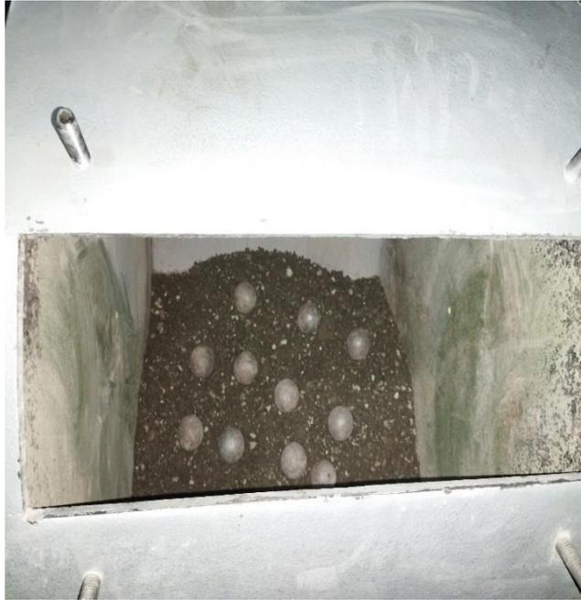
Figura 38. Degradación del material del asfalto reciclado en frío
