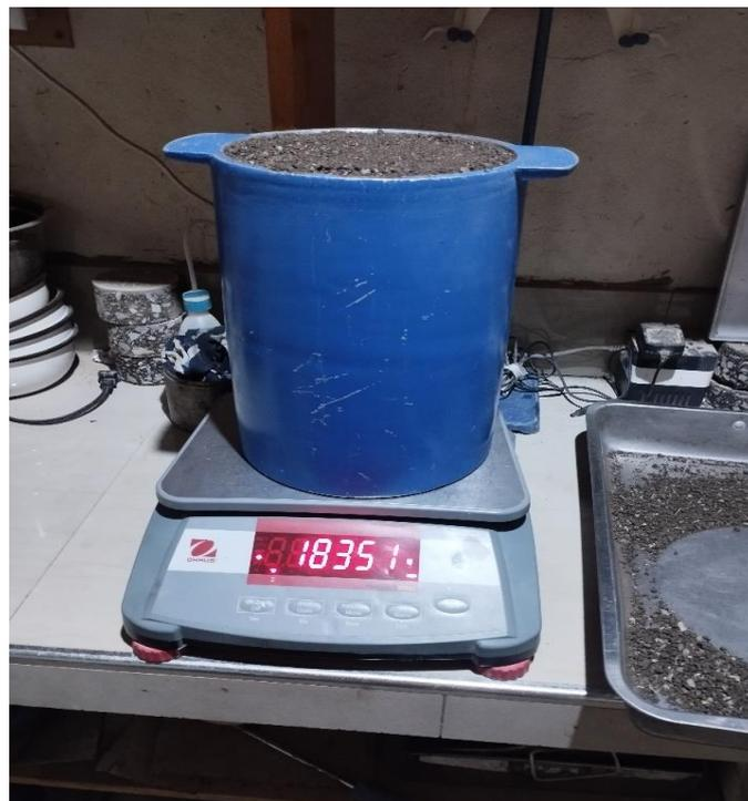
Figura 45. Peso de muestra del material del asfalto reciclado
