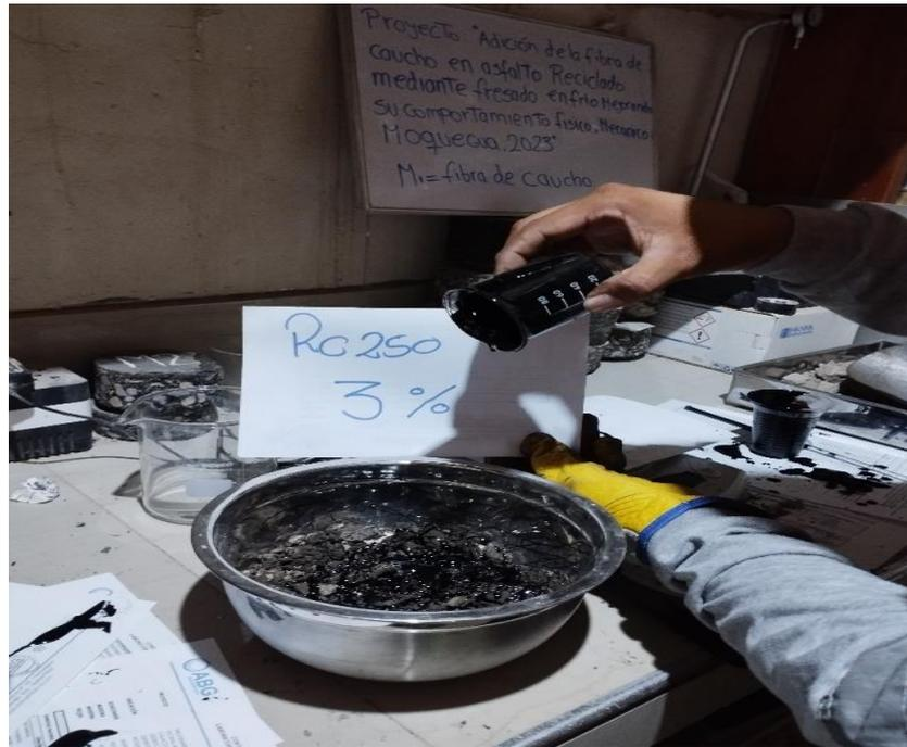
**Figura 95.** Mezcla de RC-250 al 3% según el porcentaje de 36 gr
