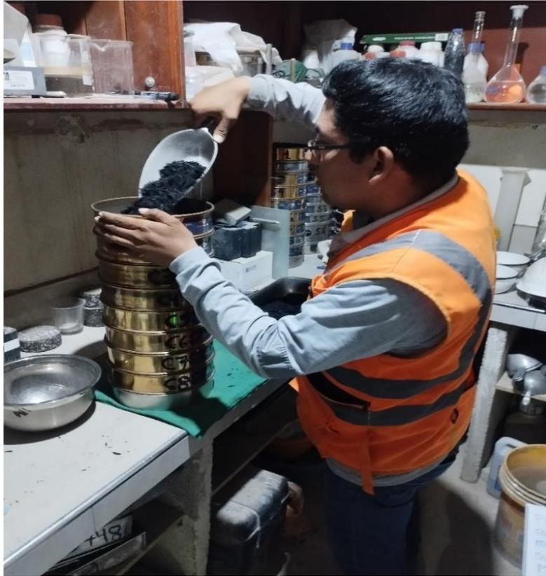
**Figura 82.** Granulometría de la fibra de caucho
