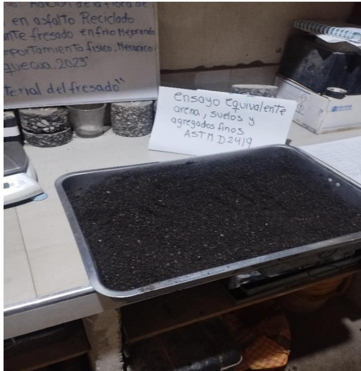
**Figura 60.** Material del asfalto reciclado pasante de la malla N°4
