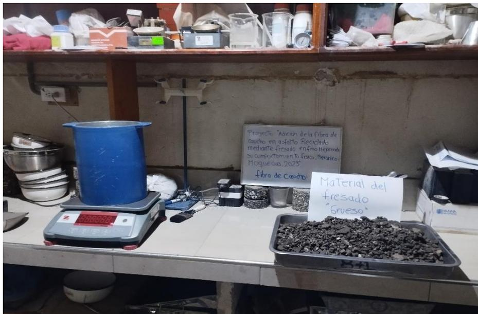
Figura 39. Peso unitario del agregado grueso del material
