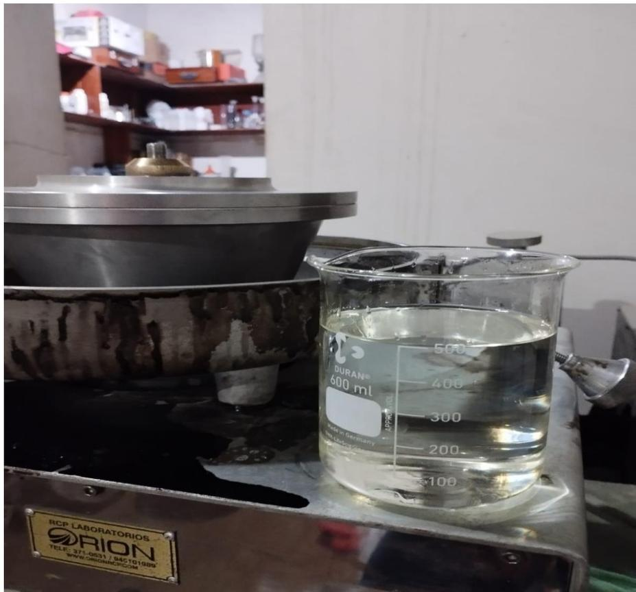
Figura 19. Lavado asfáltico con gasolina de 95 premium
