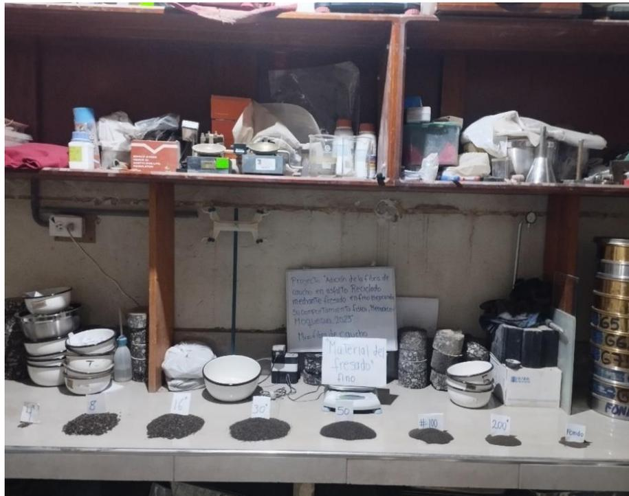
Figura 34. Clasificación y pesaje de retenidos de las mallas
