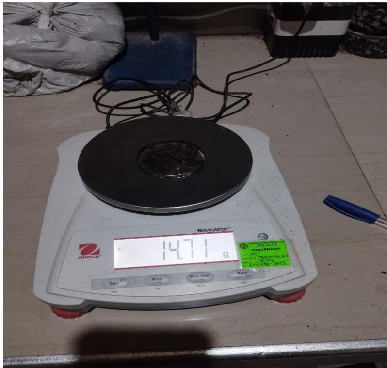
Figura 71. Muestra del límite plástico del material
