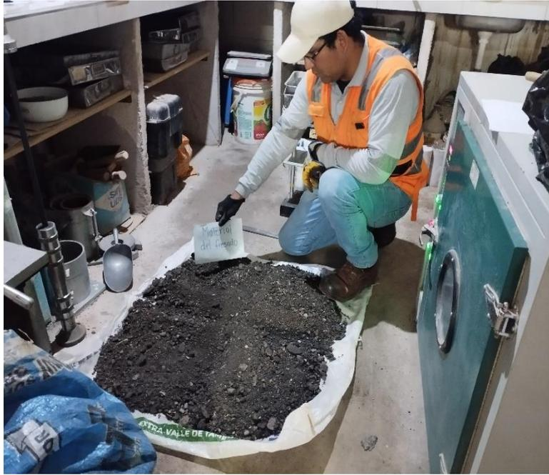
**Figura 26.** Cuarteo de muestra de asfalto reciclado en frío
