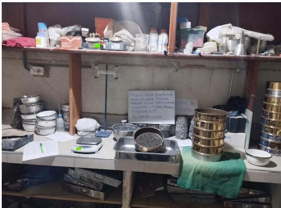
**Figura 33.** Granulometría del agregado fino del material de asfalto
