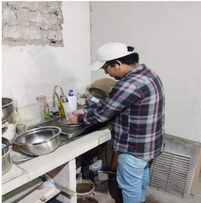
**Figura 53.** Lavado de muestra saturada
