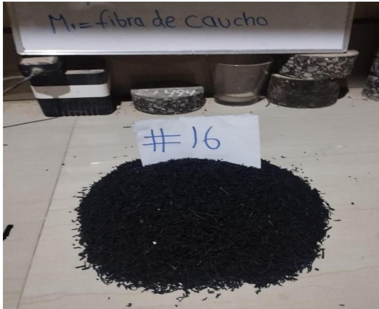
**Figura 86.** Fibra de caucho retenida en el tamiz N°16
