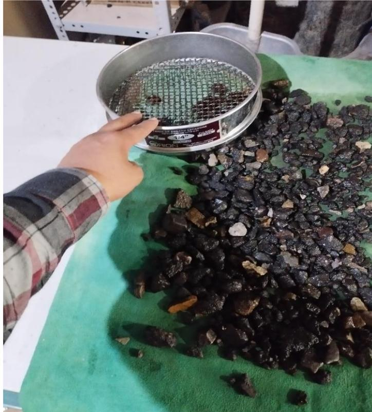
**Figura 54.** Secado superficial de la muestra saturada
