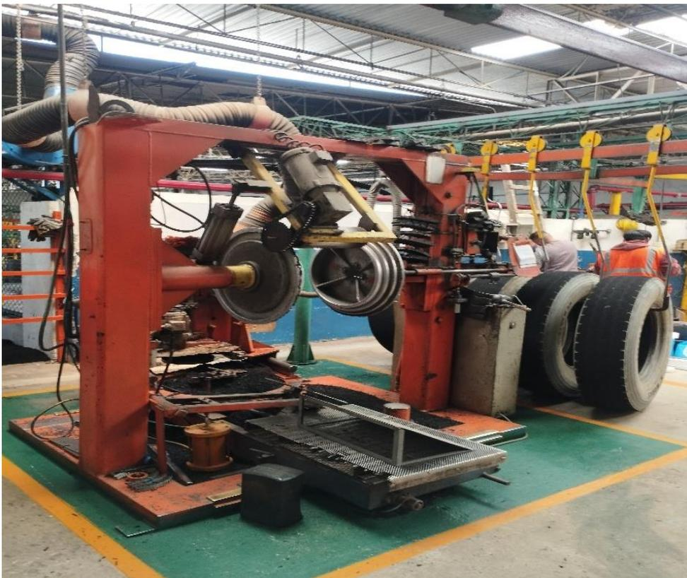
**Figura 75.** *Raspado de neumáticos*
