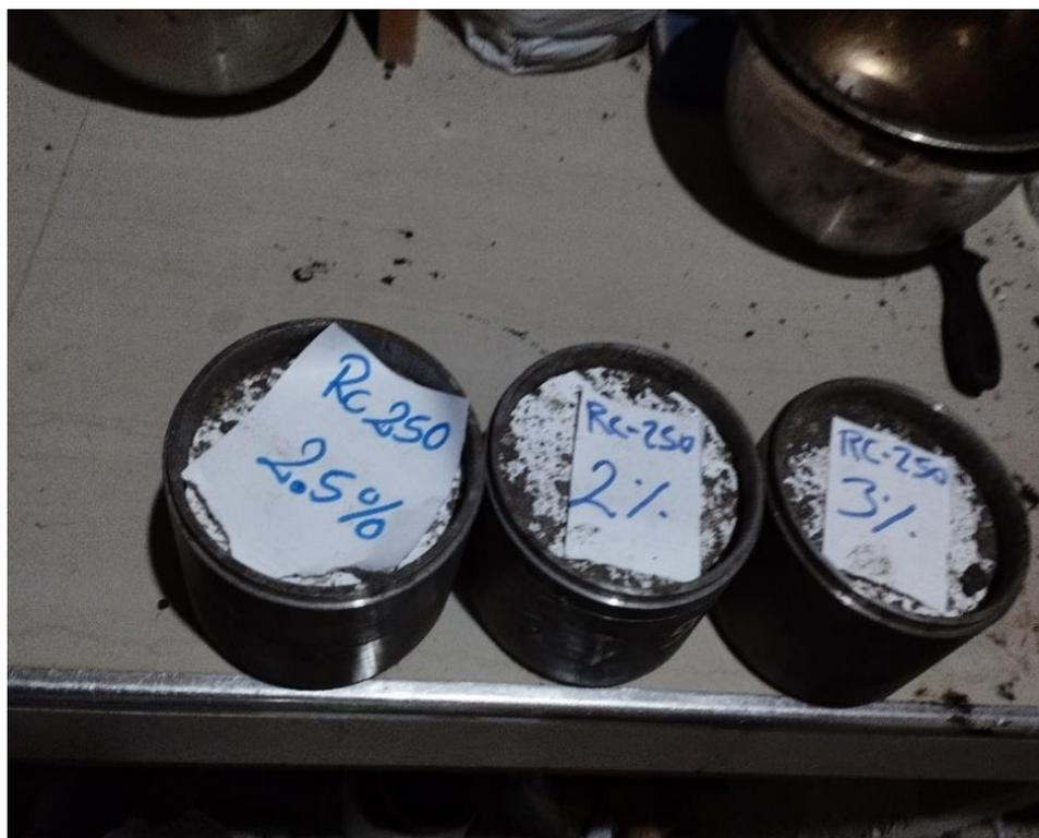
**Figura 96.** Pastillas con RC-250 al 2%, 2.5% 3%
