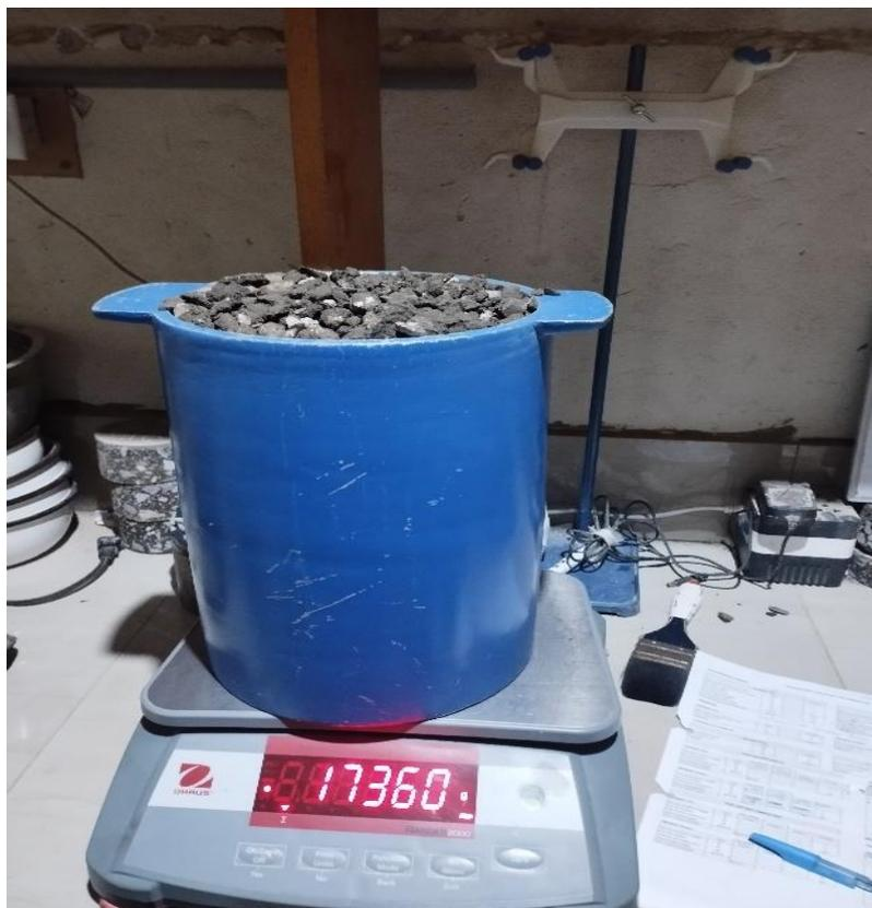
**Figura 41.** Peso de la muestra del material del asfalto reciclado
