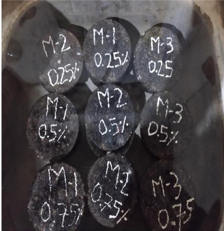
**Figura 109.** Pastillas de asfalto reciclado saturado en 5 minutos
