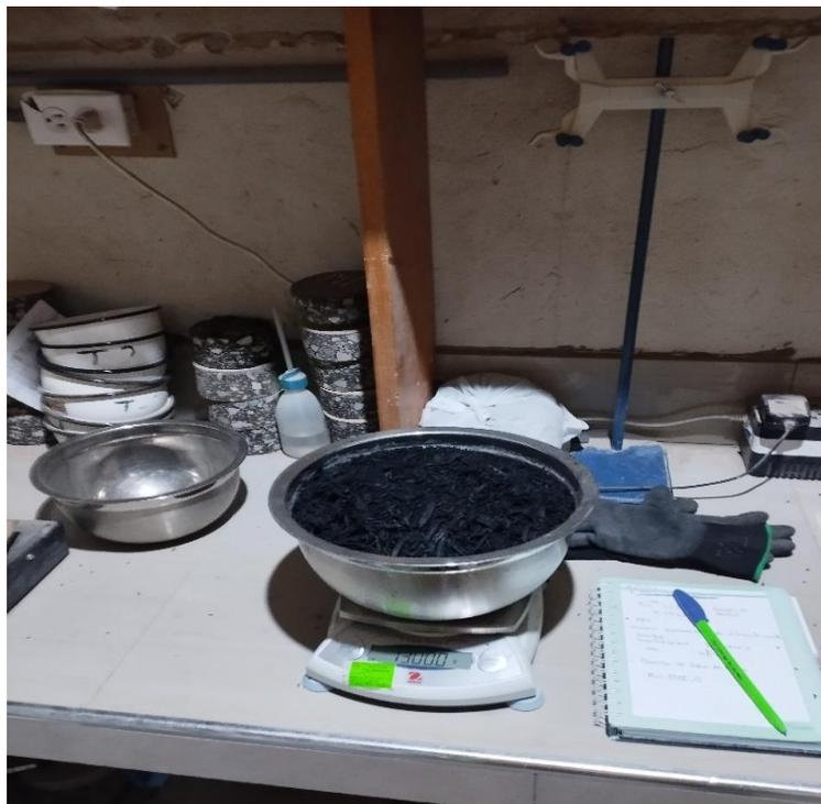
**Figura 81.** *Muestra de fibra de caucho representativa*
