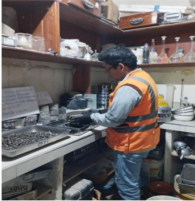
**Figura 30.** Granulometría del agregado grueso
