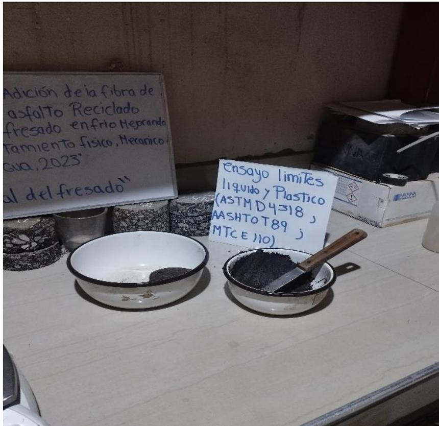
Figura 66. Material pasante de la malla N°40 el cual es saturado y mezclado
