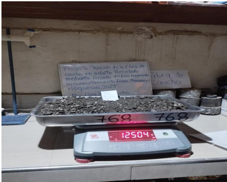
**Figura 27.** Pesaje y llevado al horno a una temperatura de 110°
