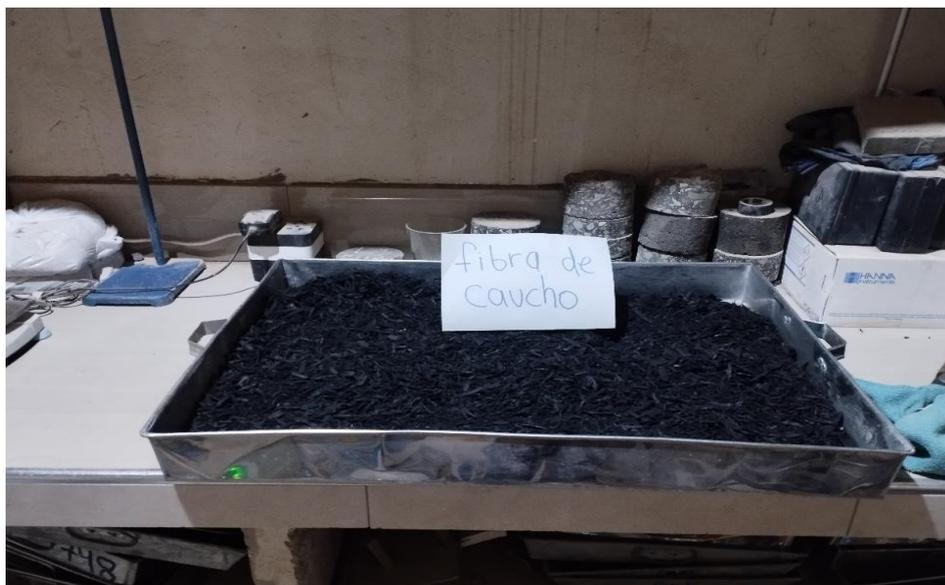
**Figura 79.** Muestra de fibra de caucho reciclado de las llantas
