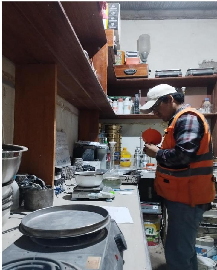
**Figura 49.** *Peso de la muestra del asfalto reciclado*
