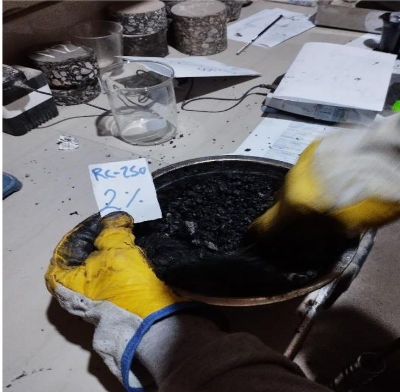
**Figura 93.** Mezcla de RC-250 al 2% según el porcentaje de 24gr
