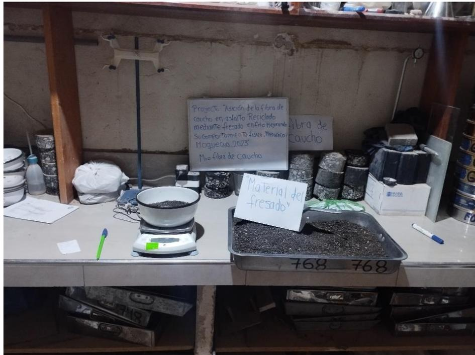
**Figura 32.** Granulometría del agregado fino del material de asfalto
