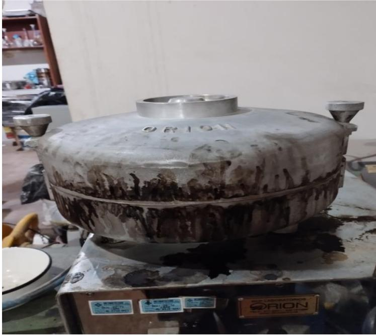
**Figura 22.** Centrifuga para el lavado asfáltico del material
