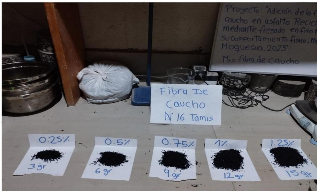
**Figura 97.** Adición de fibra de caucho al 0.25% ,0.5% ,0.5% , 1% , 1.25%
