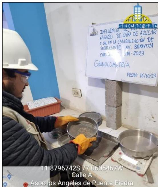
Figura 18. Análisis granulométrico.
