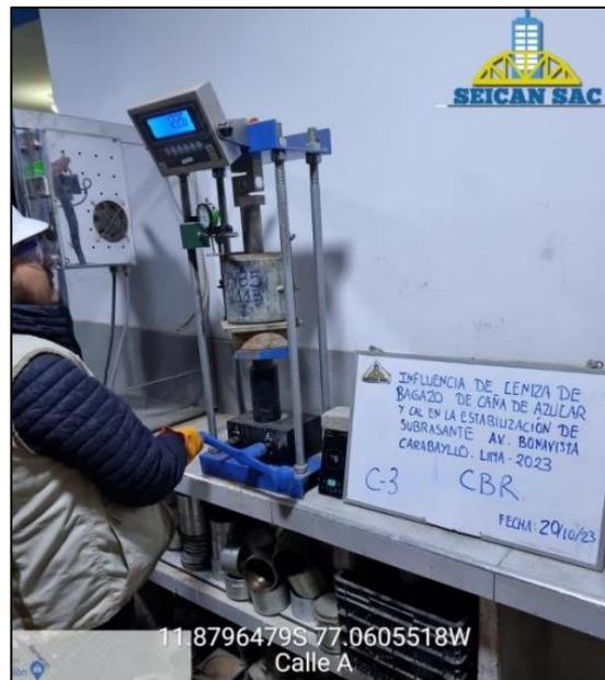
Figura 24. Ensayo CBR.
