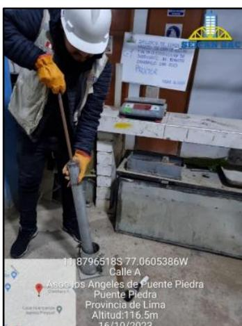
Figura 8. Ensayo Proctor Modificado MTC E 115.
