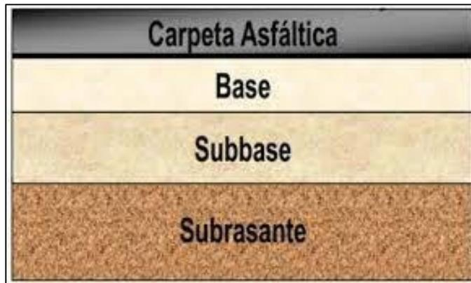
Figura 2. Configuración común de pavimento flexible.
