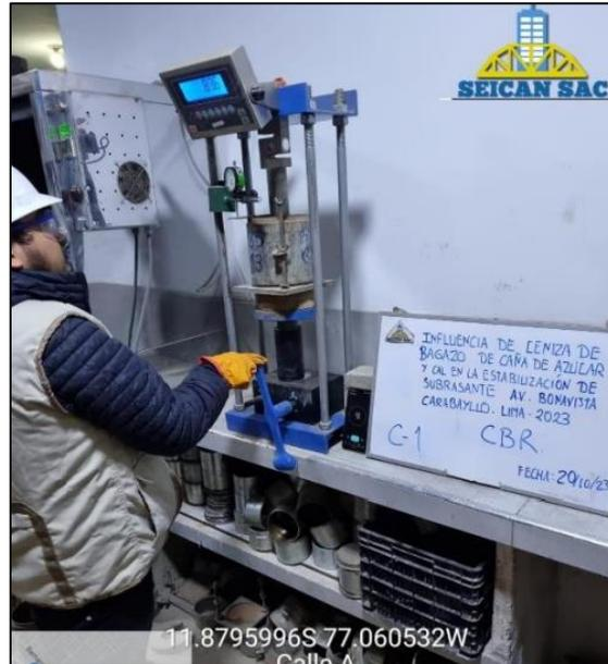
Figura 23. Ensayo CBR.
