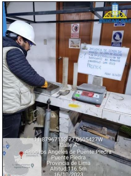
Figura 21. Ensayo Proctor Modificado.
