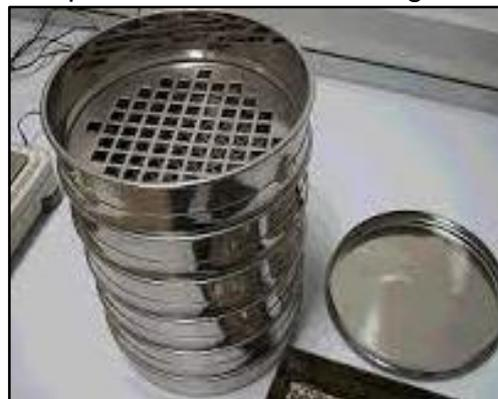
Figura 4. Tamices utilizados en la evaluación de la granulometría.
