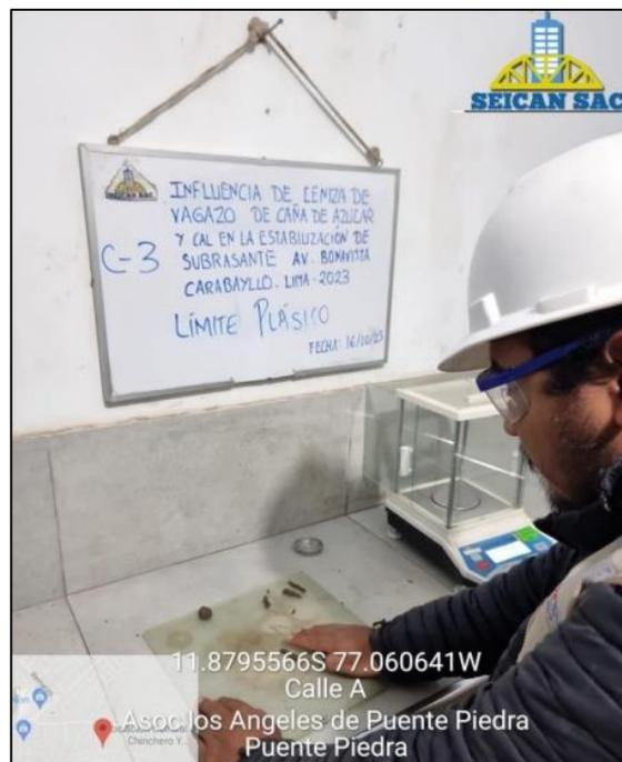
Figura 20. Ensayo de Limite Plástico
