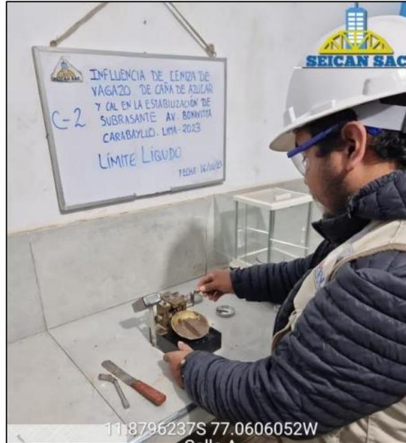
Figura 19. Ensayo de Limite Liquido.
