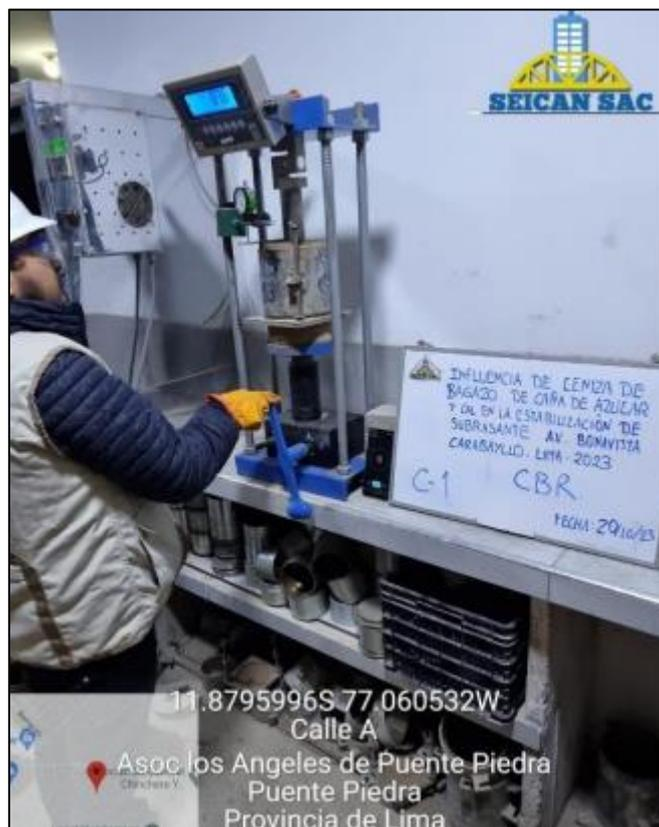
FOTO N° 08 ensayo de CBR
