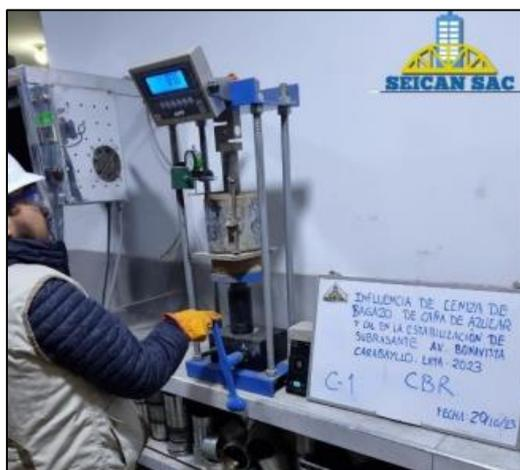
*Figura 9.* Ensayo CBR.
