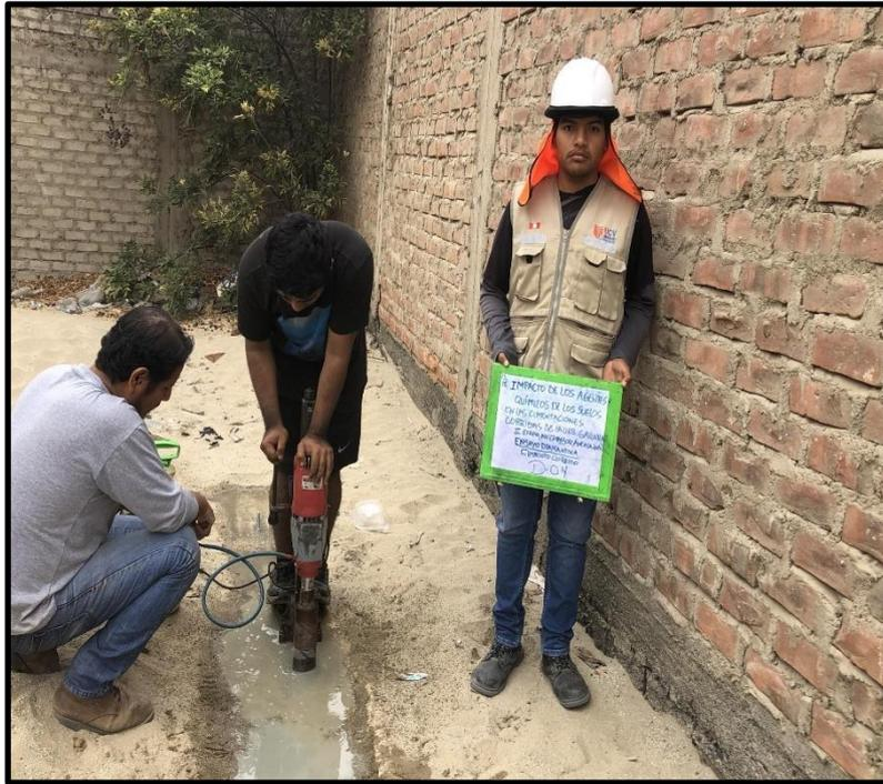
**Ilustración 18:** Extracción de testigo diamantino "D-4" en el cemento corrido
