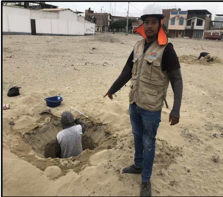
**Ilustración 8: Excavación de la calicata "C3"**
