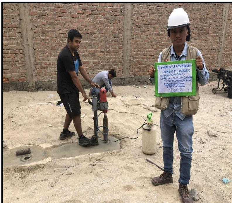
**Ilustración 14:** Extracción de testigo diamantino "D-2" en el cemento corrido
