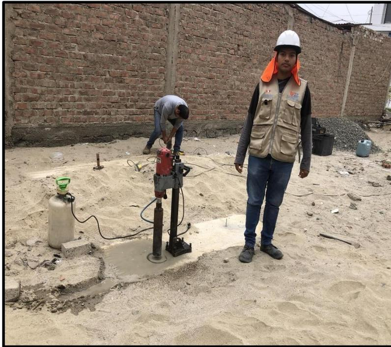
**Ilustración 12:** Extracción de testigo diamantino “D-1” en el cimiento corrido
