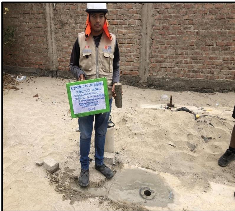
**Ilustración 13:** Ensayo de diamantina en el cemento corrido
