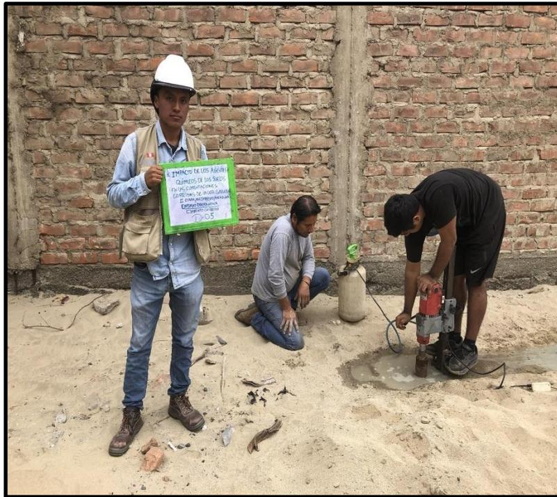
**Ilustración 20:** Extracción de testigo diamantino “D-5” en el cemento corrido
