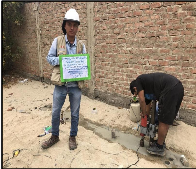
**Ilustración 16:** Extracción de testigo diamantino "D-3" en el cemento corrido
