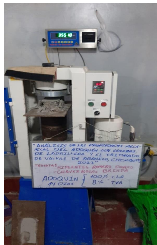
Ensayo de resistencia a la compresión de los adoquines (muestra patrón e implementación de triturado de valvas de abanico y ceniza de ladrillera artesanal)
