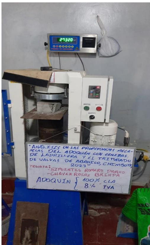
Ensayo de resistencia a la compresión de los adoquines (muestra patrón e implementación de triturado de valvas de abanico y ceniza de ladrillera artesanal)
