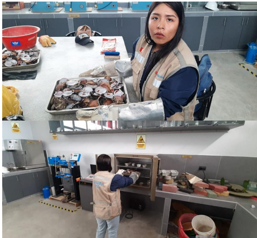
Limpieza, colocación al horno y trituración de valvas de abanico
