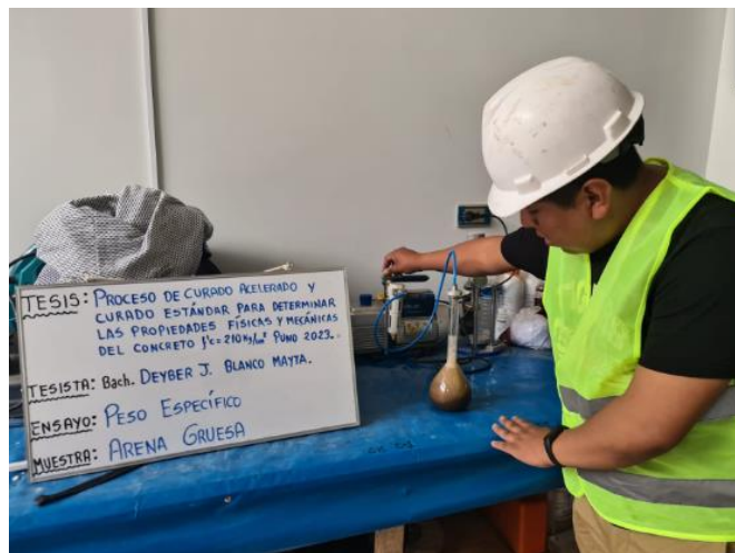
Figura 21: Eliminación de Aire Mediante la Bomba de Vacíos
