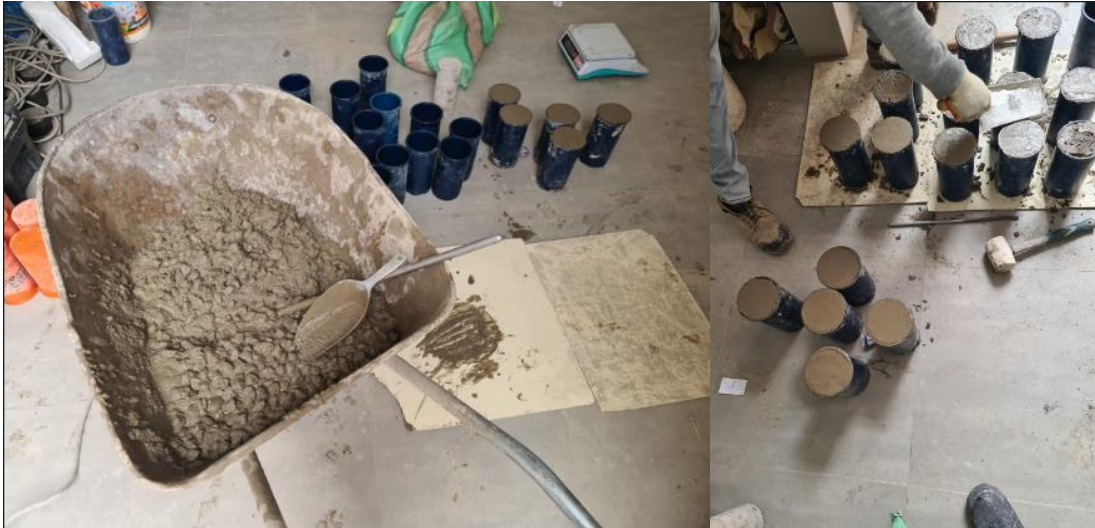
Figura 40: Proceso de Moldeo de Testigo de Concreto
