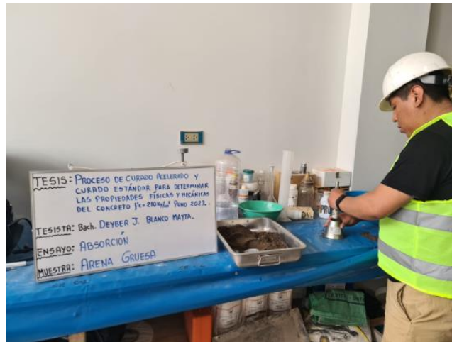
Figura 24: Proceso de Absorción de Agregado Fino
