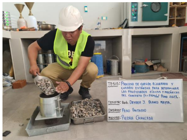
Figura 8: Proceso de Moldeo del Agregado (Piedra Chancada)
