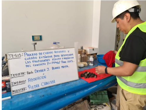
Figura 26: Proceso de Secado del Agua excedente de la piedra chancada
