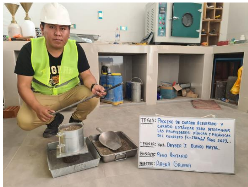
Figura 12: Termino Compactado - Pesaje Correspondiente
