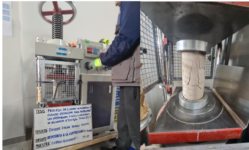
Figura 56: Proceso de Rotura del concreto
