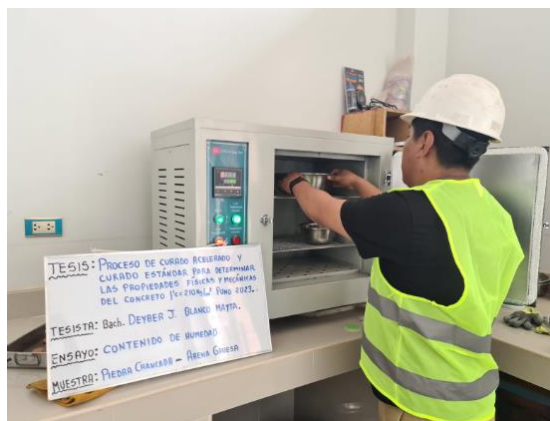
Figura 19: Proceso de Sacado del Horno para posterior Pesaje.
