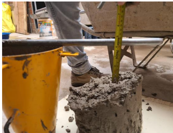
Figura 38: Resultados de la Prueba de Slump
