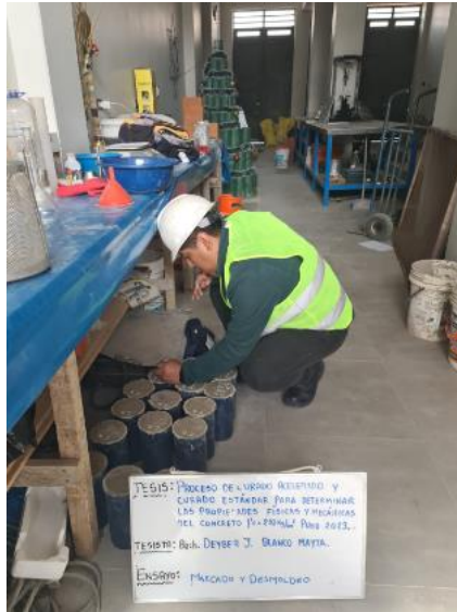
Figura 42: Des moldaje y Marcación de testigos
