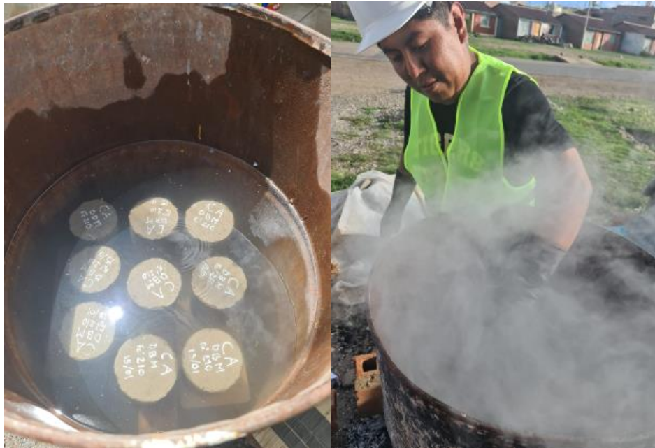
Figura 46: introducción de los testigos en la posa de curado acelerado
