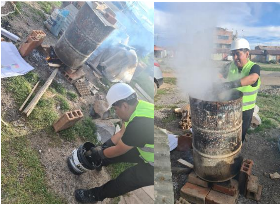
Figura 44: Introducción de los testigos en la poza de curado acelerado
