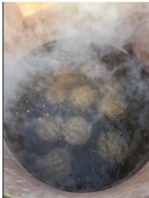
Figura 47: Proceso de ebullición de los Probetas de concreto
