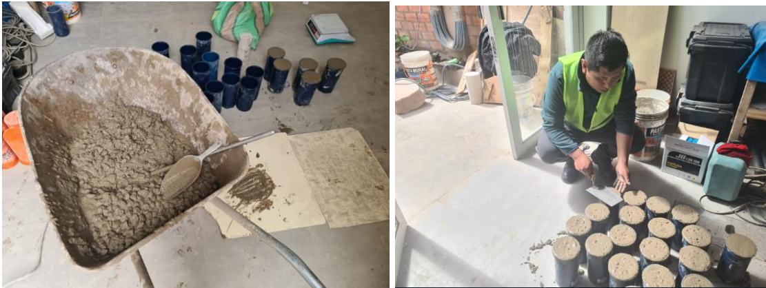
Figura 59: Moldeo de Probetas - Curado Estándar
