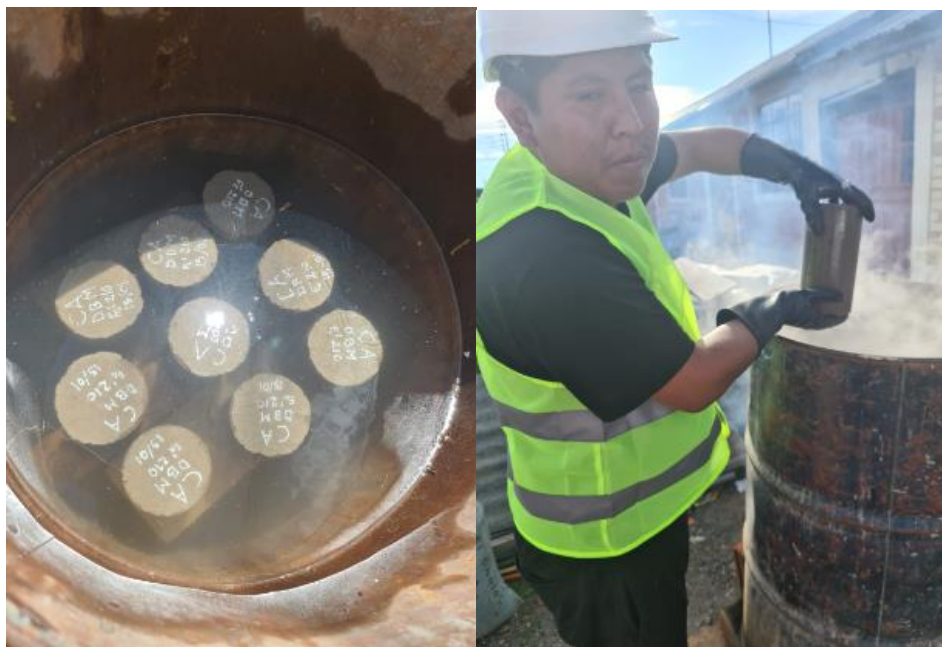
Figura 48: introducción de los testigos en la posa de curado acelerado
