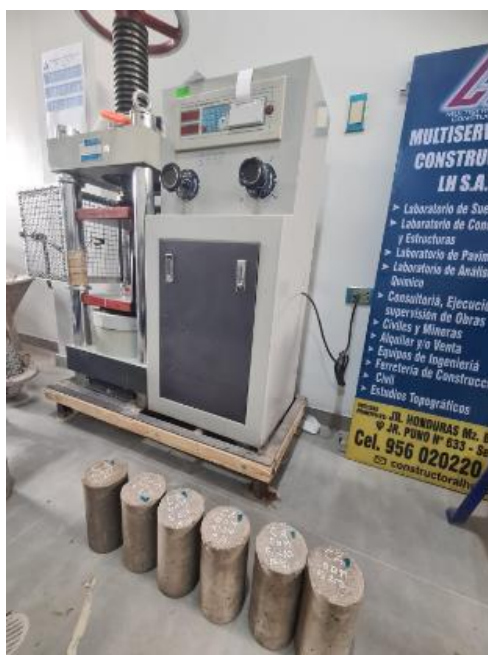
Figura 50: Proceso de rotura de briquetas de concreto
