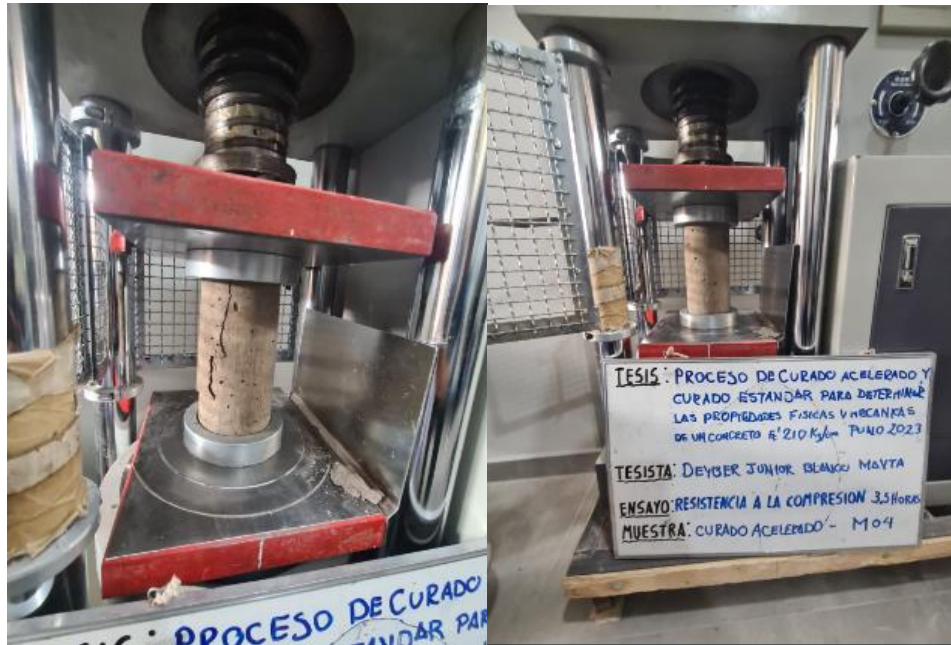
Figura 52: Proceso de Rotura de Elementos de concreto
