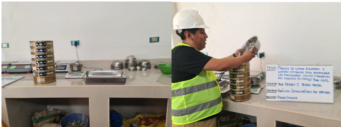
Figura 33: PROCESO DE TARADO DEL AGREGADO GRUESO
