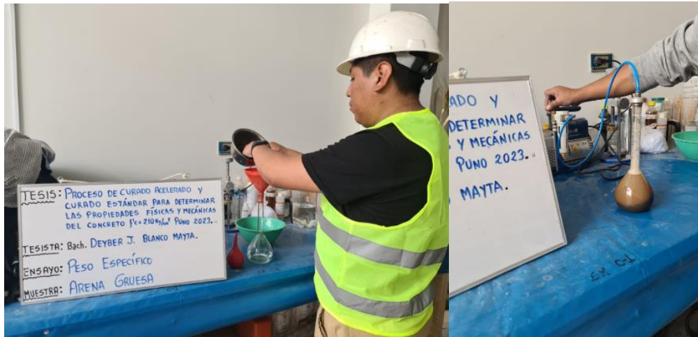
Figura 20: Determinación del Peso Específico del Agregado Fino
