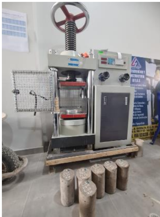
Figura 53: Proceso de Rotura de Testigo de Concreto
