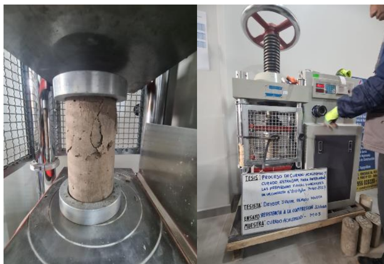
Figura 51: Proceso de Rotura de Testigo de Concreto
