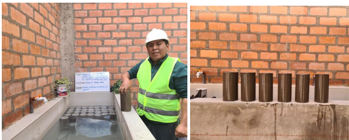
Figura 61: Sacado de Probetas de Concreto
