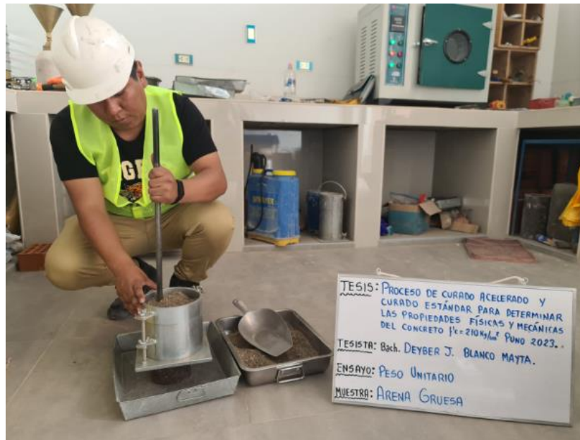
Figura 11: Proceso de Compactado - Agregado Fino
