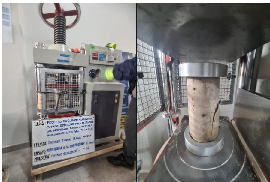
Figura 55: Proceso de rotura de concreto
