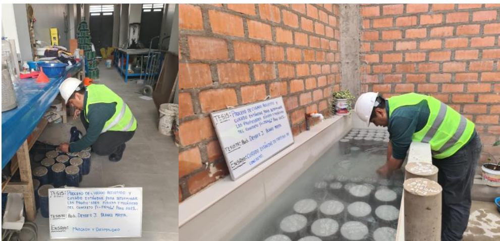
Figura 60: Desmóldelo y Sumergido en posas de curado
