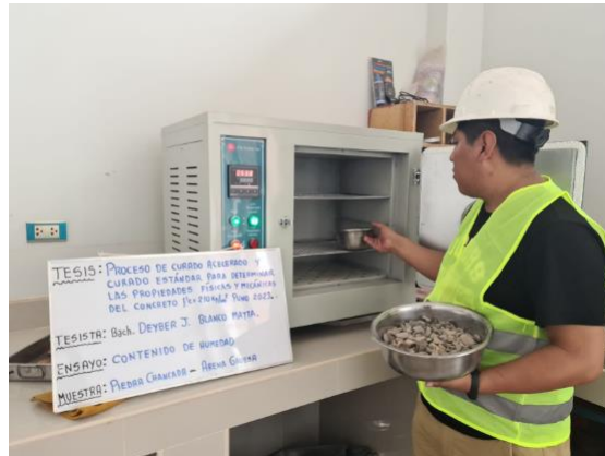
Figura 18: Proceso de Secado de Muestras en el Horno de Secado
