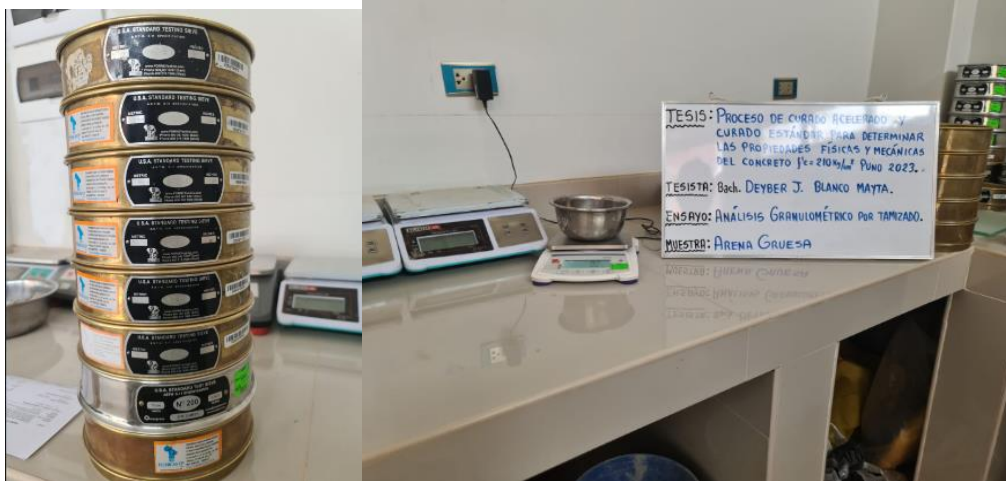
Figura 30: Proceso de Tarado de la muestra del Agregado Fino
