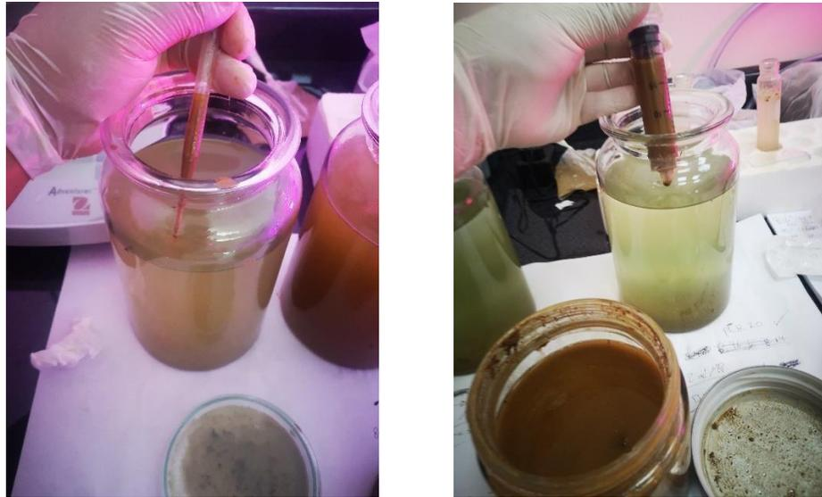
**Figura N°32** Aplicación de la concentración de metales pesados en los pomos de filtro para la remoción
