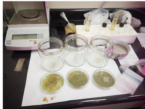
**Figura N°31** Aplicación de la biomasa en los pomos de filtro para la remoción
