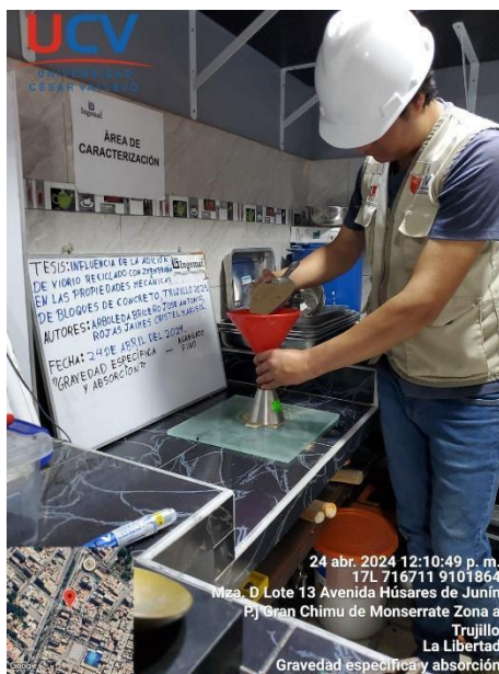
Figura 17. Ensayo de Gravedad Específica de los agregados.
