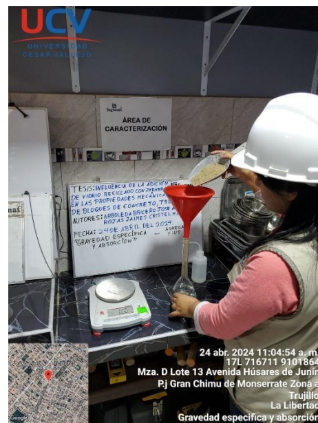
Figura 17. Ensayo de Gravedad Específica de los agregados.
