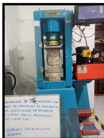
Figura 32. Post ensayo F'c
