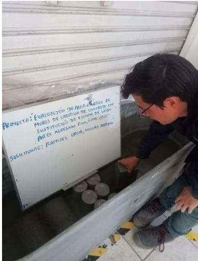
Foto 3: Ensayo de Absorción
