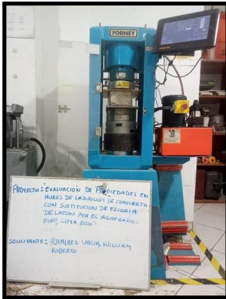
Figura 28. Pre ensayo c. simple
