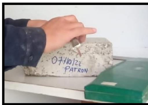
Figura 17. Ensayo variación dimensional
