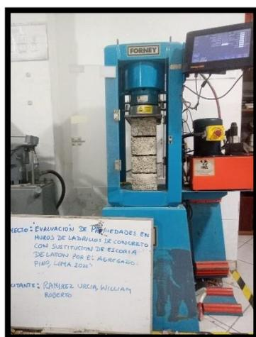
Figura 31. Ensayo F'b
