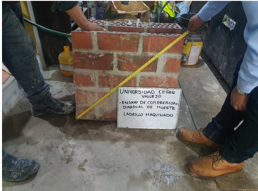
Figura 35. Medición diagonal del murete de ladrillo maquinado para ensayar
