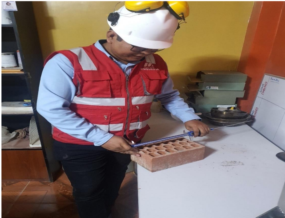
Figura 27. Medición de las longitudes del ladrillo maquinado
