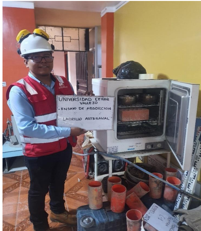
Figúra 31. Ladrillo puesto en horno para su secado después de ser sumergido
