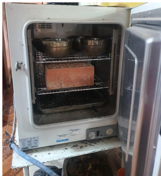
Figúra 14. Unidad de ladrillo luego de pasar 24 horas en el horno.
