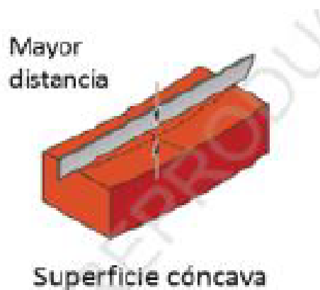
Figura 2. Medida del alabeo en superficie cóncava.
