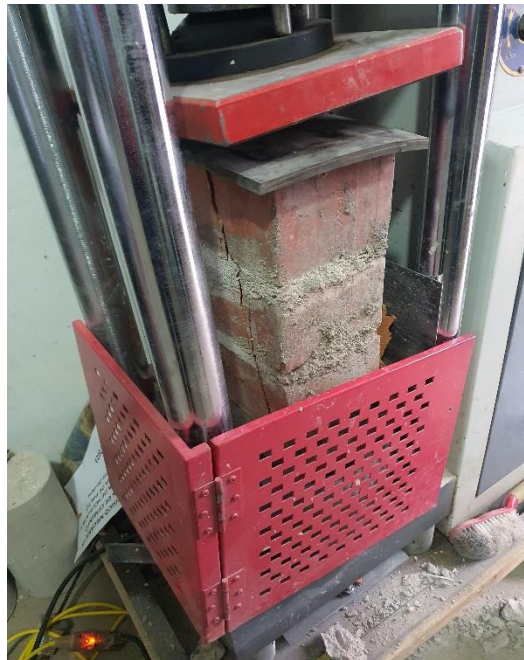
Figura 19. Falla de la pila de ladrillo
