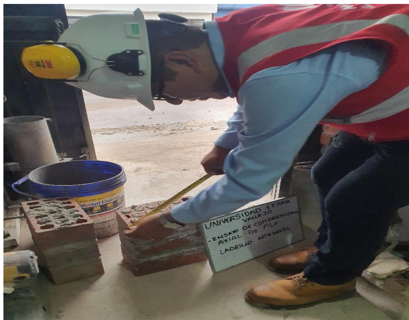
Figura 36. Medición de la pila de albañilería para ensayar.
