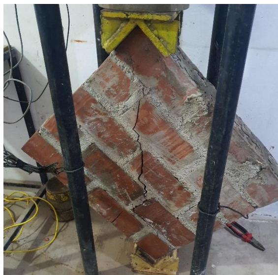
Figura 20. Falla del murete de ladrillo
