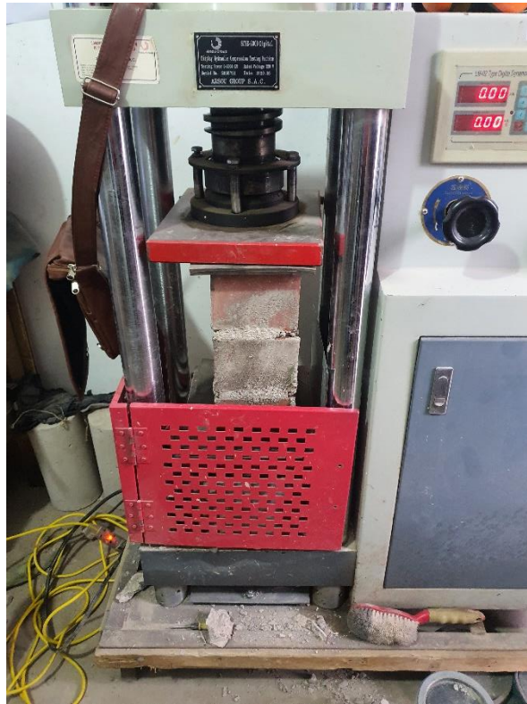
Figúra 41. Ensayo de pila de albañilería de ladrillo artesanal
