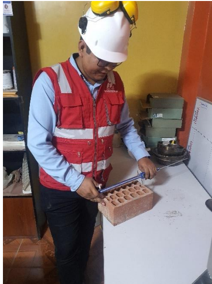
Figura 11. Medición del largo de la unidad de albañilería.
