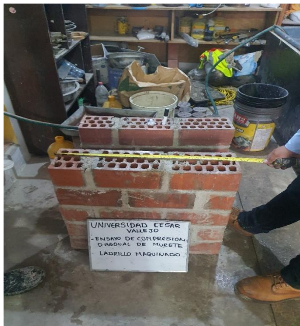
Figura 33. Ensayo de compresión diagonal de murete
