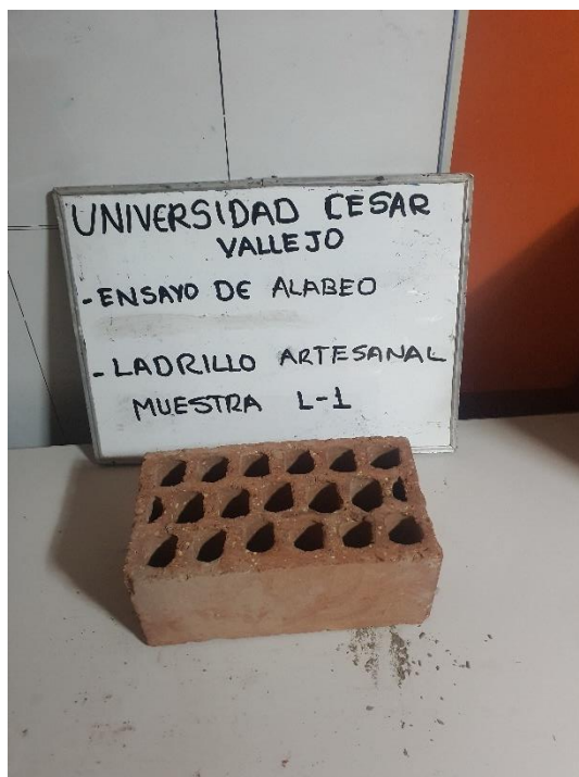
Figura 12. Muestra de ladrillo artesanal para ensayo de alabeo.
