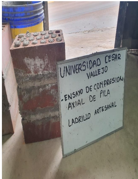
Figura 37. Pila de albañilería lista para ser ensayada
