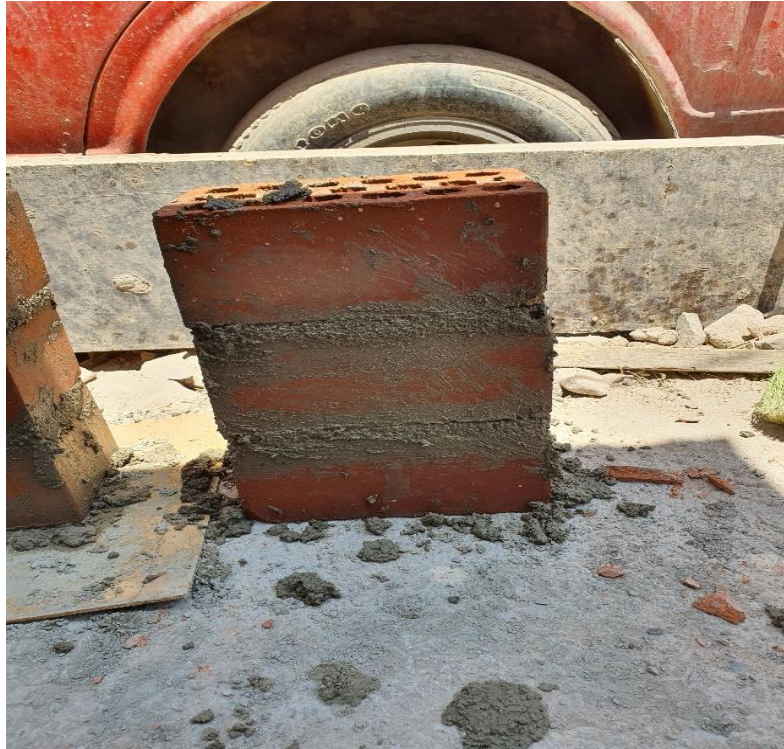
Figura 29. Pila de ladrillo terminada de asentar esperando su secado
