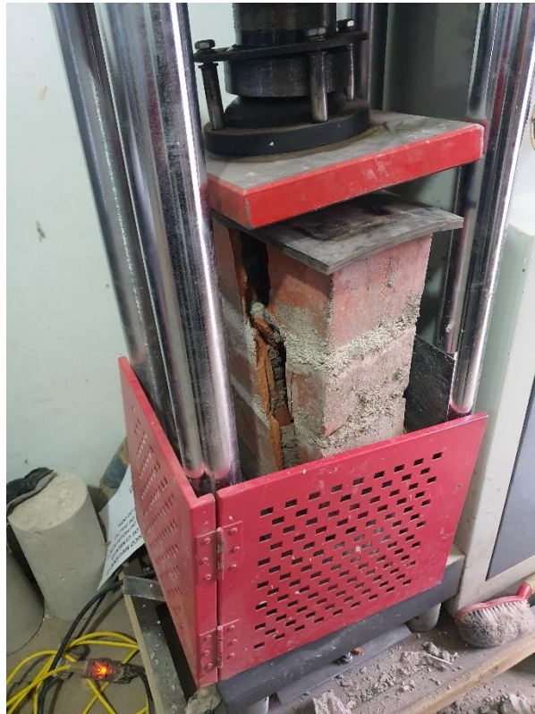
Figura 39. Falla de la pila de albañilería
