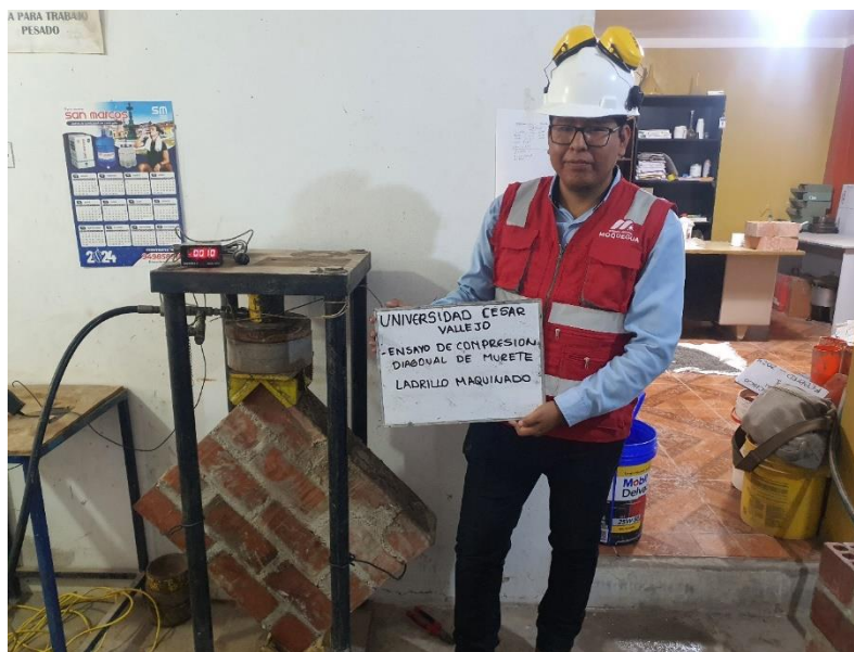
Figura 38. Ensayo de compresión diagonal de murete de ladrillo artesanal
