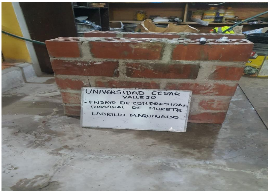
Figura 28. Murete listo para ser llevado al ensayo de compresión diagonal
