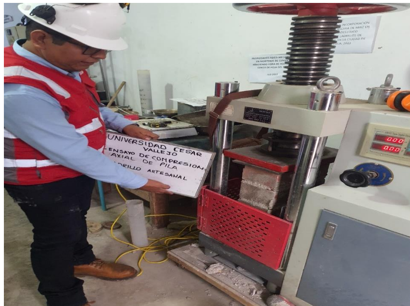
Figura 40. Ensayo de pila de albañilería
