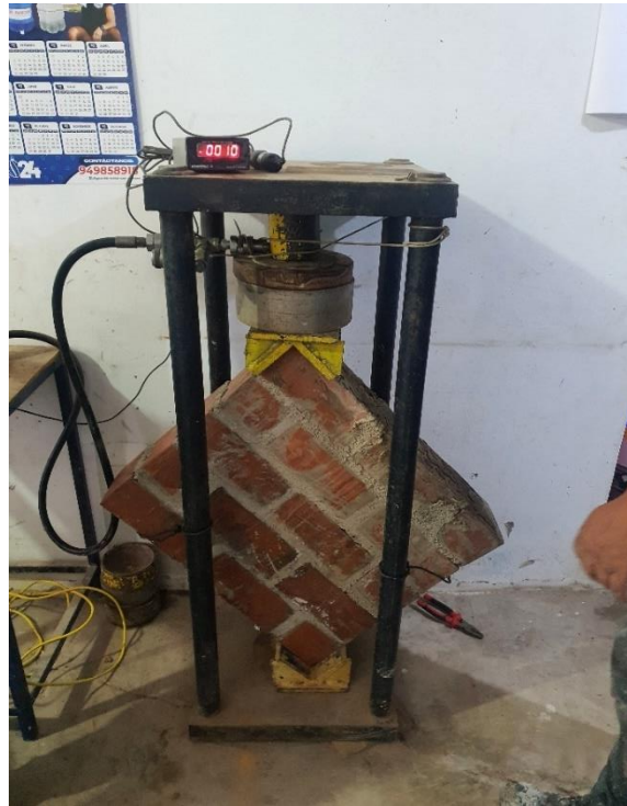
Figura 33. Ensayo de compresión diagonal de murete
