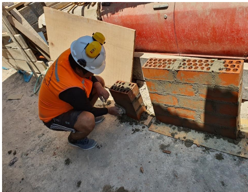
Figúra 26. Asentado de pila de ladrillo para ensayo de compresión de pila
