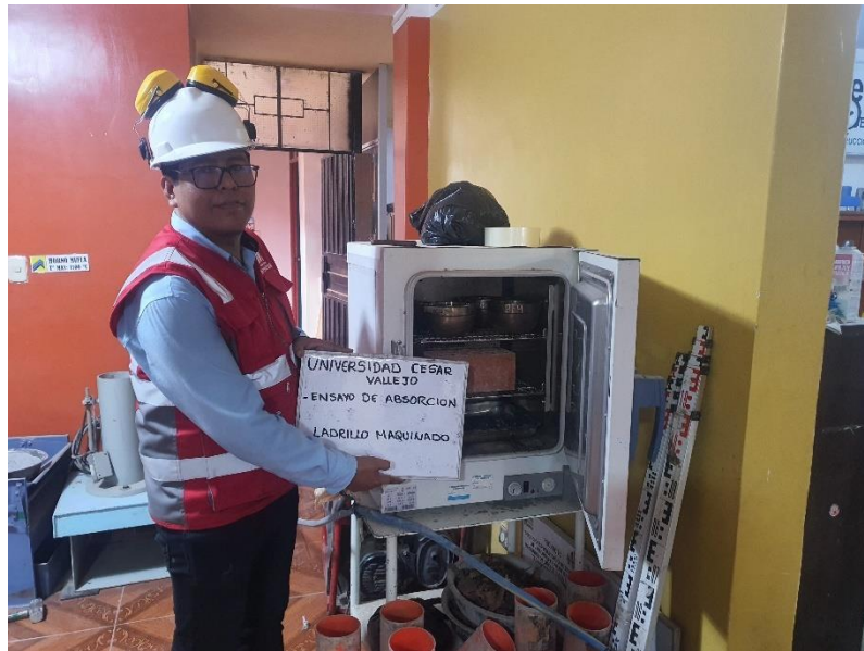
Figúra 13. Colocación de unidad de albañilería al horno por 24 horas.
