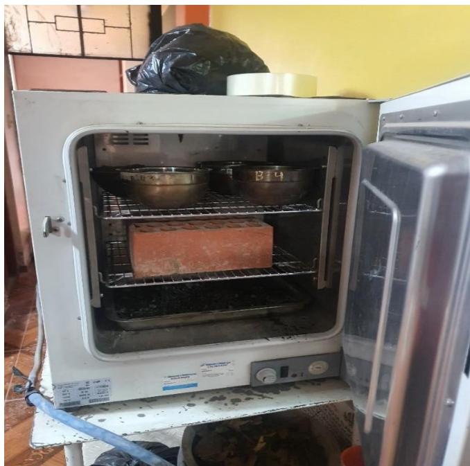
Figúra 32. Ladrillo puesto en horno para el ensayo de absorción
