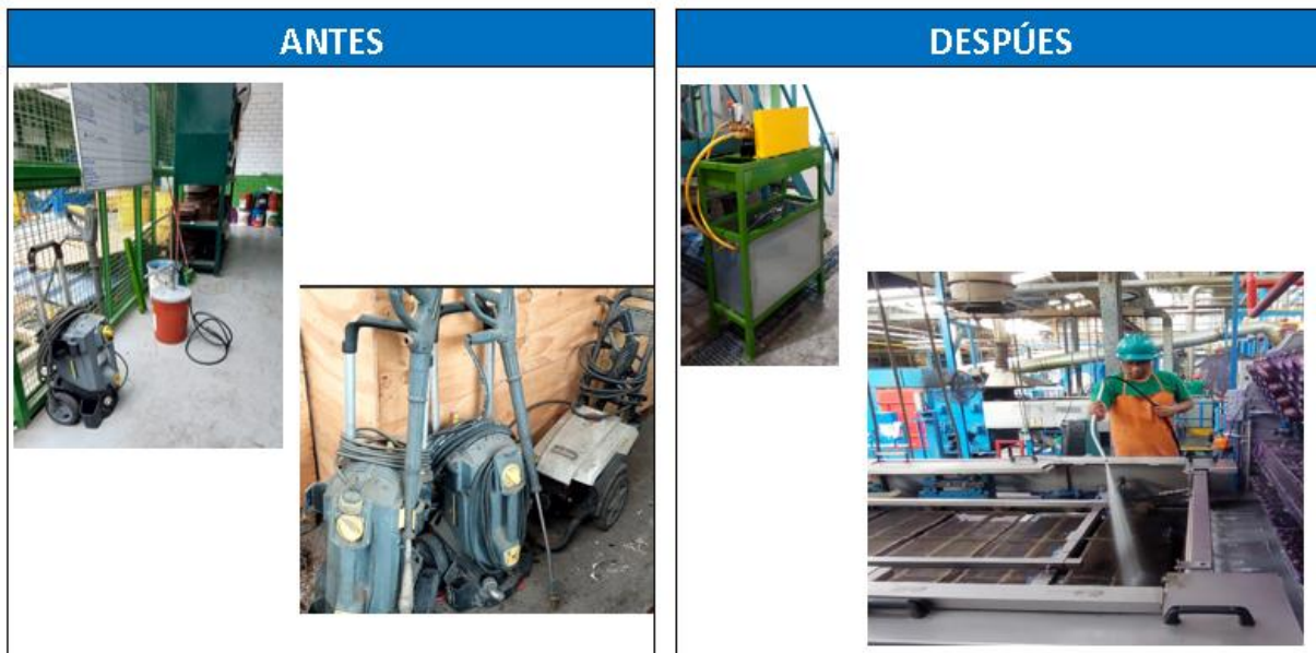
Figura 46. Lavado parrillas con hidro lavadora
