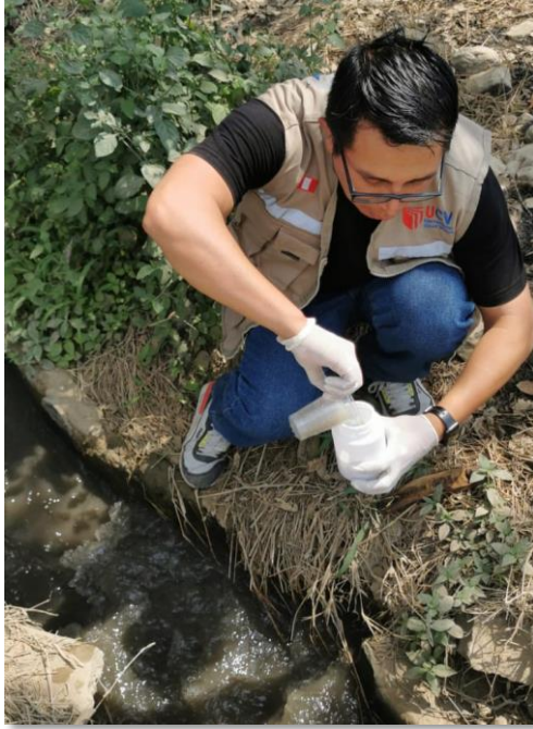
Figura 20. Tomando muestra microbiológica
