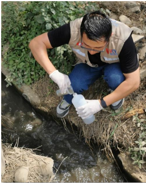
Figura 21. Tomando muestra de metales pesados
