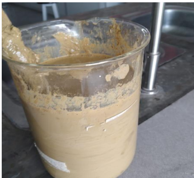
Figura 13. Proceso de lavado con agua destilada
