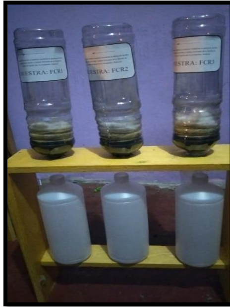
Filtro C(15g. de arcilla + 15g. de carbón activado de semilla de aguaje)
