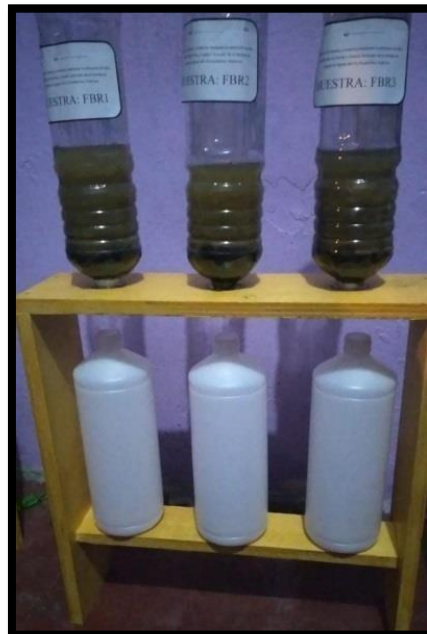
Filtro B (20g. de arcilla + 10g. de carbón activado de semilla de aguaje)
