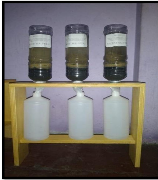
Filtro E (5g. de arcilla + 25g. de carbón activado de semilla de aguaje)
