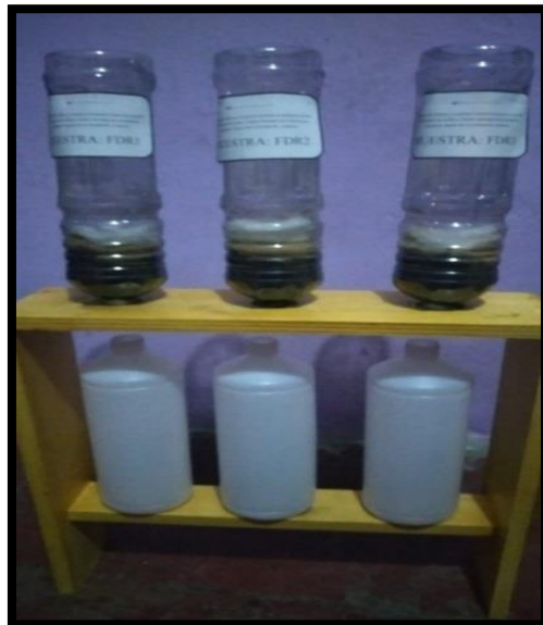
Filtro D (10g. de arcilla + 20g. de carbón activado de semilla de aguaje)
