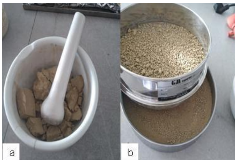
Figura 12. Triturado (a) y tamizado (b) de la arcilla
