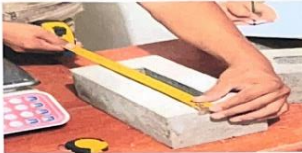
Figura 4. Medición de forma convexa del ladrillo
