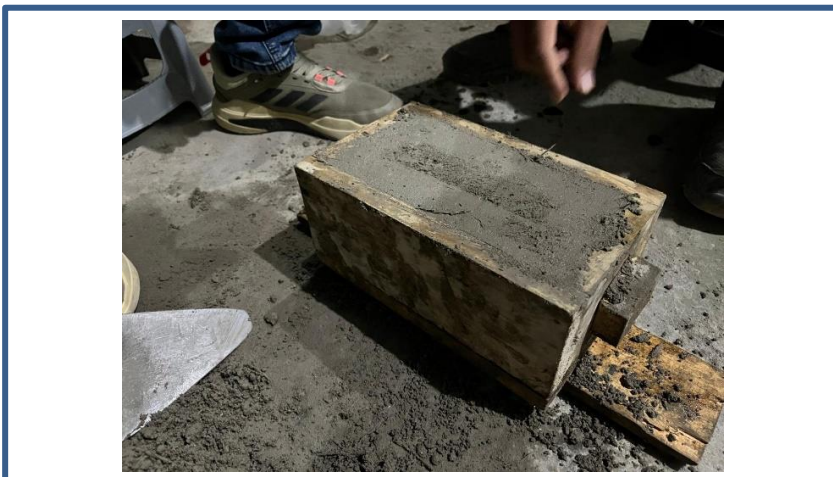
Fotografía 12. Molde lleno de la mezcla listo para ser desmontado
