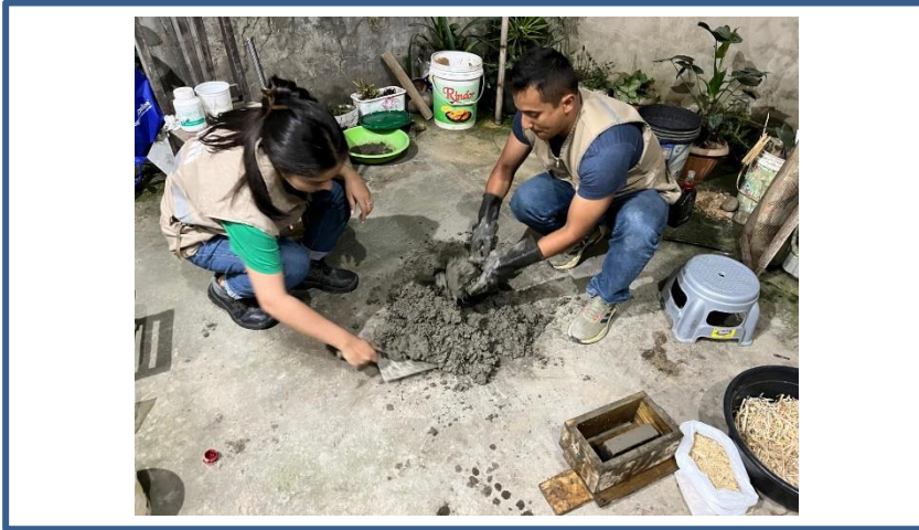
Fotografía 10. Realizando la mezcla de cemento, arena, fibras de bagazo de caña de azúcar y agua.
