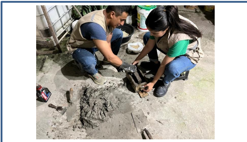
Fotografía 11. Colocación de la mezcla al molde
