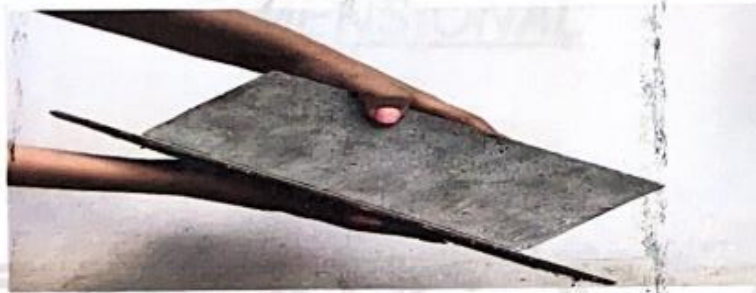
Figura 3. Medición de forma convexa del ladrillo
