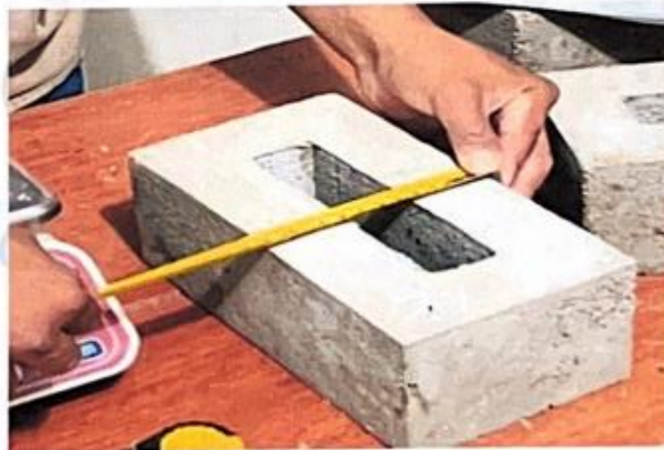
Figura 3. Medición del ancho del ladrillo
