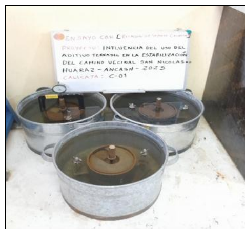
Imagen 2. Saturación y expansión de muestras CBR
