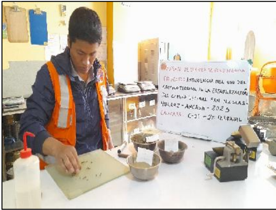
Imagen 1. Ensayo de límites de consistencia
