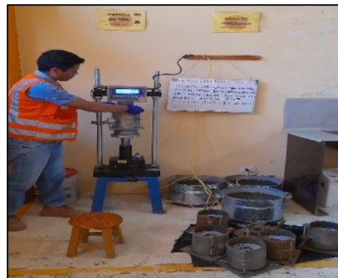
Imagen 2. Saturación y expansión de muestras CBR
