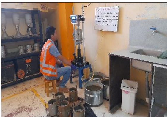
Imagen 3. Ensayo de CBR
