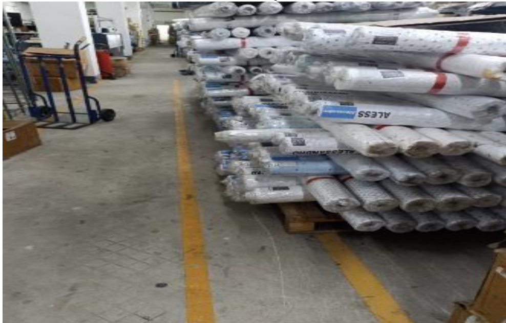
Figura 23. Área de almacén materiales ocupando línea de evacuación
