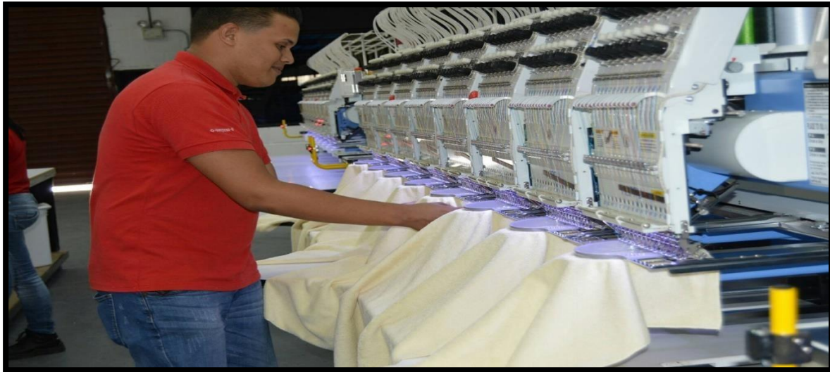
Figura 14. Área de bordado con ausencia de equipos EPP
