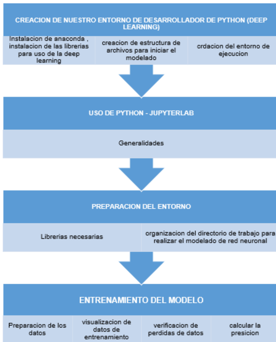
Figura 32. Procedimiento para el Entrenamiento de Red Neuronal Convolucional
