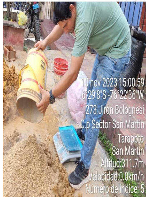
Figura 55: Pesado del material (Cascarilla de café al 10% del óptimo)
