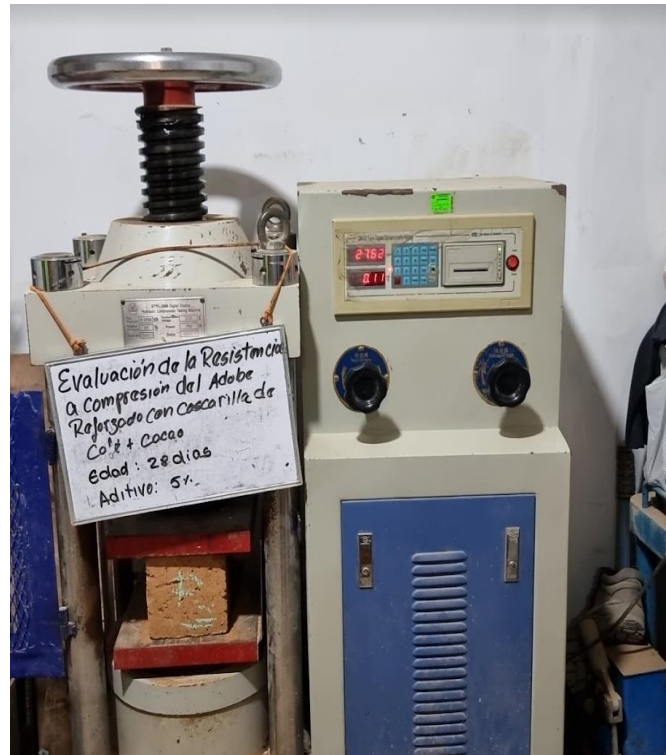
Figura 85: Rotura del adobe al 10% de cascarilla de café más el 5% de ceniza de cascarilla de arroz
