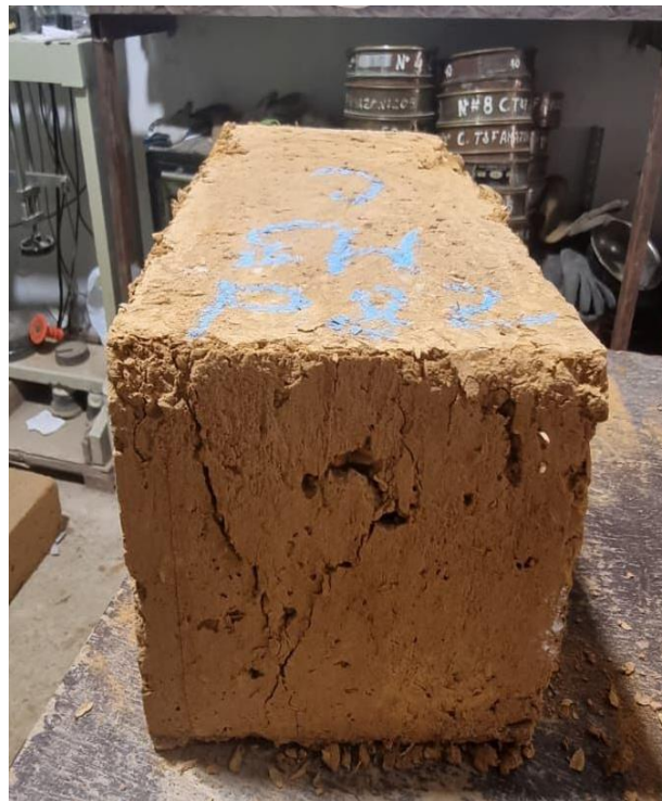
Figura 52: Rotura del adobe obtenido en la prensa al 10% de cascarilla de café Fuente: Elaboración propia.
