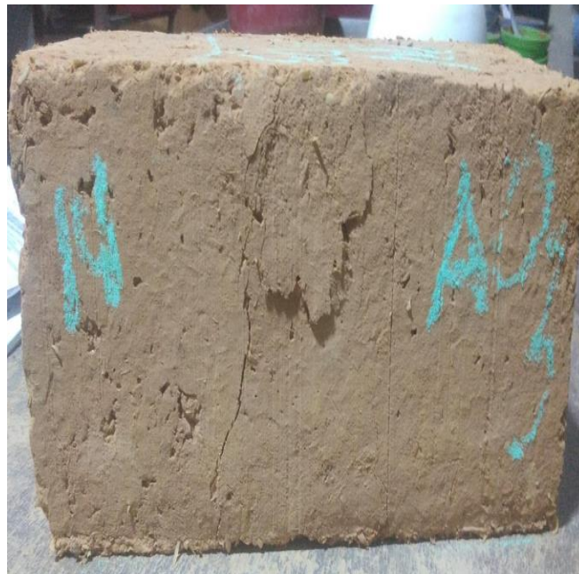
Figura 70: Rotura del adobe al 10% de cascarilla de café más el 15% de ceniza de cascarilla de arroz
