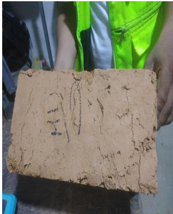
Figura 30: Rotura del adobe obtenido en la prensa al 5% de cascarilla de café Fuente: Elaboración propia.
