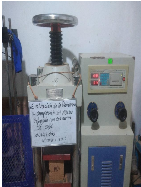
Figura 29: Rotura del adobe al 5% de cascarilla de café Fuente: Elaboración propia.
