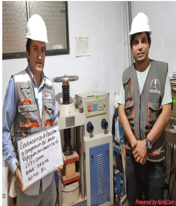
Figura 93: Rotura del adobe al 10% de cascarilla de café más el 15% de ceniza de cascarilla de arroz
