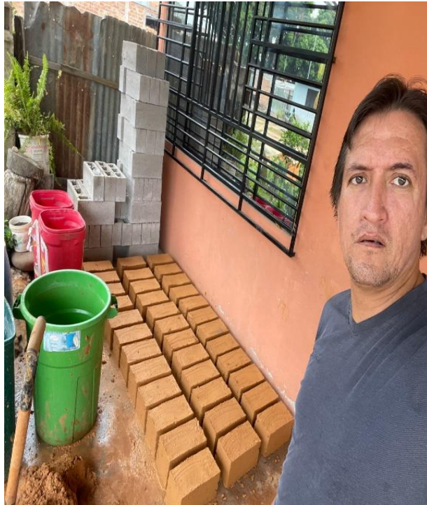
Figura 23: Adobes elaborados con cascarilla de café Fuente: Elaboración propia.
