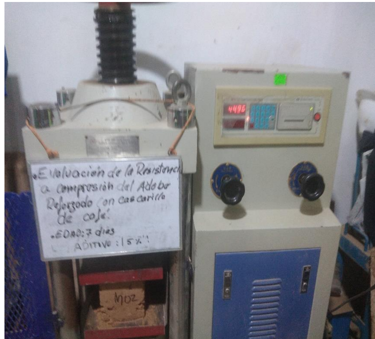
Figura 33: Rotura del adobe al 15% de cascarilla de café
