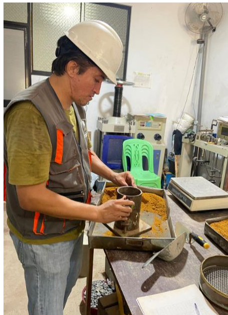
Figura 14: Se introduce el disco espaciador sobre la base perforada y sobre este un papel filtro. Fuente: Elaboración propia.
