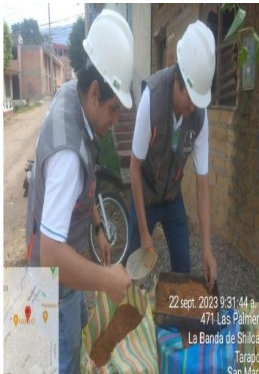
Figura 02: Tamizado del material de arcilla
