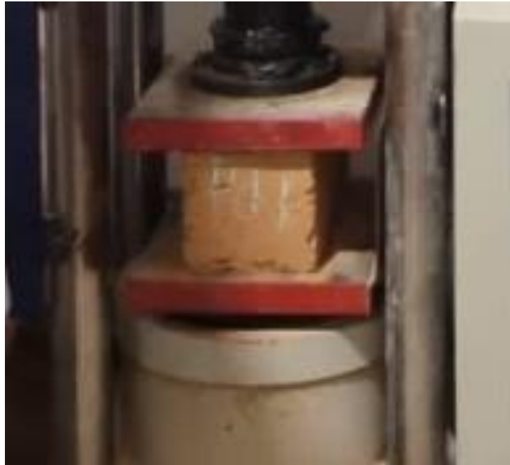
Figura 89: Rotura del adobe al 10% de cascarilla de café más el 10% de ceniza de cascarilla de arroz
