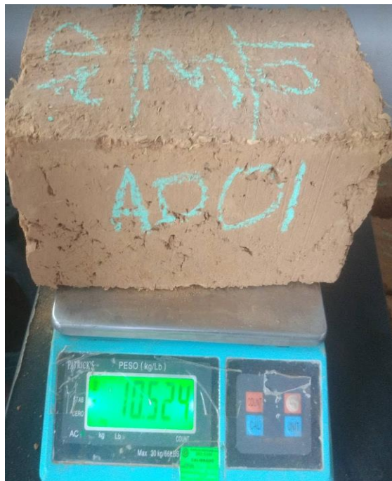
Figura 68: Pesado de los adobes. Fuente: Elaboración propia.
