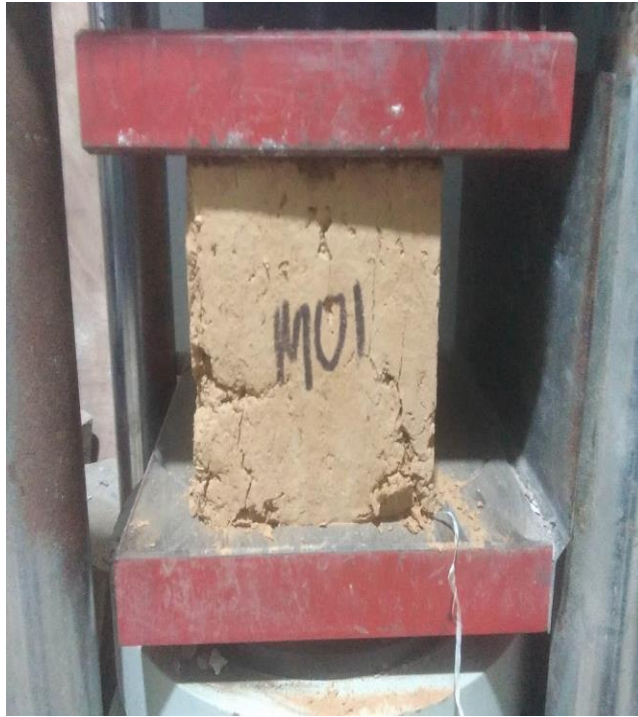
Figura 65: Rotura del adobe al 10% de cascarilla de café más el 10% de ceniza de cascarilla de arroz
