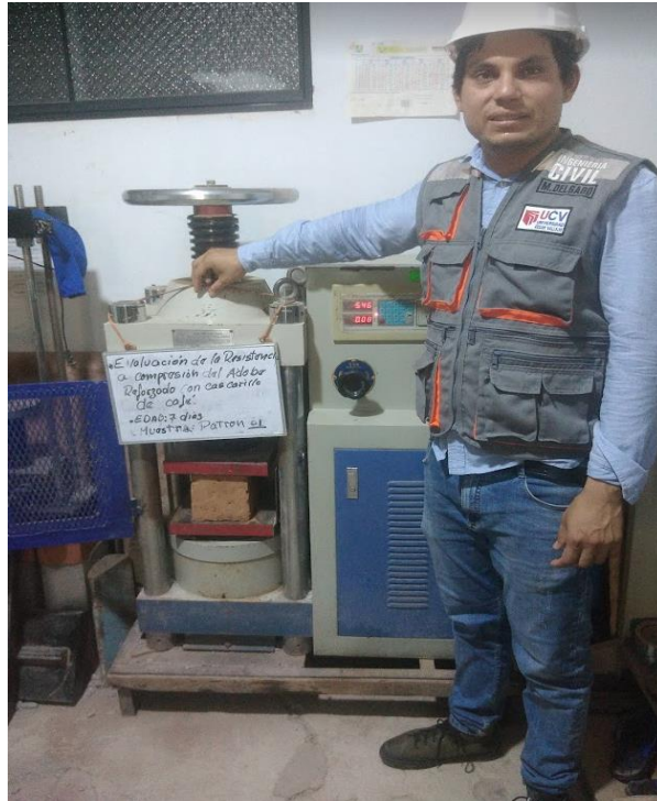
Figura 73: Rotura del adobe al 10% de cascarilla de café más el 5% de ceniza de cascarilla de arroz
