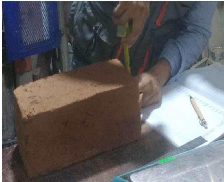
Figura 83: Medición de los adobes
