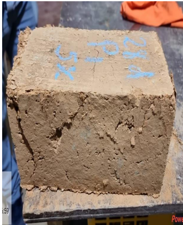
Figura 48: Rotura del adobe obtenido en la prensa. Fuente: Elaboración propia.
