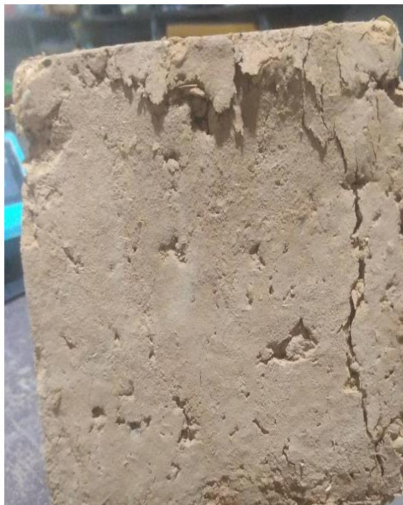
Figura 82: Rotura del adobe al 10% de cascarilla de café más el 15% de ceniza de cascarilla de arroz
