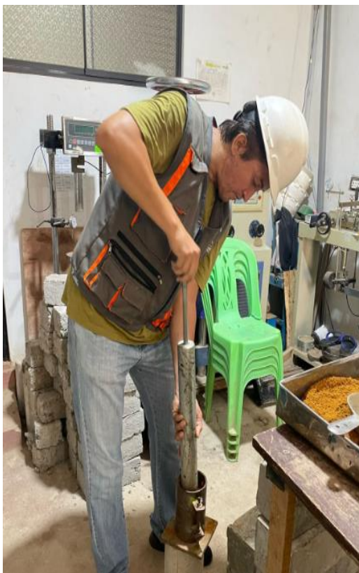
Figura 15: Etapa de compactación
