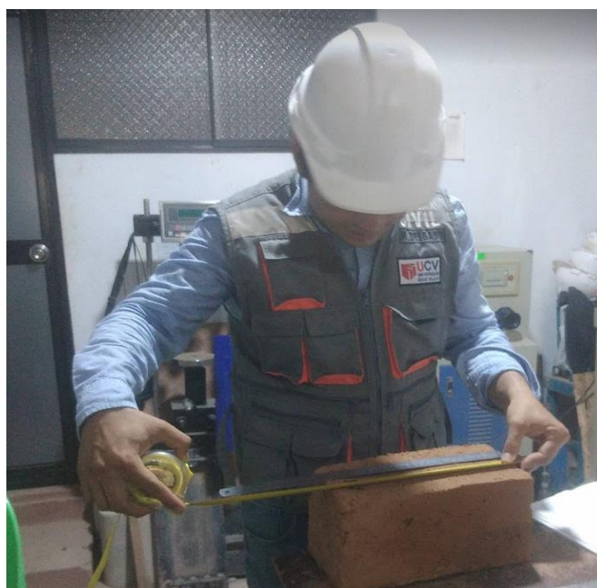
Figura 36: Medición del largo y ancho del adobe
