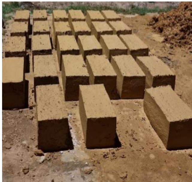
Figura 58: Adobes elaborados con cascarilla de café (10%) más ceniza de cascarilla de arroz (5%,10%,15%)
