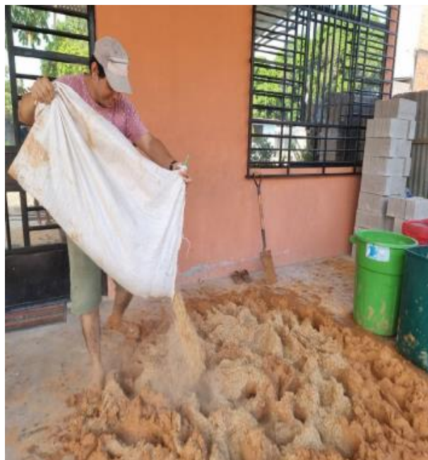
Figura 22: Mezclado de los materiales (Arcilla más cascarilla de café)
