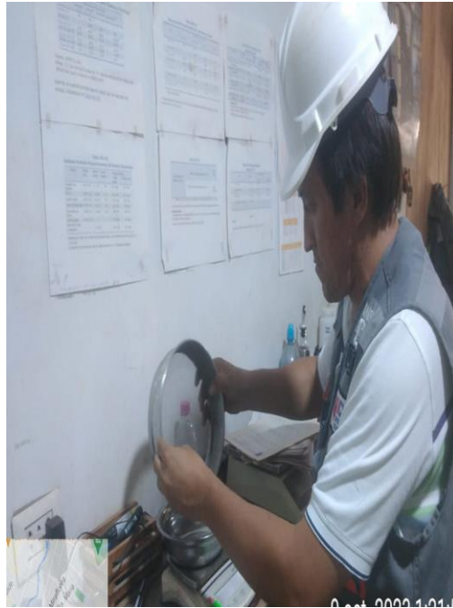
Figura 05: procedimiento de mezcla de la muestra con Agua para Humedecerla.
