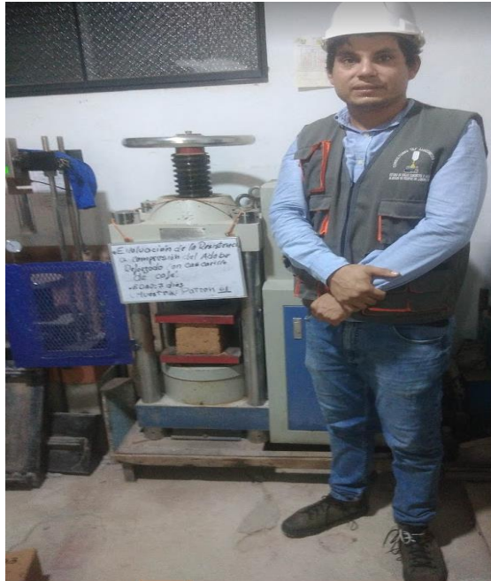
Figura 31: Rotura del adobe al 10% de cascarilla de café
