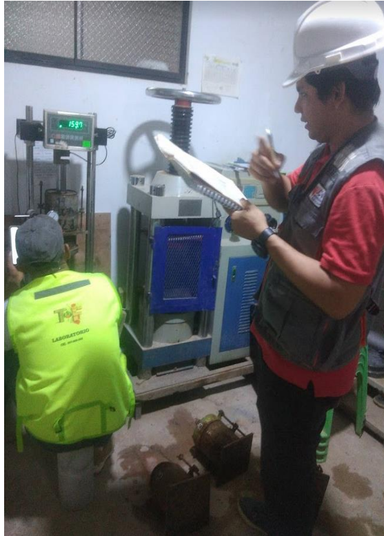
Figura 19: Se aplica la carga sobre el pistón de penetración mediante la prensa CBR y posteriormente se toman las lecturas de la curva presión penetración. Fuente: Elaboración propia.
