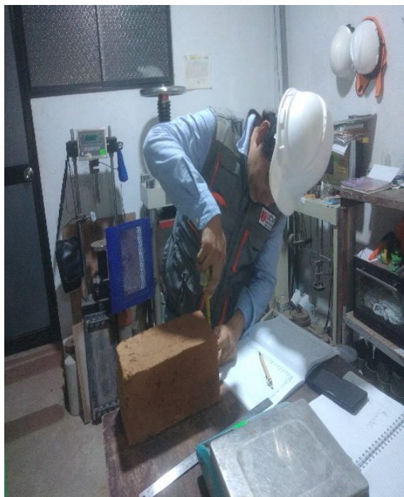
Figura 46: Medición del lao y ancho del adobe
