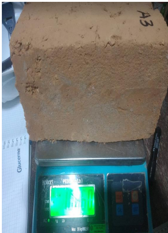
Figura 76: Pesado de los adobes. Fuente: Elaboración propia.
