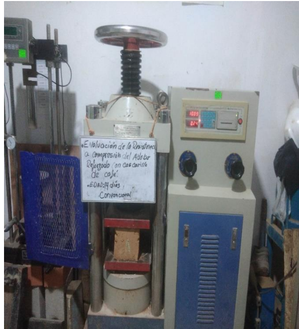
Figura 37: Rotura del adobe convencional
