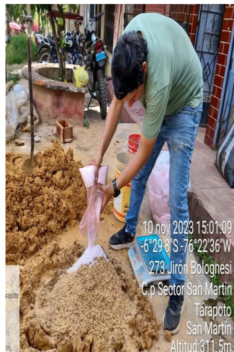
Figura 56: Incorporación de la cecina de cascarilla de arroz con la Arcilla más cascarilla de café
