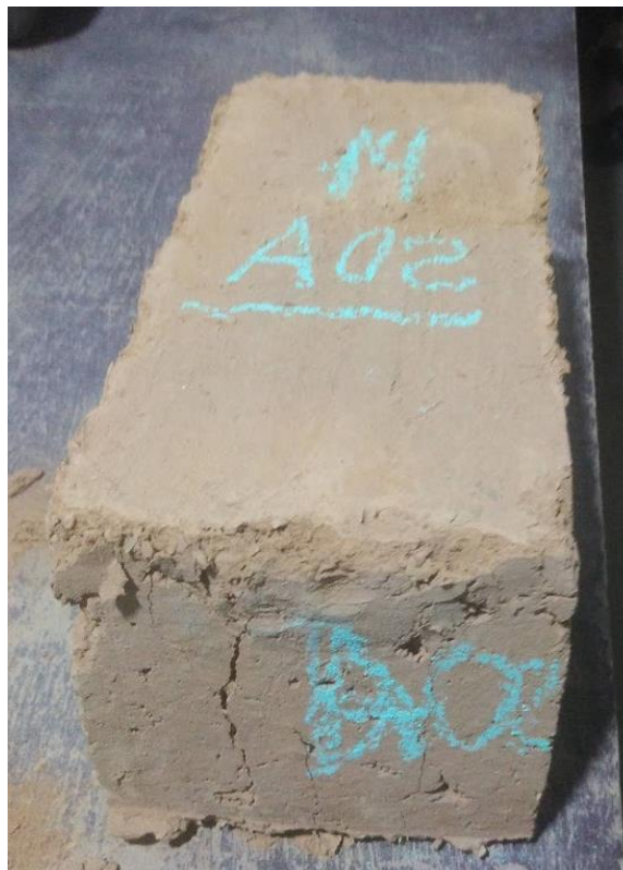
Figura 42: Rotura del adobe obtenido en la prensa al 10% de cascarilla de café Fuente: Elaboración propia.
