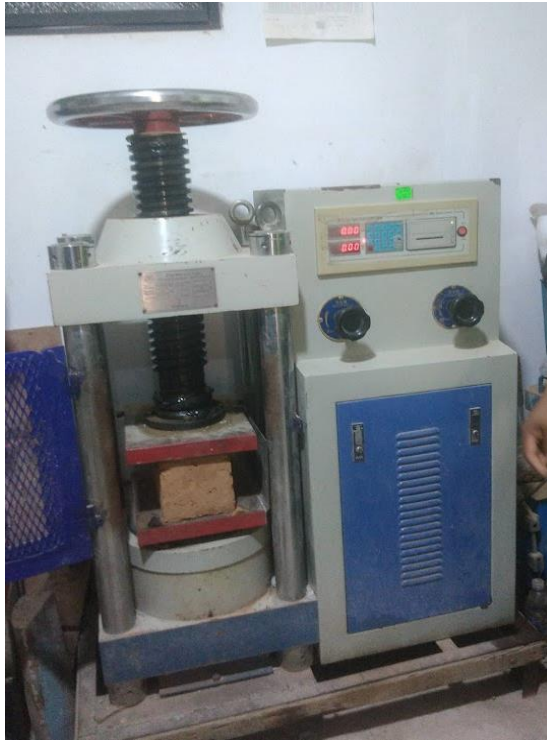
Figura 81: Rotura del adobe al 10% de cascarilla de café más el 15% de ceniza de cascarilla de arroz
