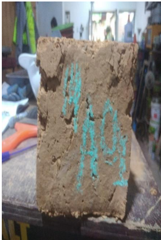
Figura 38: Rotura del adobe obtenido en la prensa.
