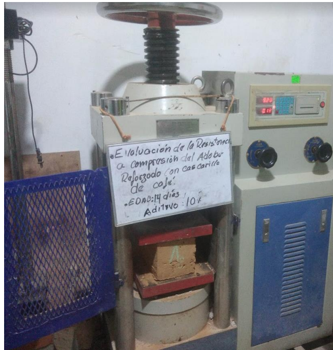
Figura 41: Rotura del adobe al 10% de cascarilla de café Fuente: Elaboración propia.
