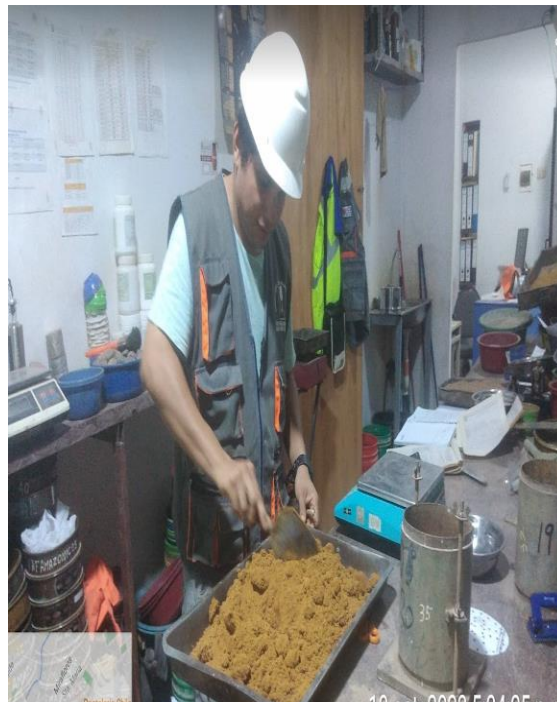
Figura 06: Procedimiento de dividir la muestra Arcilla en capas.
