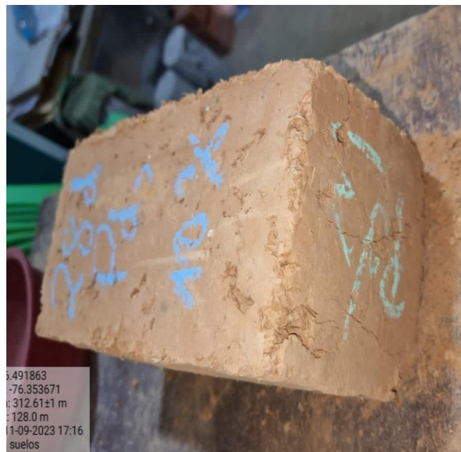
Figura 50: Rotura del adobe obtenido en la prensa al 5% de cascarilla de café Fuente: Elaboración propia.
