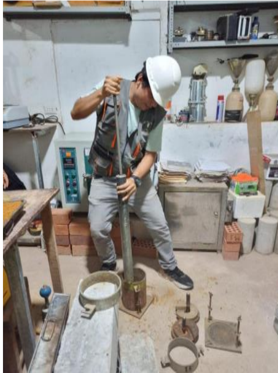
Figura 07: Procedimiento de compactar cada capa.
