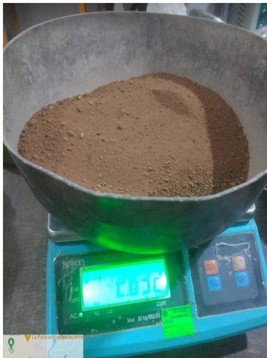
Figura 12: Pesado de la muestra seca.
