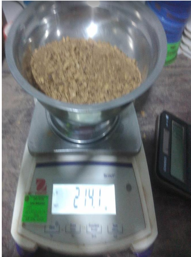
Figura 21: Pesado del material (Cascarilla de café)
