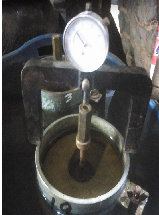
Figura 17: Se sumergen los moldes en agua y se toma de medidas diarias (3 días)
