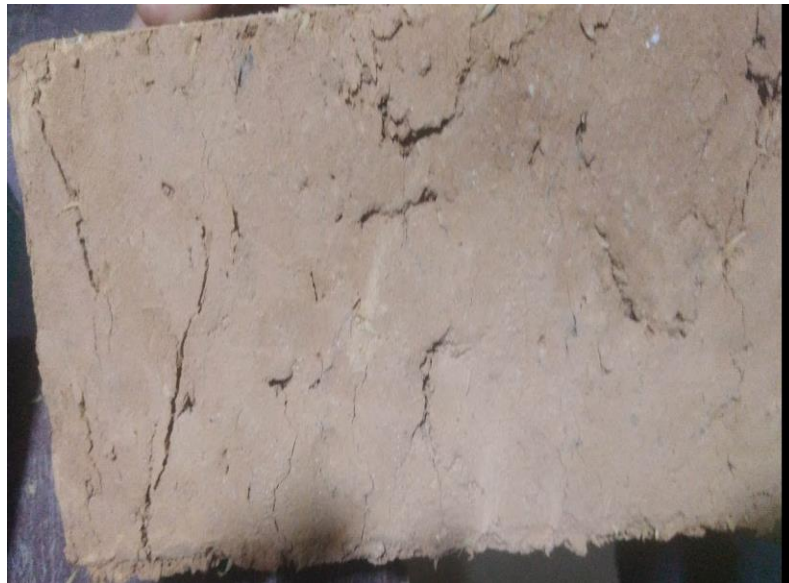
Figura 78: Rotura del adobe al 10% de cascarilla de café más el 10% de ceniza de cascarilla de arroz
