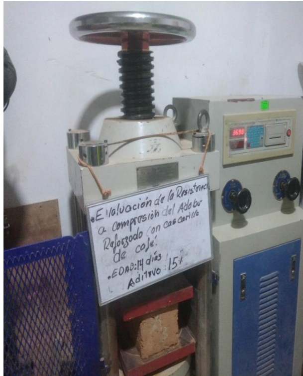
Figura 43: Rotura del adobe obtenido en la prensa al 15% de cascarilla de café Fuente: Elaboración propia.
