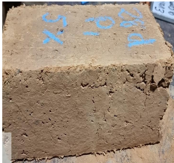
Figura 86: Rotura del adobe al 10% de cascarilla de café más el 5% de ceniza de cascarilla de arroz
