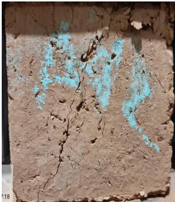
Figura 74: Rotura del adobe al 10% de cascarilla de café más el 5% de ceniza de cascarilla de arroz
