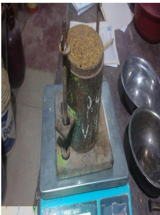
Figura 16: Peso del molde más el suelo compactado
