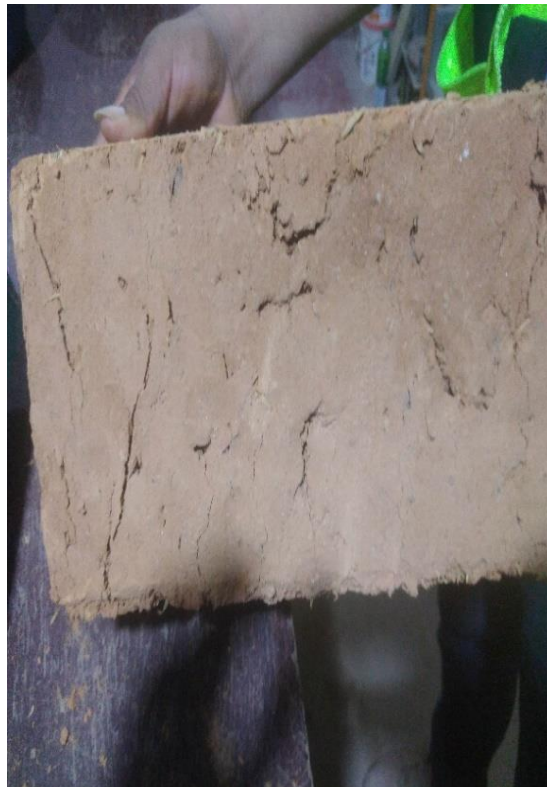
Figura 32: Rotura del adobe obtenido en la prensa al 10% de cascarilla de café
