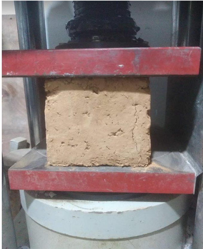
Figura 49: Rotura del adobe al 5% de cascarilla de café Fuente: Elaboración propia.
