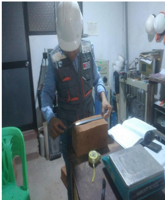
Figura 26: Medición del largo y ancho del adobe
