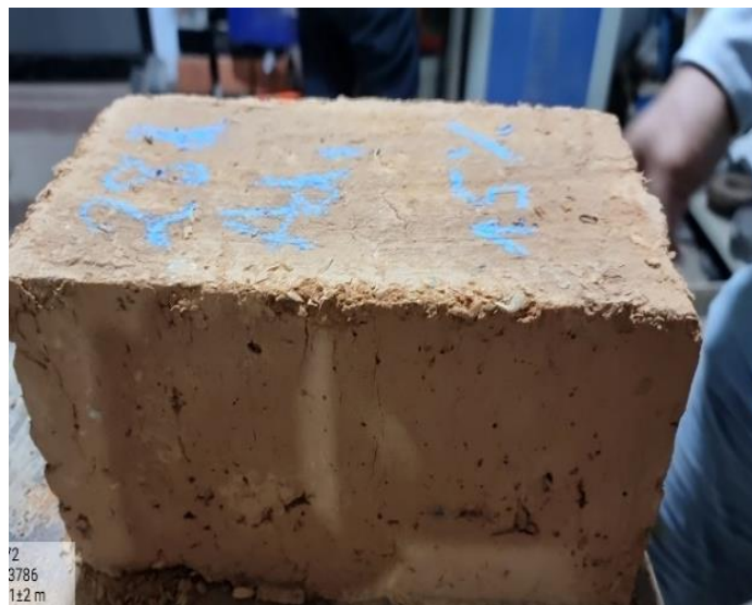
Figura 94: Rotura del adobe al 10% de cascarilla de café más el 15% de ceniza de cascarilla de arroz
