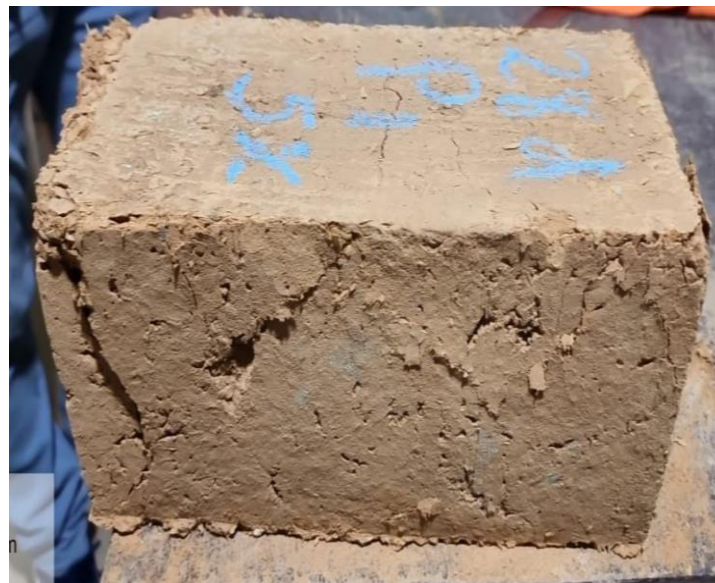
Figura 54: Rotura del adobe obtenido en la prensa al 15% de cascarilla de café Fuente: Elaboración propia.
