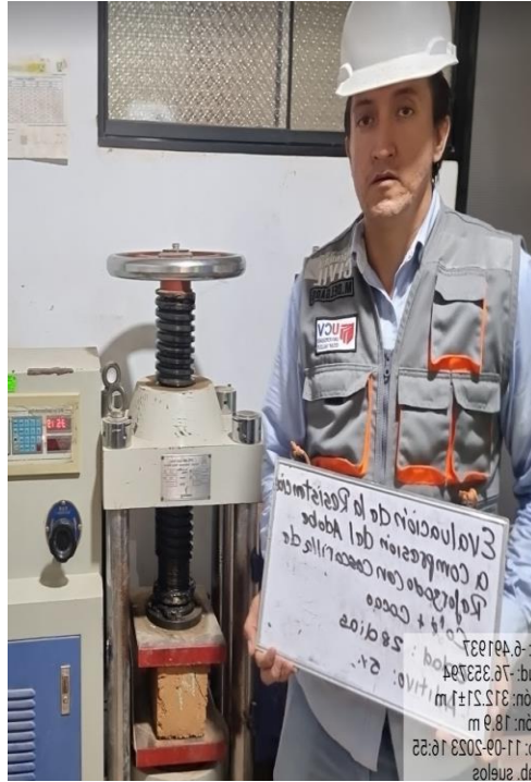
Figura 77: Rotura del adobe al 10% de cascarilla de café más el 10% de ceniza de cascarilla de arroz
