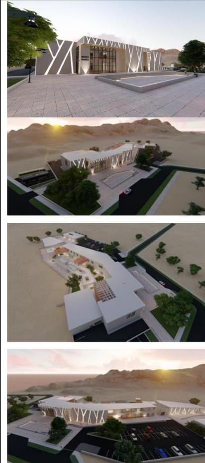
La materialidad del Museo Interactivo, se basa en el uso de concreto expuesto, muro pantalla y madera como elementos principales de diseño. La fachada estará revestida con un encofrado especial de madera, con relieves que simulan árboles. En el interior, se emplearán porcelanas, celosías y acero para barandas y escaleras. Los techos serán losas nervadas de concreto expuesto para mantener espacios libres de elementos verticales y dar un acabado limpio y singular a los ambientes del museo.
