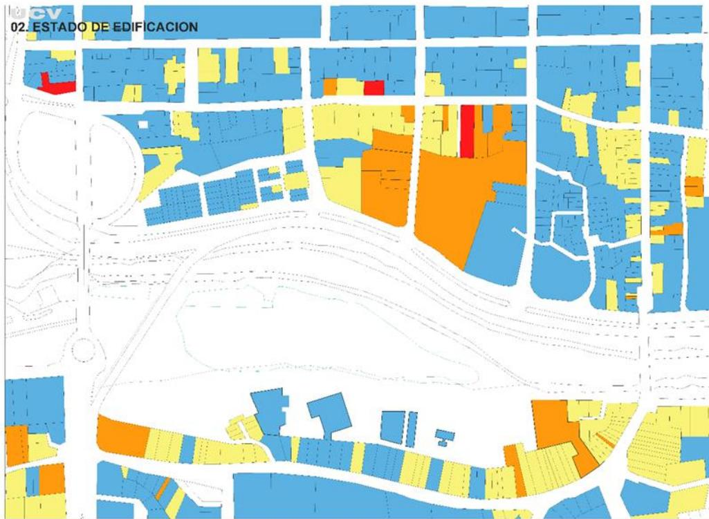
**Figura 94.** Plano de campo específico de estado de conservación de la edificación
