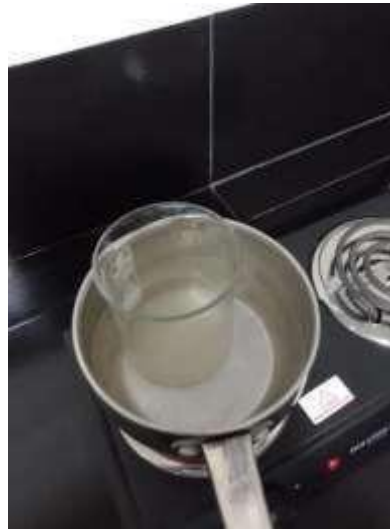
Foto: baño maría con 50% de agua, azúcar y ácido cítrico a más de 70 °C
