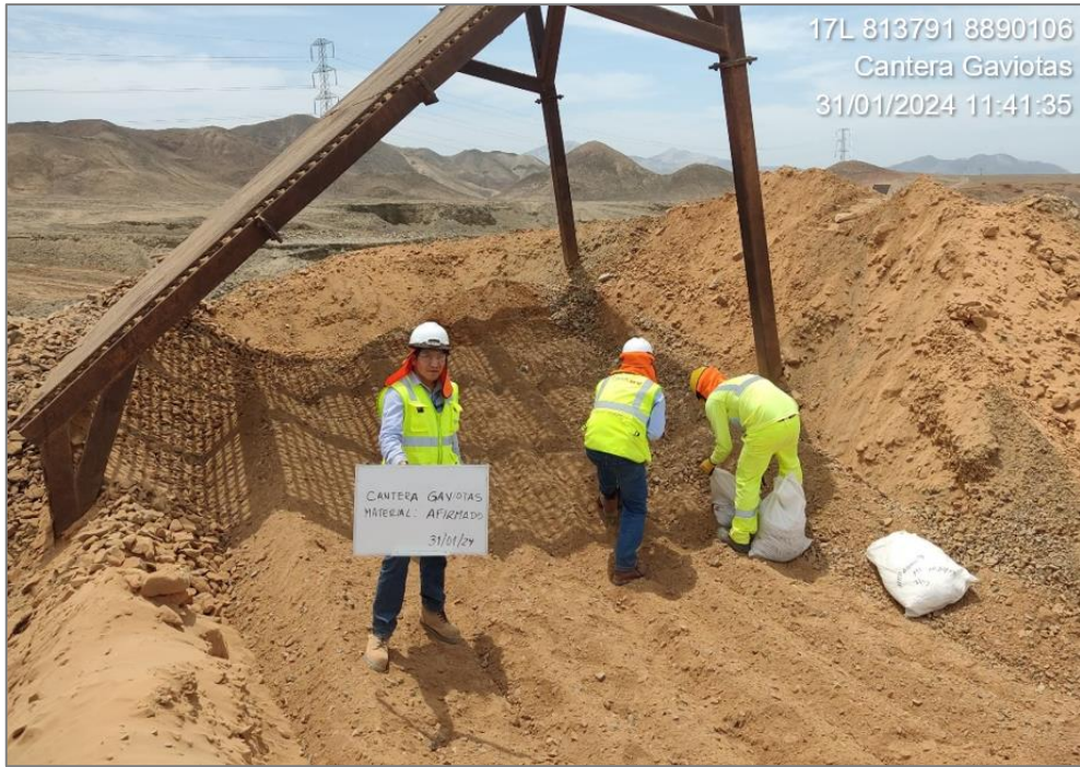
Fotografía 3. Toma de muestra de Material Granular zarandeado en Cantera Gaviotas
