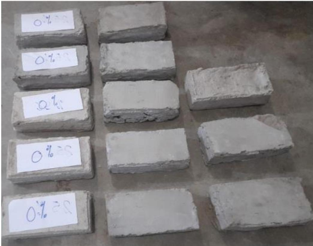
Elaboración del Adoquín con el 25% de concreto reciclado
