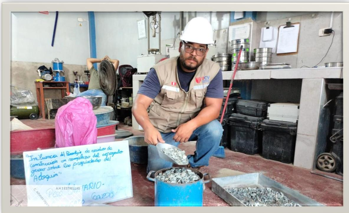
Figura 09: Peso específico y la absorción del agregado (arena gruesa y fina)
