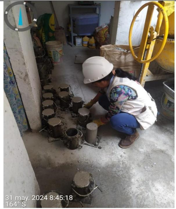
Fotografía 10. Desencofrado de probetas
