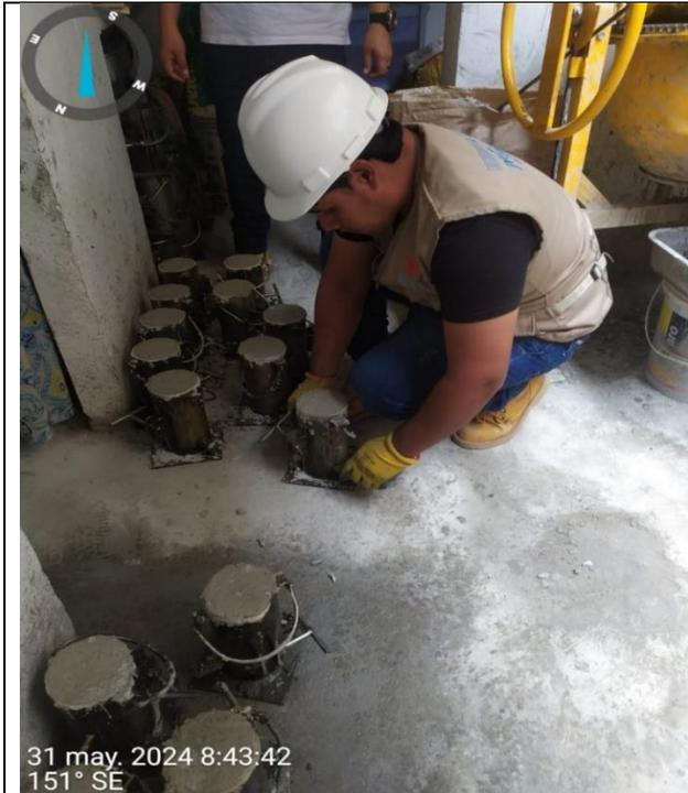
Fotografía 09. Elaboración de probetas
