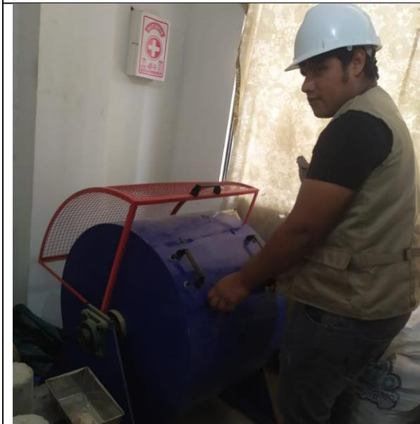
Fotografía 19. Máquina de los ángeles usada para abrasión de agregados grueso
