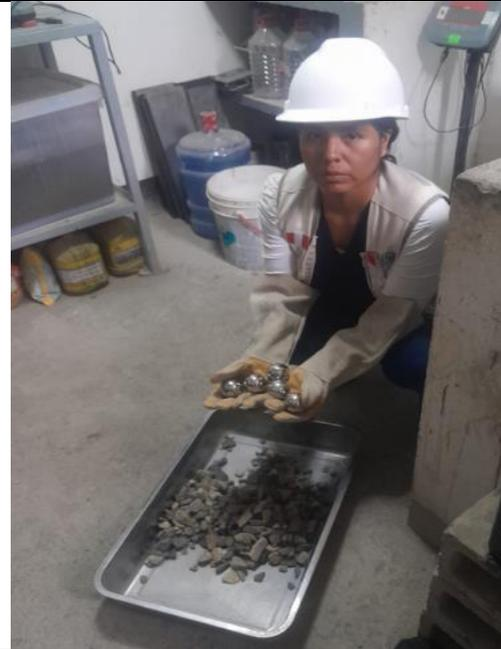
Fotografía 18. Material y uso de esferas para ensayo de abrasión
