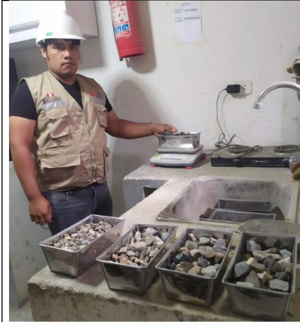
Fotografía 17. Lavado de agregado grueso para ensayo de abrasión
