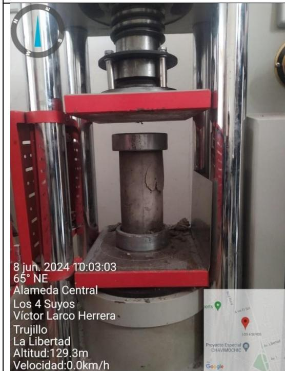
Fotografía 15. Fisura de probetas
