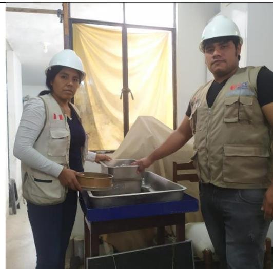
Fotografía 20. Tamizado de agregados después de pasar por máquina los ángeles
