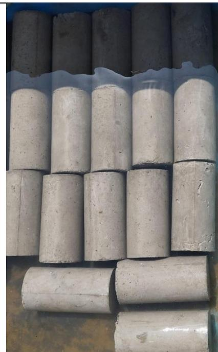
Fotografía 12. Curado de probetas
