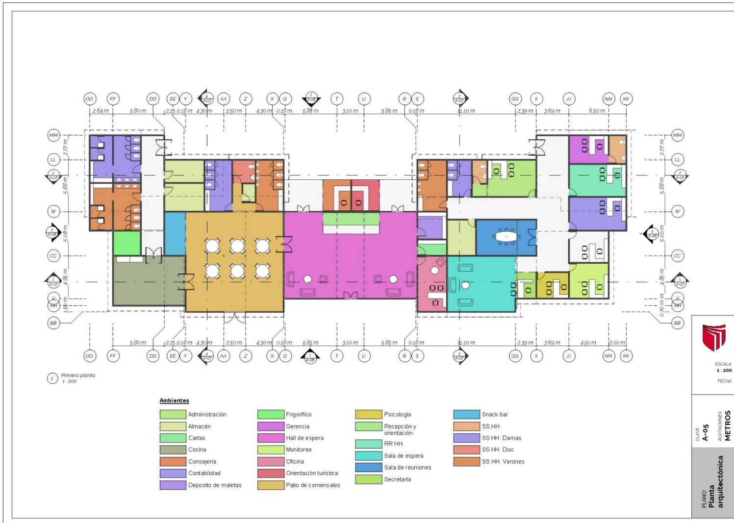
Figura 24. Planta arquitectónica recepción y administración
