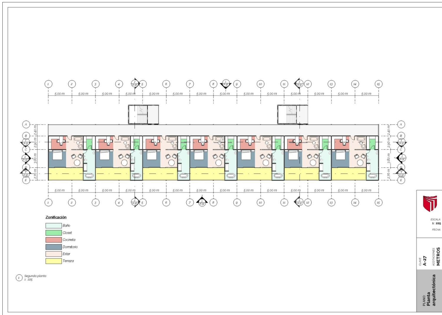
Figura 46. Planta arquitectónica hotel hab. Suites (segunda planta)
