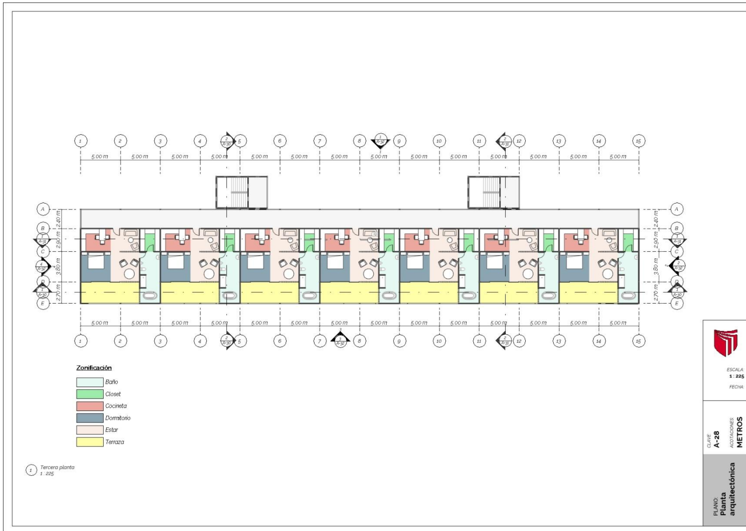
Figura 47. Planta arquitectónica hotel hab. Suites (tercera planta)
