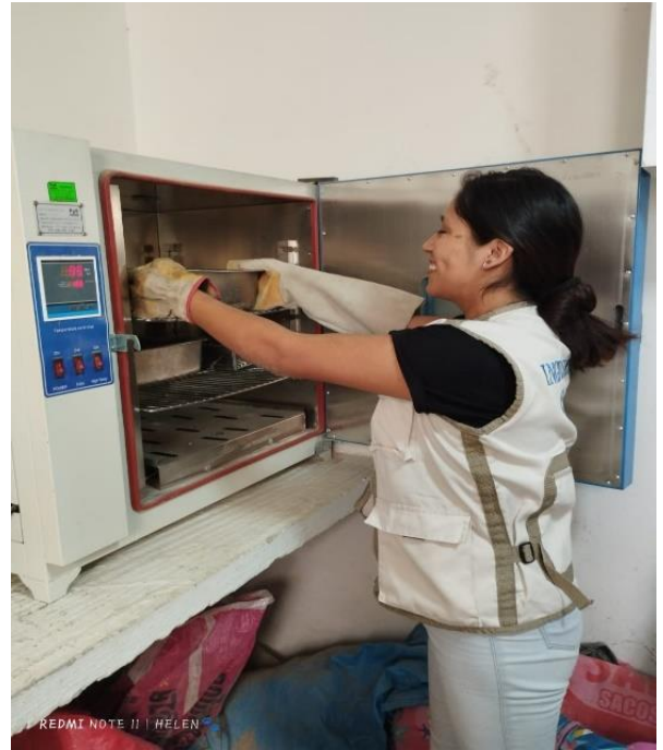
Secado del agregado grueso en el horno a una temperatura de 110°C por 24 horas.
