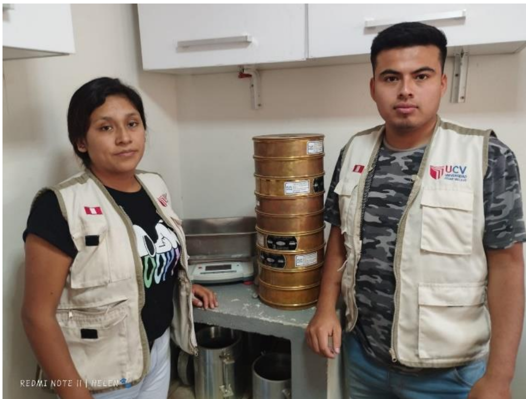
Organización de los tamices según su tamaño de abertura, en este proyecto se utilizó las mallas de: 4", 3 1/2", 3", 2 1/2", 2", 1 1/2", 1", 3/4", 1/2", 3/8", N°4, N°8, N°16, Plato.
