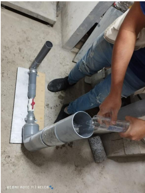
Colocación del espécimen de concreto en el permeámetro y ajuste con abrazaderas para evitar la filtración de agua. luego se llena completamente el con agua hasta su punto maximo.
