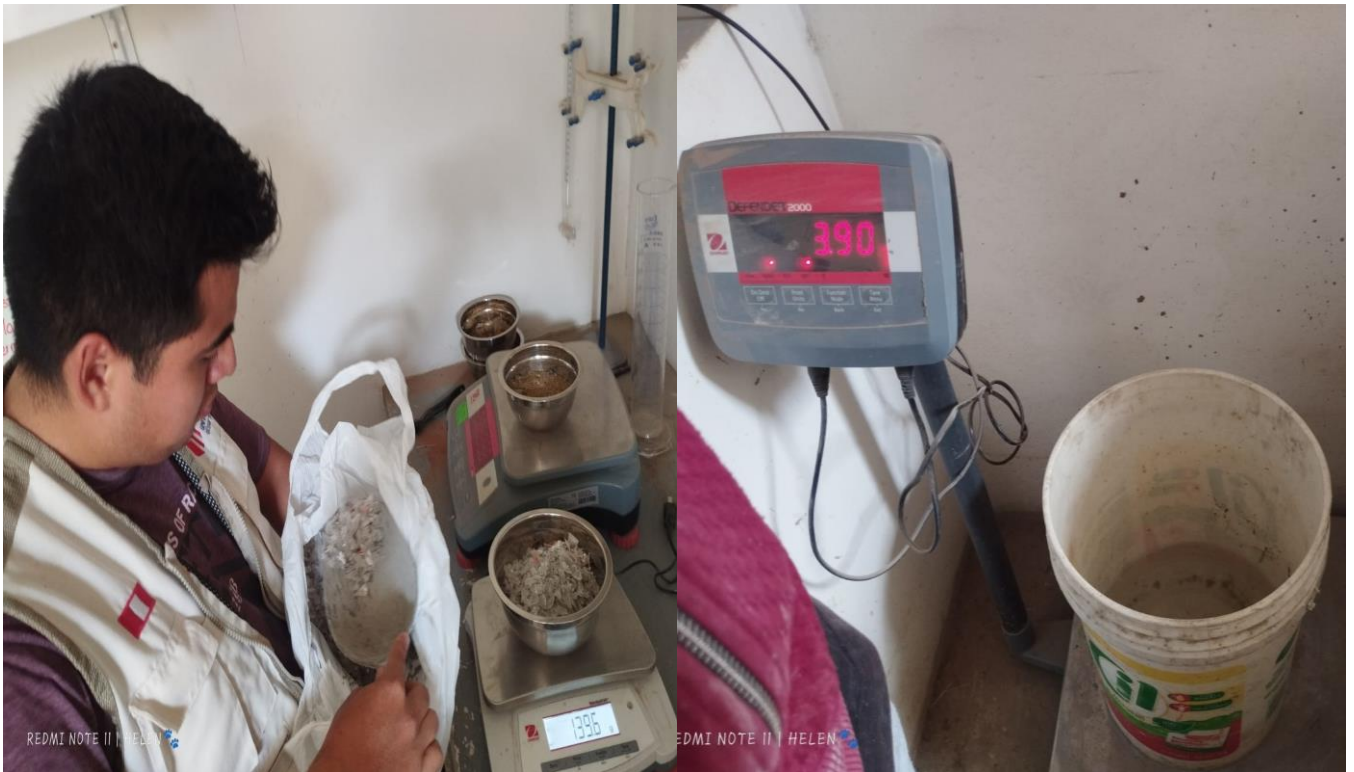
Pesado de plástico y agua. Las cantidades se dieron de acuerdo al diseño de mezcla realizado.
