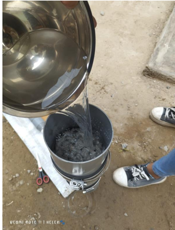
Colocación del espécimen de concreto en el permeámetro y ajuste con abrazaderas para evitar la filtración de agua. luego se llena completamente el con agua hasta su punto maximo.
