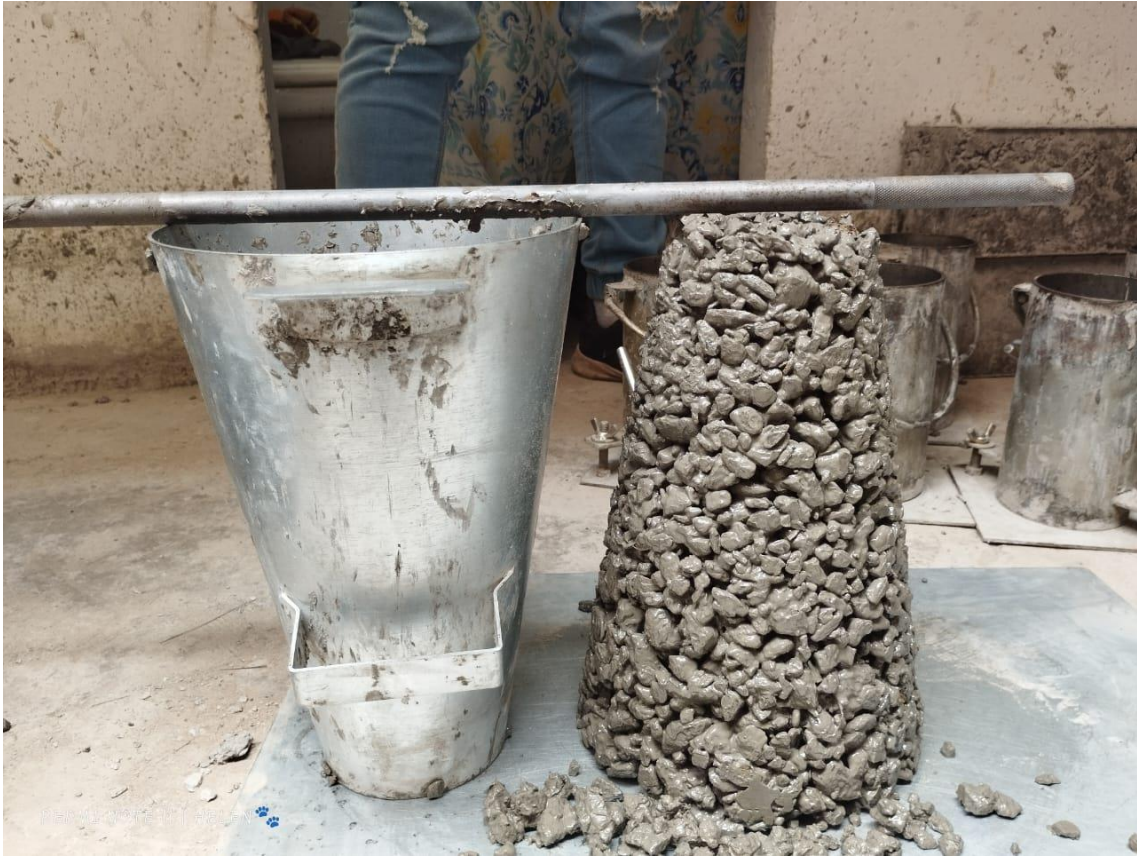
Prueba del Cono de Abrams para saber el asentamiento.
