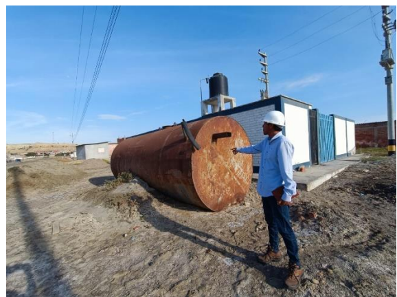
Figura 8: Salinidad y humedad del suelo – Corrosión en tanque libre, coordenadas: 5° 0'23.82"S; 81° 3'47.08"O
