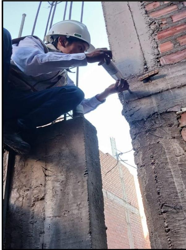
**Figura 29.** Esclerómetro en Viga.
