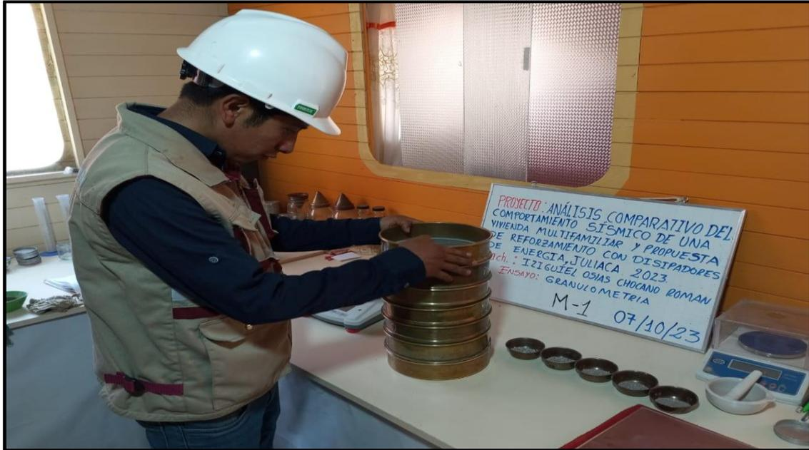
**Figura 23.** Ensayo de Granulometría
