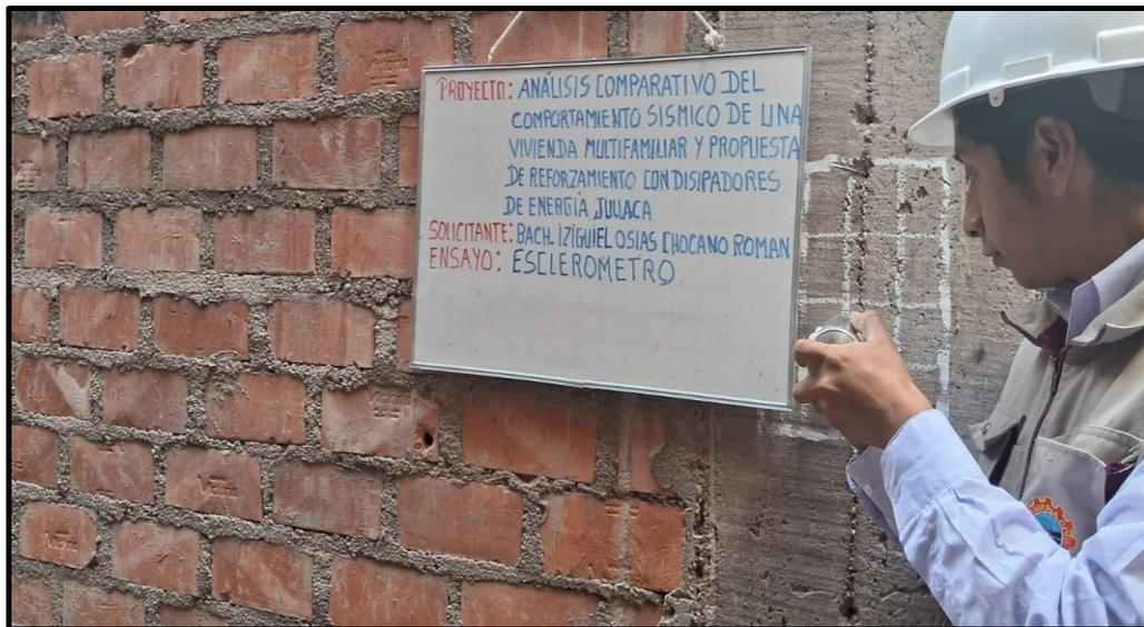
**Figura 30.** Esclerómetro en Columna.
