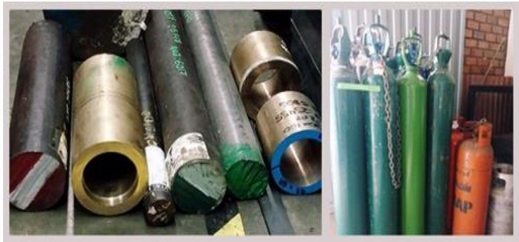
Figura 6. Clasificación de metales según su color de especificación.
