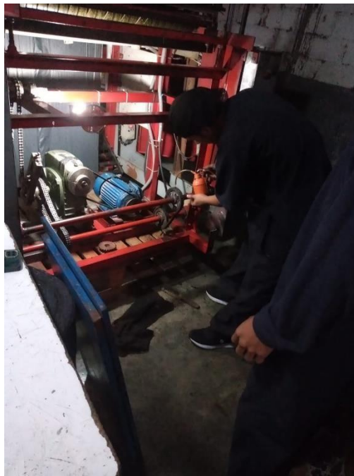
Imagen 7. Enseñando a lubricar las piezas de la maquina selladora de fondo
