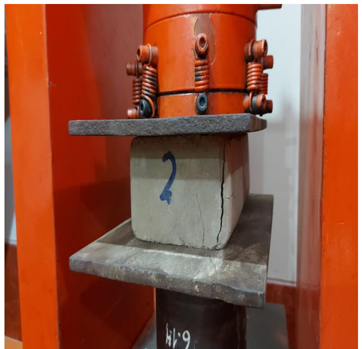
Figura 33: El ladrillo siendo sometido a la compresión.
