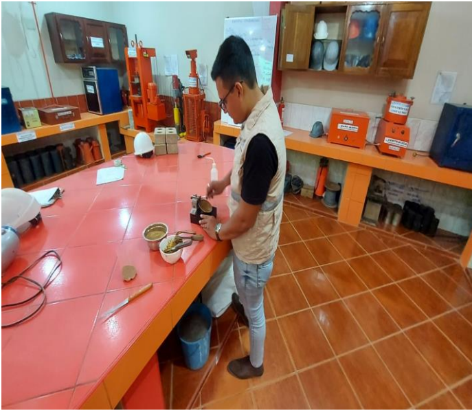
Figura 26: Usando el método del aparato de Casagrande para determinar el límite líquido.
