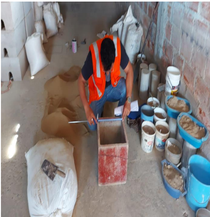
Figura 28: Calculando volumen de recipiente para el ensayo de peso unitario suelto y varillado.
