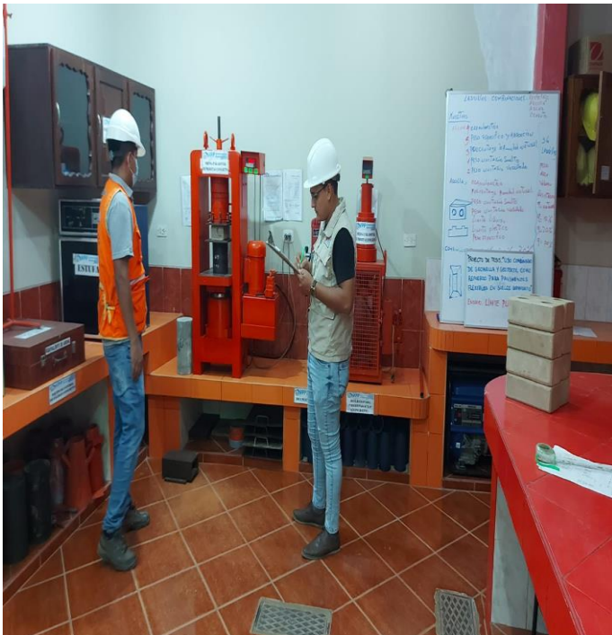
Figura 32: Apuntando los resultados de las resistencias a la compresión de cada ladrillo.
