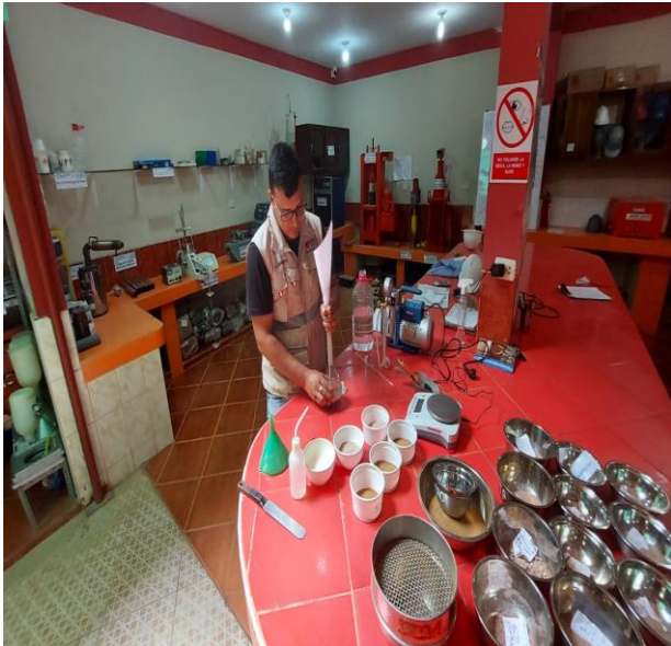
Figura 18: Agregando la muestra a la fiola para el ensayo de peso específico y absorción del agregado fino.
