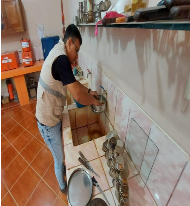
Figura 14: Lavando el agregado fino pasando por el Tamiz N°200 para eliminar los limos y arcillas.
