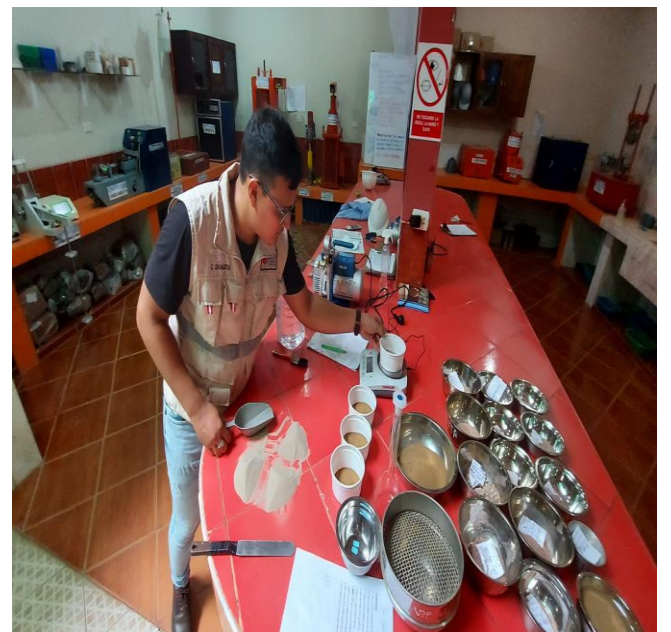
Figura 21: Pesando cada muestra para después ser agregado a la fiola
