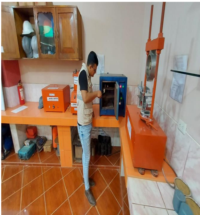
Figura 24: Pasando a la estufa la muestra de los rollitos del ensayo de límite plástico
