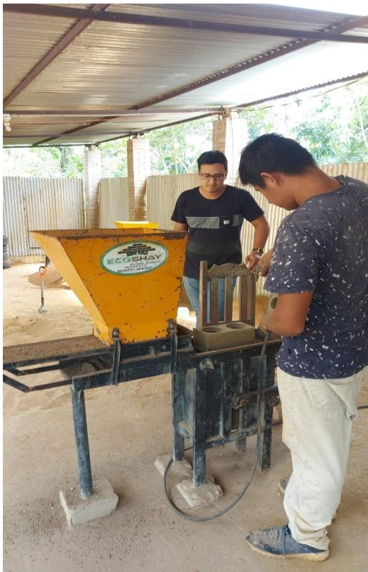
Figura 8: Elaborando los ladrillos ecológicos a compresión en la Ladrillera ecoshay
