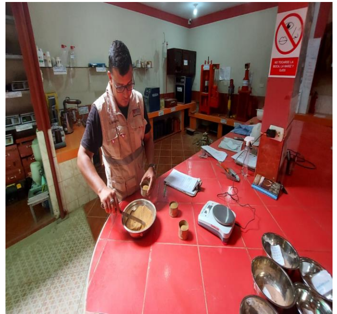
Figura 23: Pesando las muestras para hacer el ensayo del límite plástico
