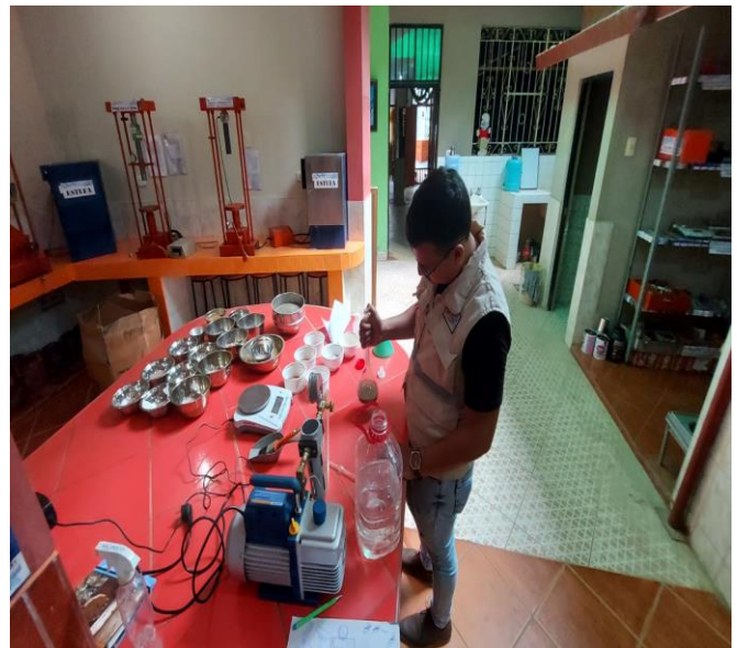
Figura 19: Se agitó la fiola para eliminar las burbujas de aire.
