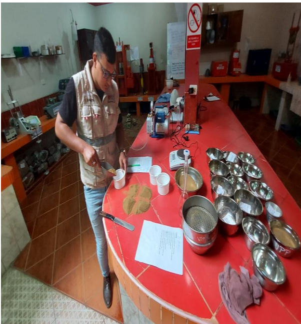
Figura 12: Realizando el ensayo de peso específico y absorción del agregado fino.
