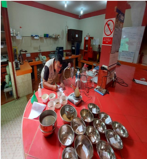
Figura 10: Pesando la fiola con la muestra para obtener resultados del ensayo de peso específico y absorción del agregado fino.
