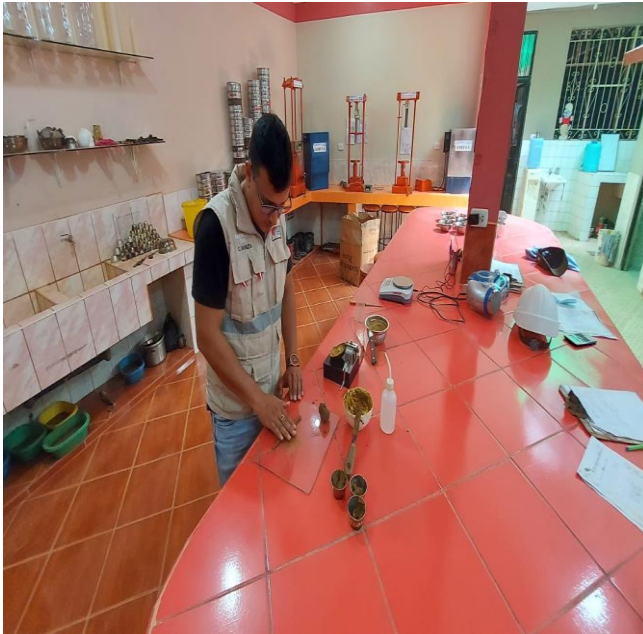
Figura 22: Realizando los rollitos para ensayo del límite plástico.
