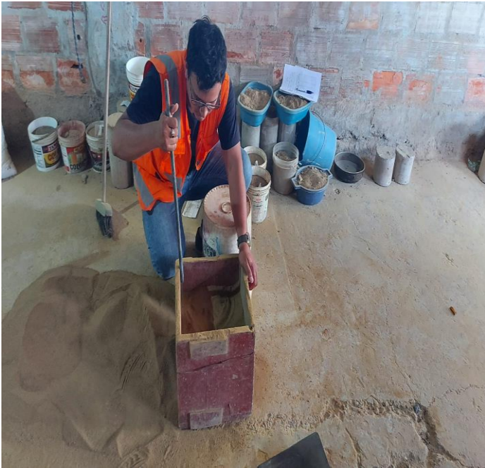
Figura 30: Realizando el ensayo de peso unitario varillado
