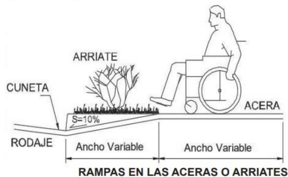
Figura 61. Rampas en las aceras.
