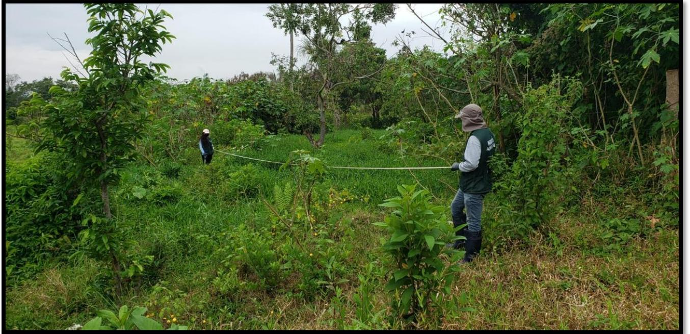
**Fotografía N° 05:** Medición de la distancia de los puntos en qué se sacará la muestra a una profundidad de 30 cm.
