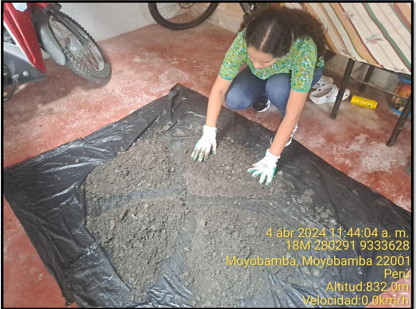
**Fotografía N° 04:** Aplicación de método de cuarteo.
