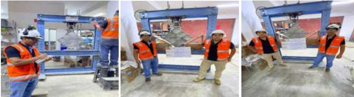
*Figura 18.* Compresión diagonal de muestra patrón 0%, 0.3%. 0.6% y 0.09% a los 14 días
