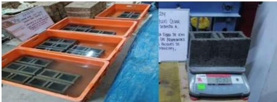
*Figura 21. Absorción del bloque de concreto en 0%, 0.3%, 0.6% y 0.9% a los 14 y 28 días.*
