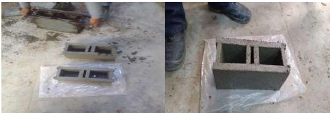
Figura 12. Pre diseño de fabricación del bloque y primera Muestra Patrón
