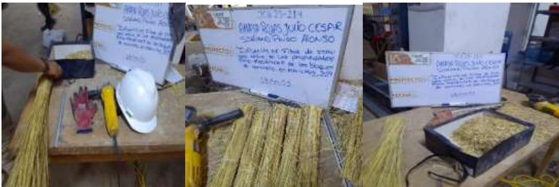
Figura 9. Separado y corte de fibra Ichu en 1"
