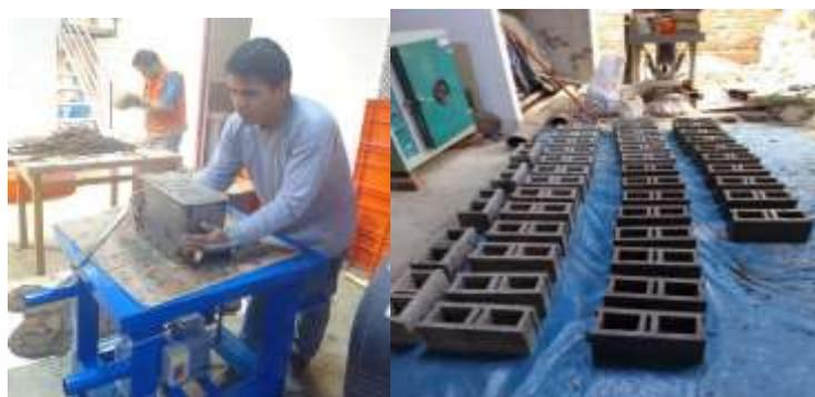
*Figura 13. Vibrado y fabricado del Bloques.*
