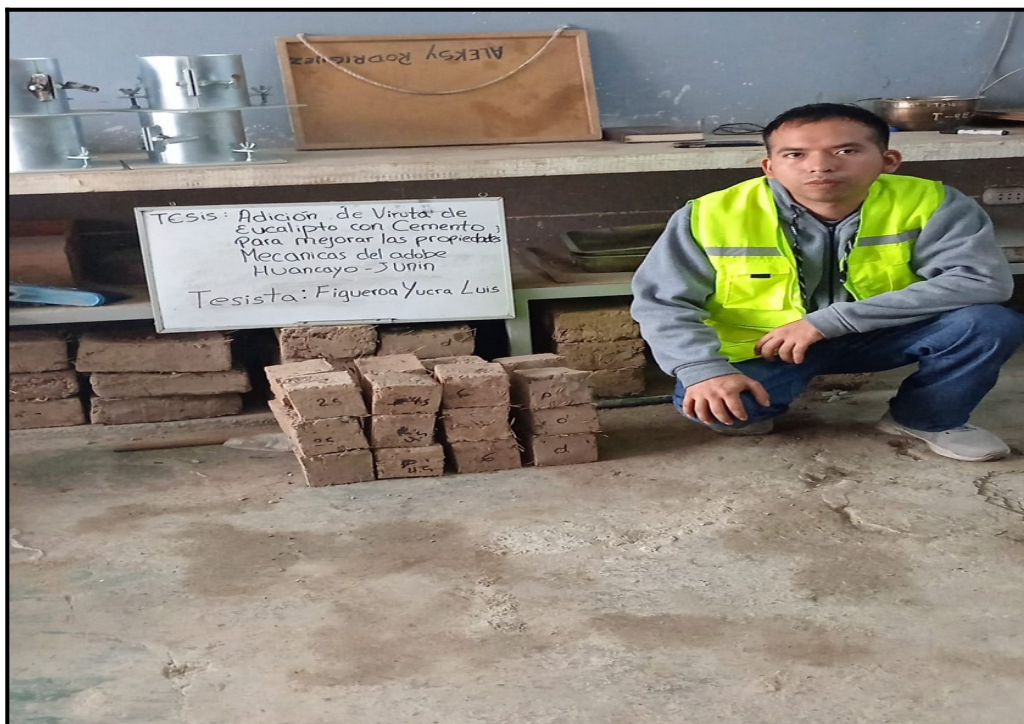
Fotografía 2: muestras para el ensayo a compresión Fuente: Elaboración propia
