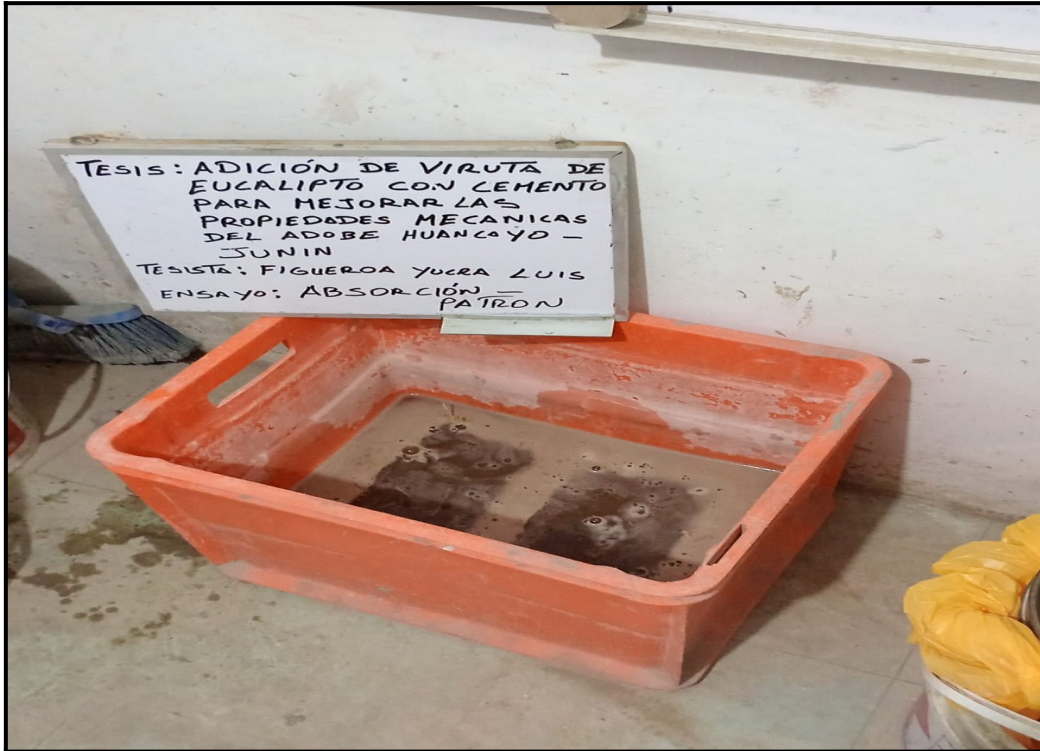
Fotografía 11: adobe patron en ensayo de absorción de humedad Fuente: Elaboración propia
