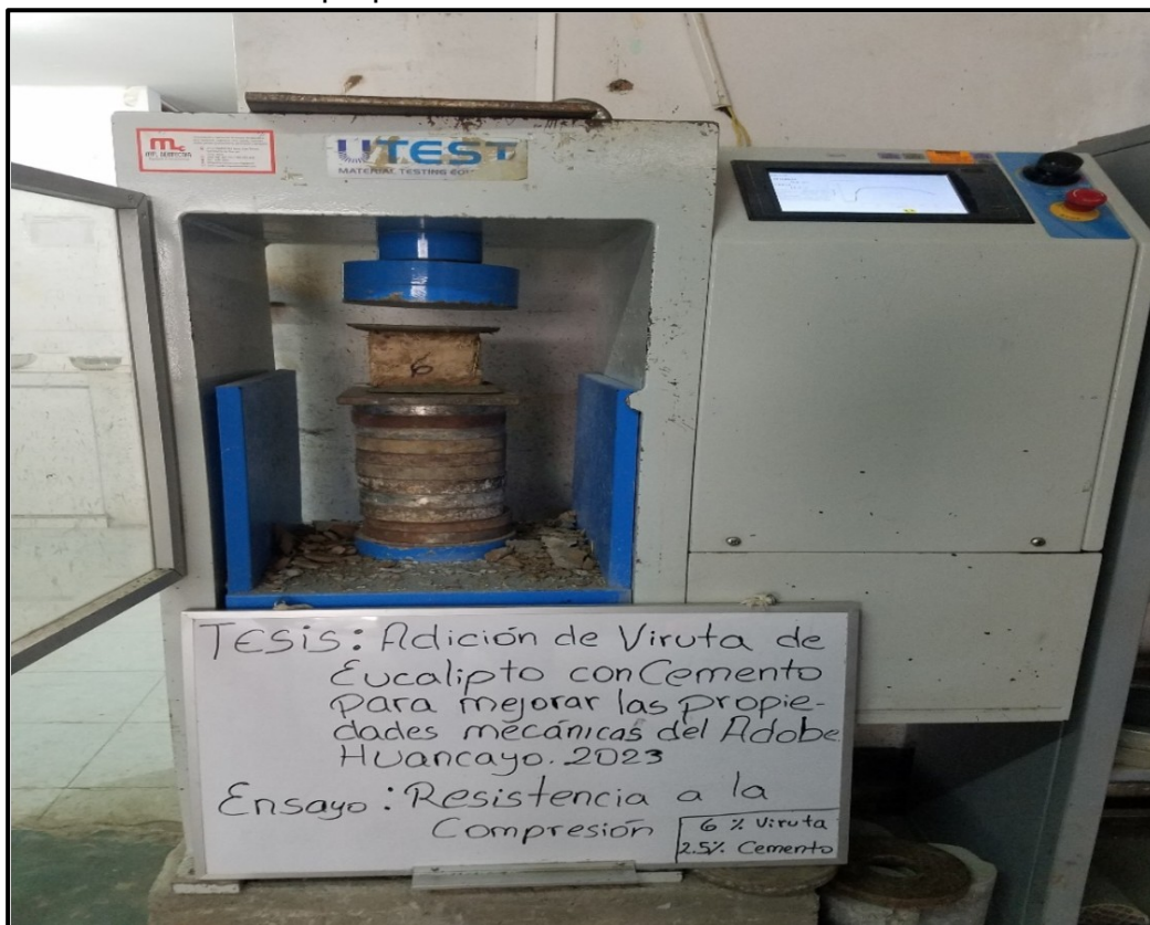
Fotografía 6: adobe de 6% de viruta con 2.5% cemento en compresión Fuente: Elaboración propia
