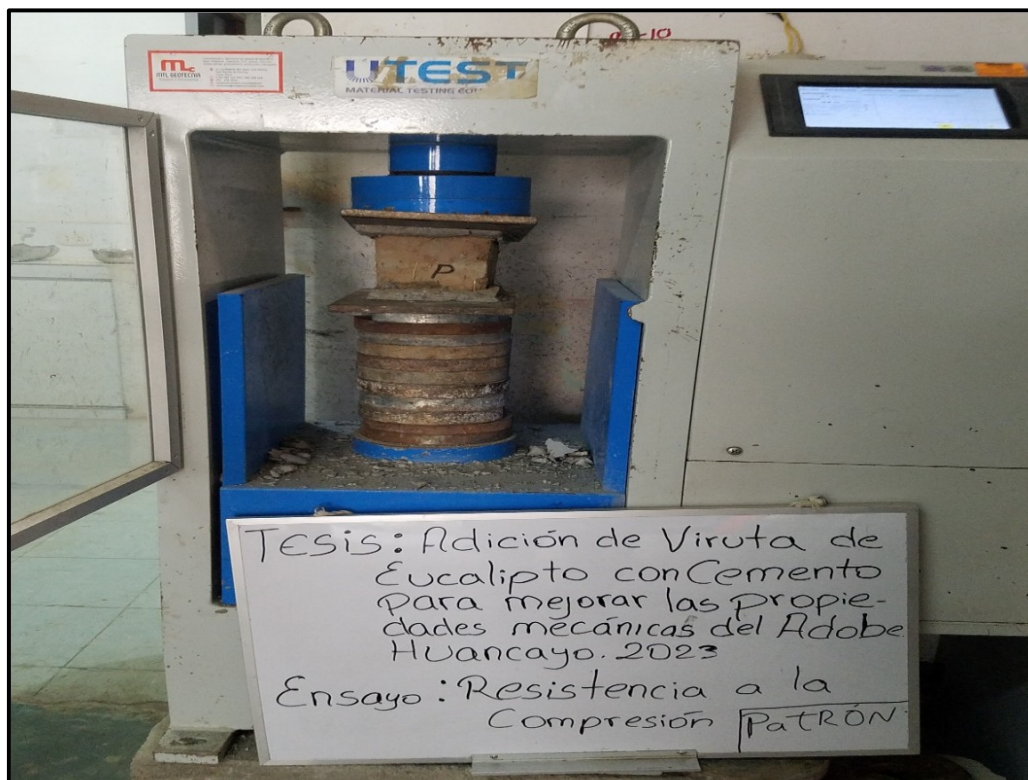
Fotografía 3: adobe patron en ensayo a compresión Fuente: Elaboración propia
