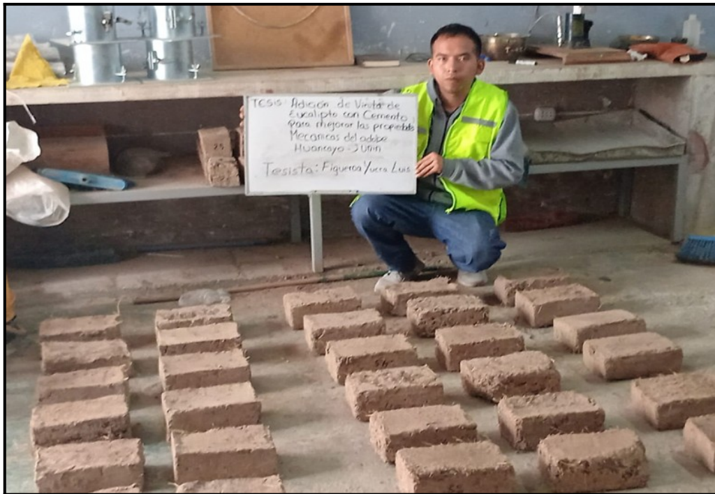
Fotografía 1: muestras para el ensayo a flexión y absorción Fuente: Elaboración propia
