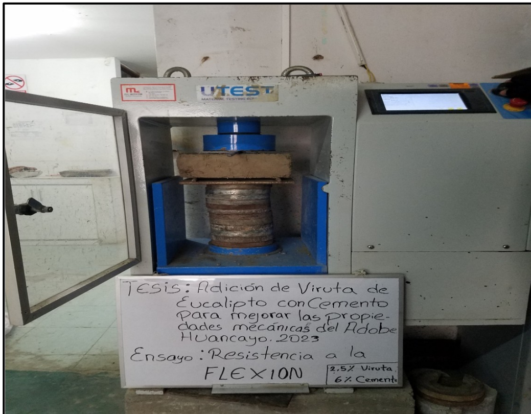
Fotografía 8: adobe de 2.5% de viruta con 6% cemento a la flexión Fuente: Elaboración propia
