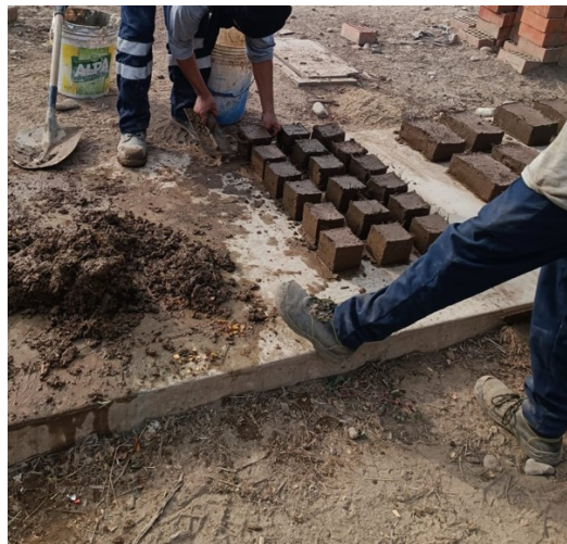
Figura 15. Adobes para ensayo a compresión
