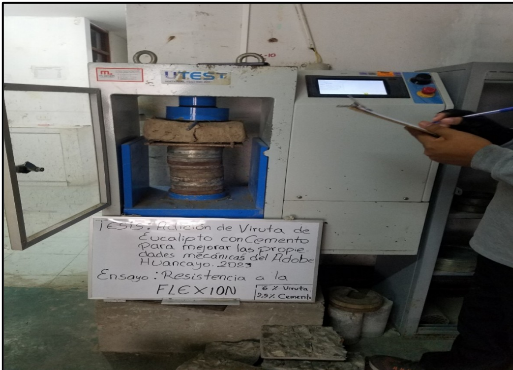
Fotografía 10: adobe de 6% de viruta con 2.5% cemento a la flexión Fuente: Elaboración propia
