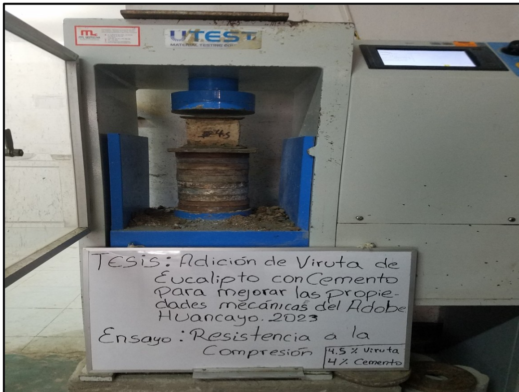
Fotografía 5: adobe de 4.5% de viruta con 4% cemento en compresión Fuente: Elaboración propia
