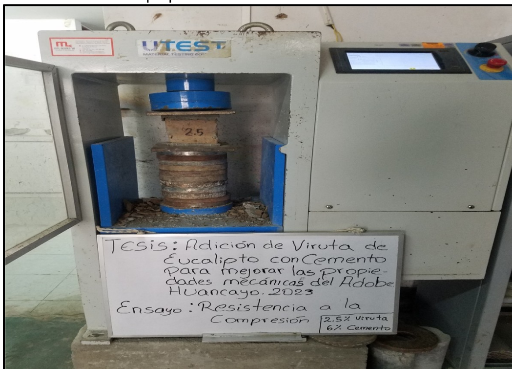
Fotografía 4: adobe de 2.5% de viruta con 6% cemento en compresión Fuente: Elaboración propia
