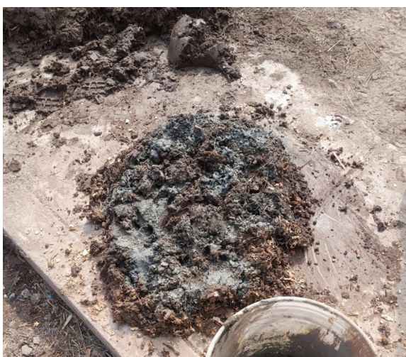
Figura 12. Incorporando cemento al diseño Fuente: Elaboración propia
