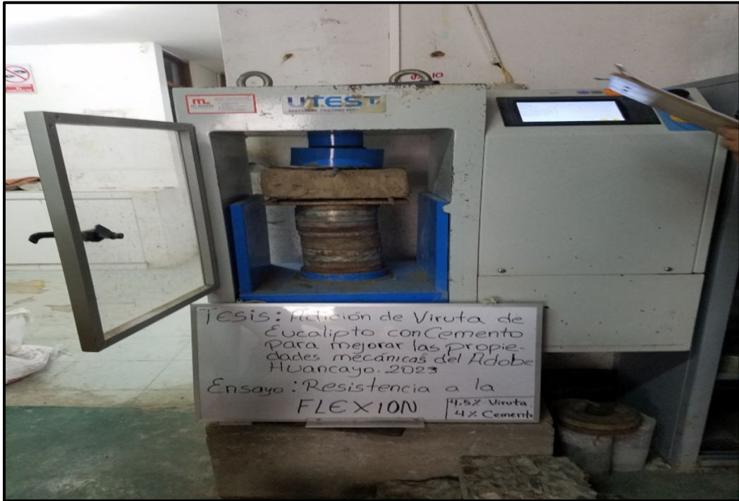
Fotografía 9: adobe de 4.5% de viruta con 4% cemento a la flexión Fuente: Elaboración propia
