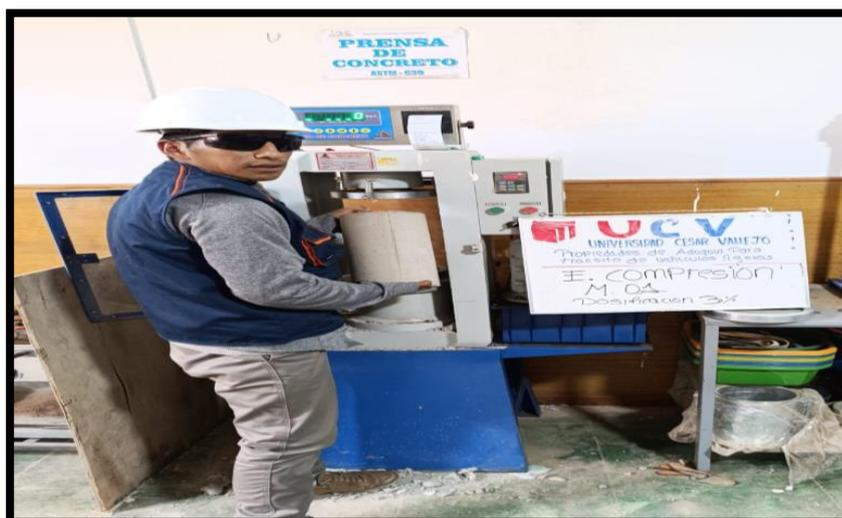
Figura 26: Resistencia a compresión a 7 días
