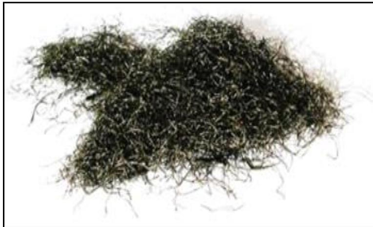
*Figura 15:* Fibra de neumático reciclado.
