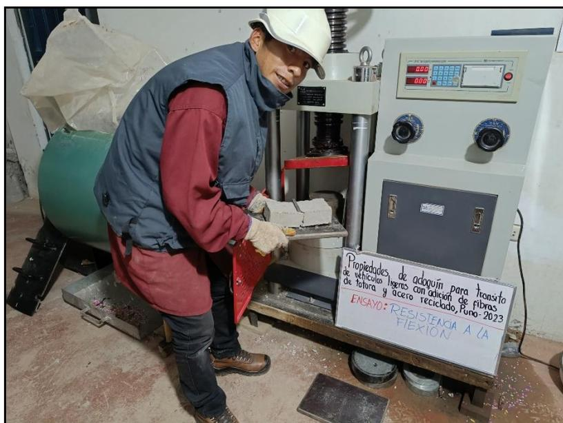
Figura 32. Resistencia a la flexión
