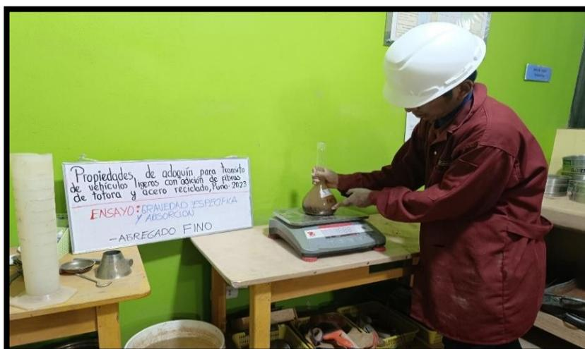
*Figura 22. Peso específico*
