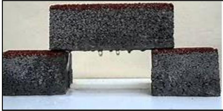
Figura 24: Absorción del adoquín
