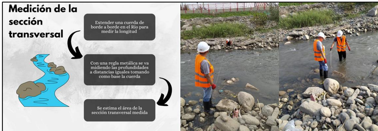
Figura 4: Medición de la sección transversal
