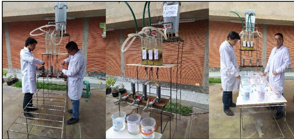
Figura 19: Armado del sistema de tratamiento para las aguas del río Chillón
