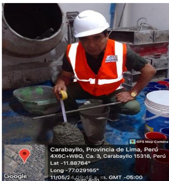
Figura 10. Ensayo de slump.
