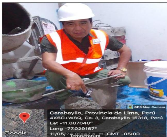
Figura 11. Medición de temperatura.
