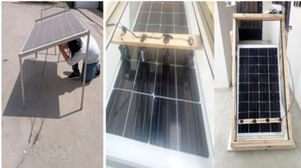
Figura 7: panel solar limpio, sucio y en proceso de limpieza
