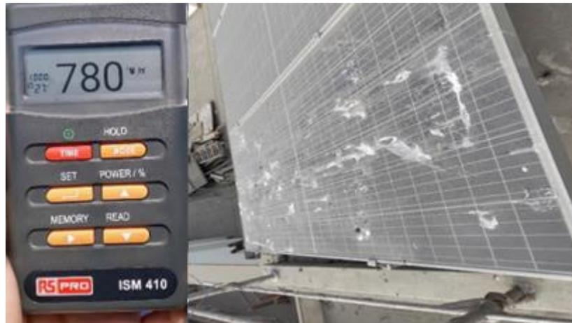
Figura 5: Medición con el solarímetro.
