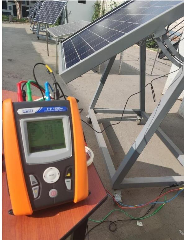
Figura 8: Medición de la potencia real de salida del panel luego de implementado el control PID.
