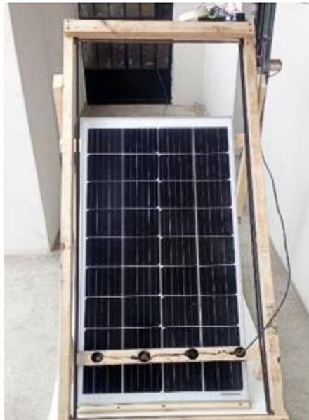
Figura 4: panel solar con el sistema automatizado de limpieza y el control PID
