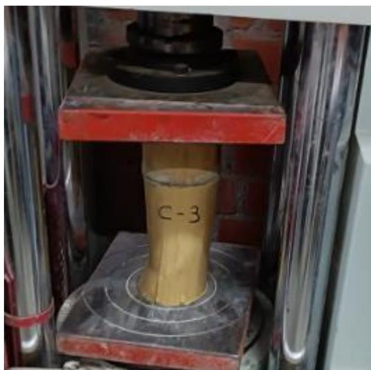
**Figura N°3.** Aplastamiento, corte, fisura paralela.
