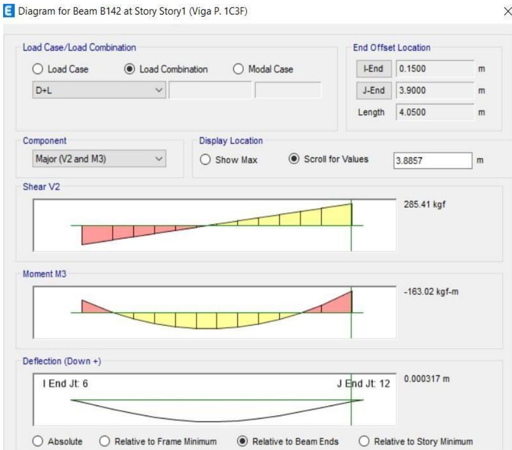
**Figura N°23:** Fuerza cortante y momento en viga perimetral
