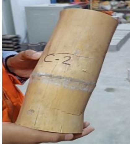
**Figura N°1.** Fisuras paralelas a la fibra
