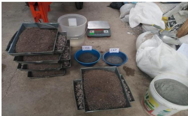
Pesado de los materiales para la preparación de la mezcla para D2= P+1.00%CHP+2.00%CHB
