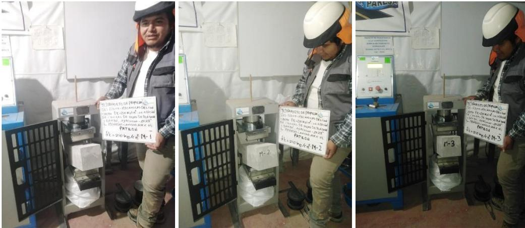
Ensayo a flexión muestra Patrón  $f'c=210\text{kg/cm}^2$  muestra M1, M2, M3 a los 14 días
