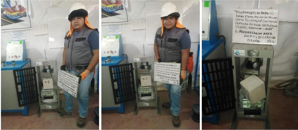
Ensayo a flexión D3: P+1.5%CHP+2.5%CHB muestra M1, M2, M3 a los 28 días
