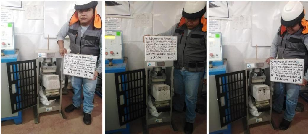
Ensayo a flexión muestra  $D1=P+0.5\%CHP+1.5\%CHB$  muestra M1, M2, M3 a los 14 días
