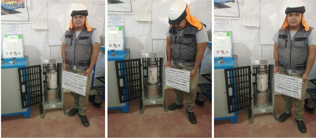
Ensayo a compresión D1: P+0.5%CHP+1.5CHB muestra M1, M2, M3 a los 28 días
