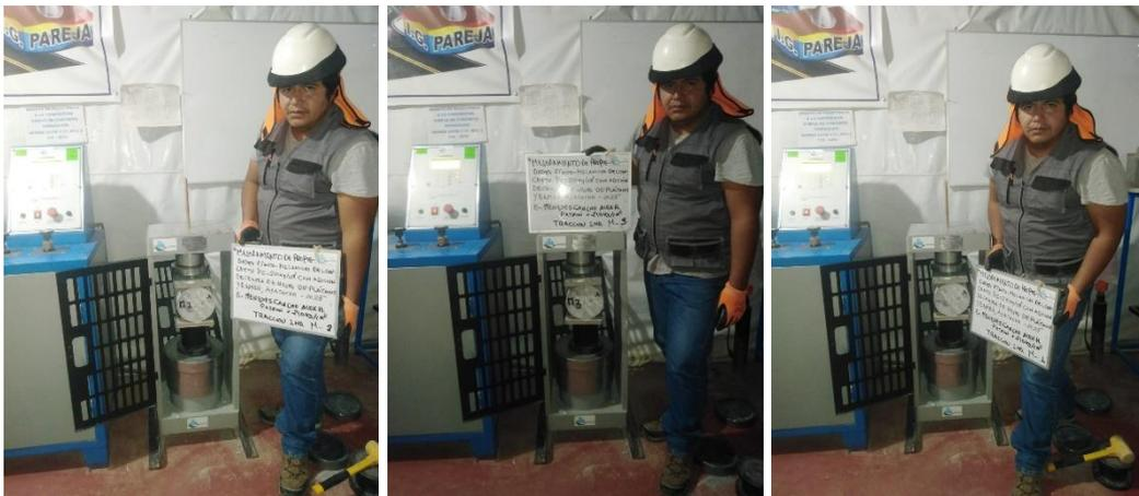
Ensayo a tracción indirecta muestra Patrón  $f'c=210\text{kg/cm}^2$  muestra M1, M2, M3 a los 28 días
