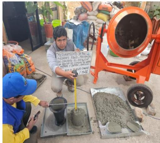
Prueba de Slump muestra patrón  $f'c=210 \text{ kg/cm}^2$
