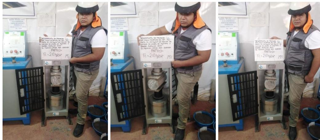
Ensayo a tracción indirecta muestra Patrón  $f'c = 210 \text{ kg/cm}^2$  muestra M1, M2, M3 a los 7 días
