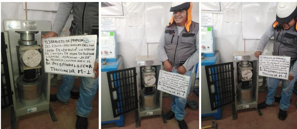
Ensayo a tracción indirecta muestra  $D1=P+0.5\%CHP+1.5\%CHB$  muestra M1, M2, M3 a los 14 días
