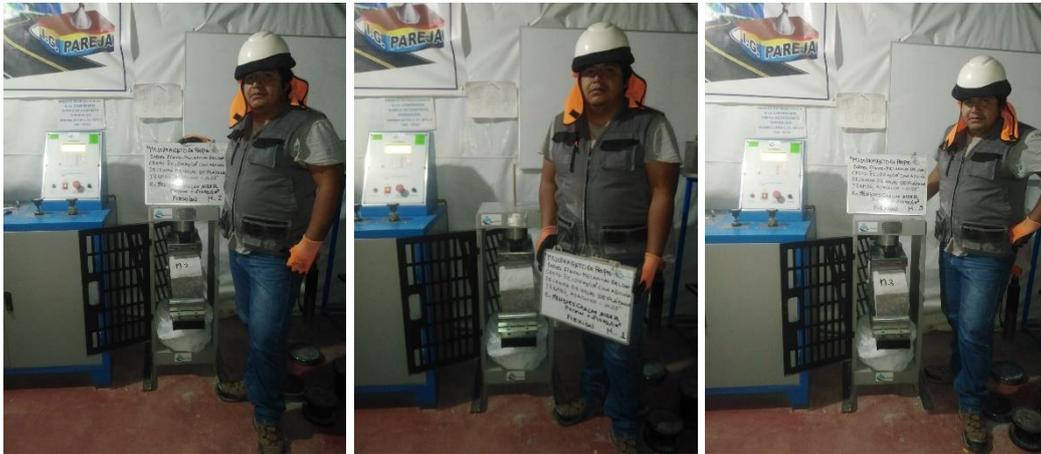
Ensayo a flexión n muestra Patrón  $f'c=210\text{kg/cm}^2$  muestra M1, M2, M3 a los 28 días
