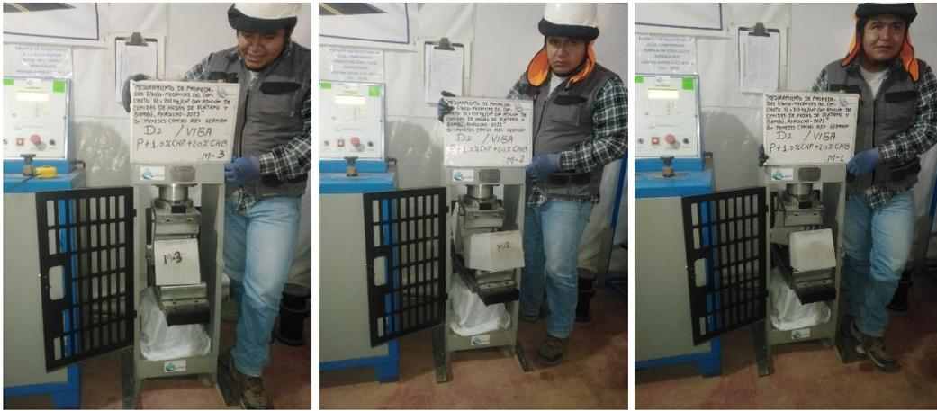
Ensayo a flexión muestra D2=P+1.0%CHP+2.0%CHB muestra M1, M2, M3 a los 7 días
