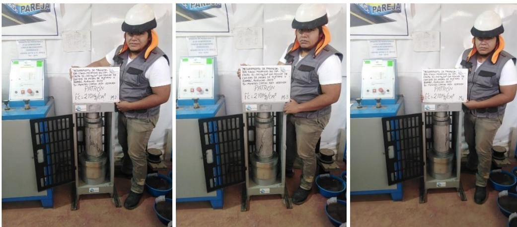
Ensayo a compresión muestra Patrón  $f'c = 210 \text{ kg/cm}^2$  muestra M1, M2, M3 a los 7 días
