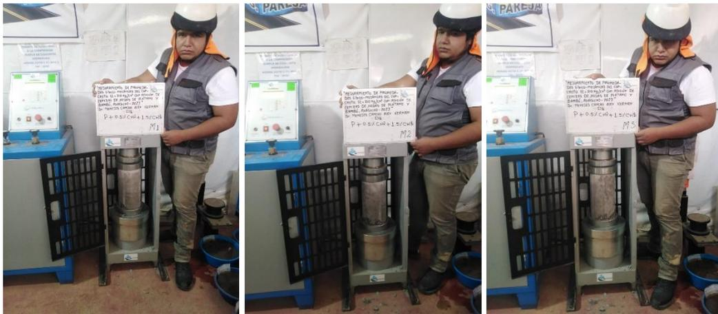
Ensayo a compresión muestra D1= $P+0.5\%CHP+1.5\%CHB$  muestra M1, M2, M3 a los 7 días
