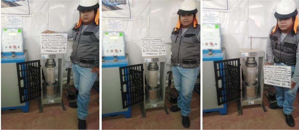
Ensayo a compresión muestra  $D1=P+0.5\%CHP+1.5\%CHB$  muestra M1, M2, M3 a los 14 días
