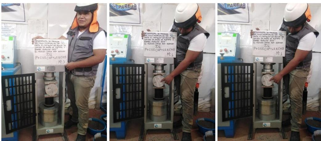
Ensayo a tracción indirecta muestra D1= $P+0.5\%CHP+1.5\%CHB$  muestra M1, M2, M3 a los 7 días
