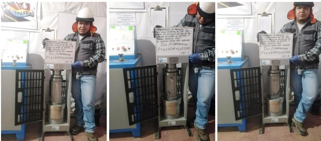
Ensayo a compresión muestra D2=P+1.0%CHP+2.0%CHB muestra M1, M2, M3 a los 7 días
