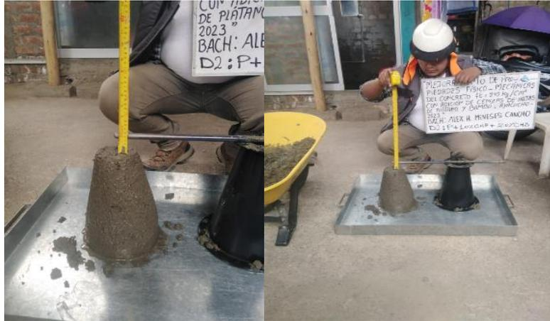
Prueba de Slump muestra para  $D2 = P+1.00\%CHP+2.00\%CHB$
