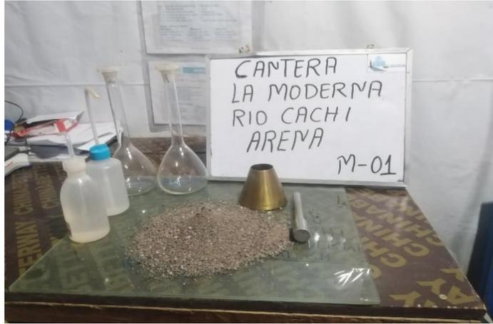
Ensayo de densidad especifica de agregado fino
