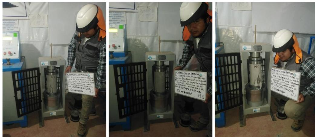
Ensayo a compresión muestra D3=P+1.5%CHP+2.5%CHB muestra M1, M2, M3 a los 7 días
