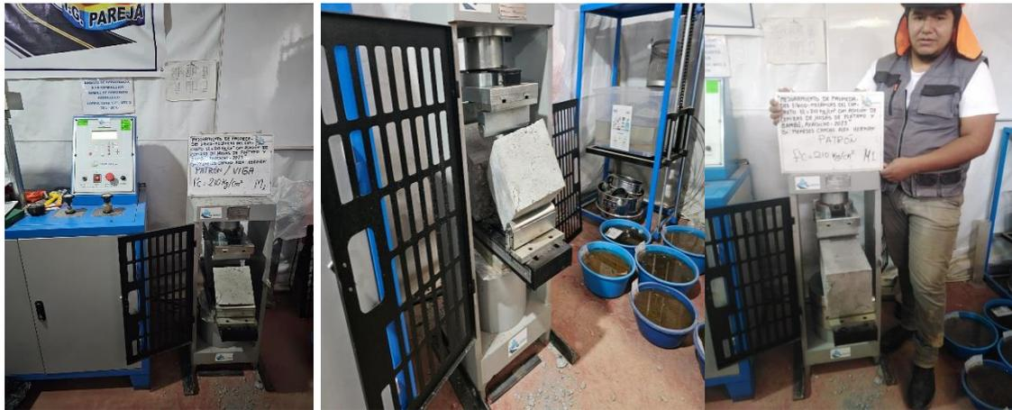
Ensayo a flexión muestra Patrón  $f'c = 210 \text{ kg/cm}^2$  muestra M1, M2, M3 a los 7 días
