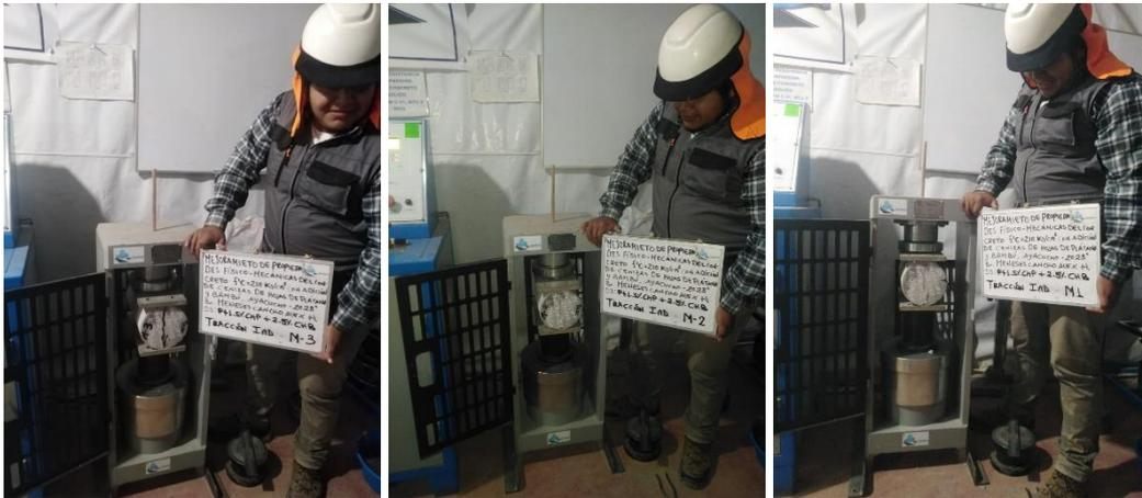
Ensayo a tracción indirecta muestra D3=P+1.5%CHP+2.5%CHB muestra M1, M2, M3 a los 7 días
