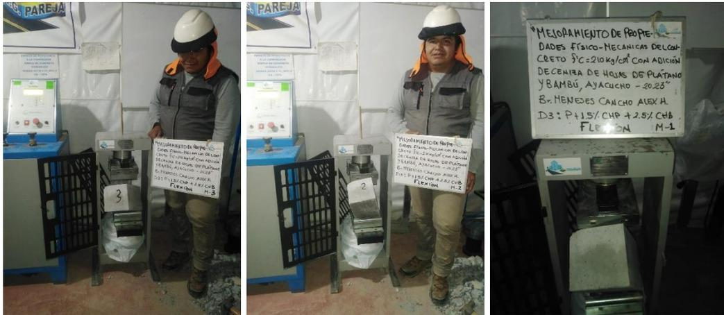
Ensayo a flexión muestra D3=P+1.5%CHP+2.5%CHB muestra M1, M2, M3 a los 14 días
