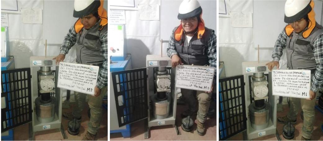
Ensayo a tracción indirecta muestra Patrón  $f_c=210\text{kg/cm}^2$  muestra M1, M2, M3 a los 14 días
