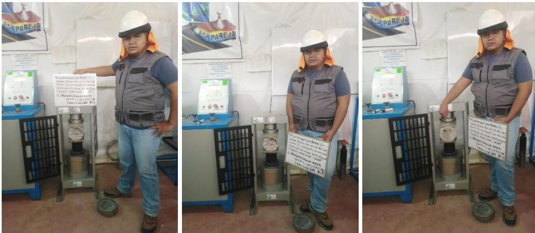
Ensayo a tracción indirecta D3: P+1.5%CHP+2.5CHB muestra M1, M2, M3 a los 28 días
