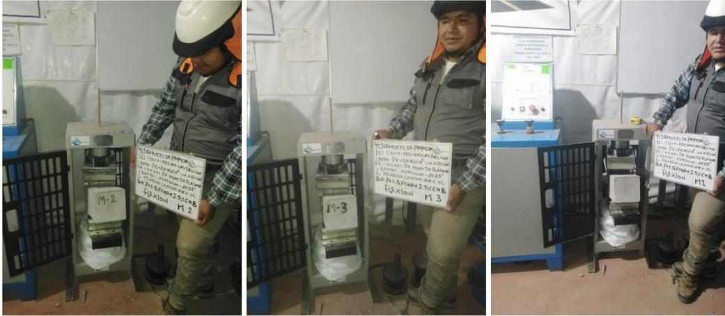
Ensayo a flexión muestra D3=P+1.5%CHP+2.5%CHB muestra M1, M2, M3 a los 7 días
