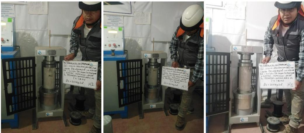
Ensayo a compresión muestra Patrón  $f'c=210\text{kg/cm}^2$  muestra M1, M2, M3 a los 14 días
