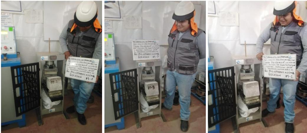
Ensayo a flexión muestra  $D2=P+1.0\%CHP+2.0\%CHB$  muestra M1, M2, M3 a los 14 días
