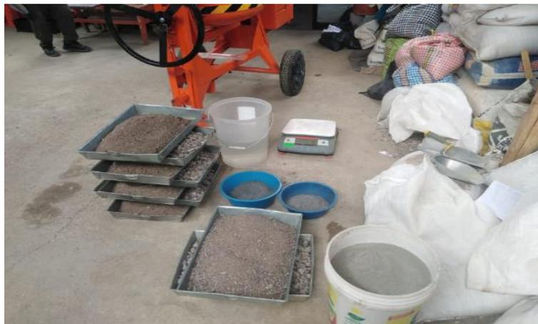
Pesado de los materiales para la preparación de la mezcla para D1= P+0.5%CHP+1.5%CHB
