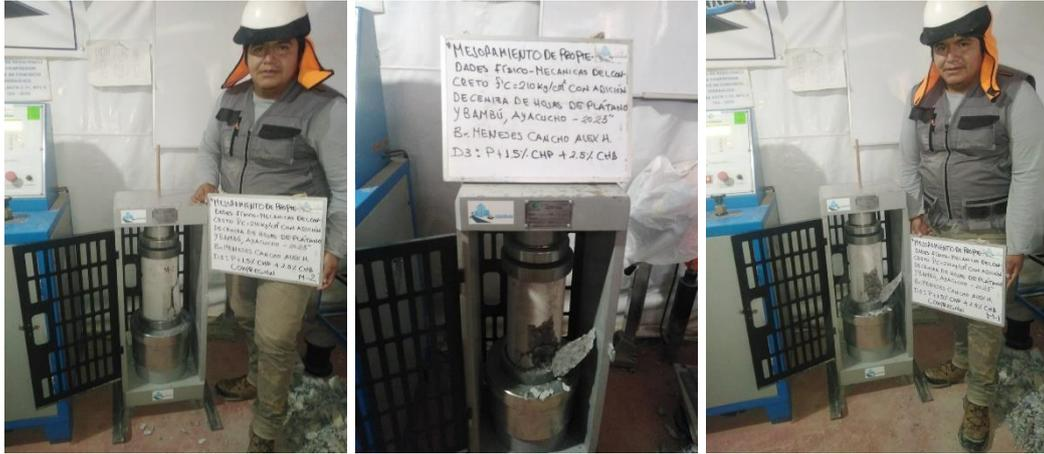
Ensayo a compresión muestra D3=P+1.5%CHP+2.5%CHB muestra M1, M2, M3 a los 14 días
