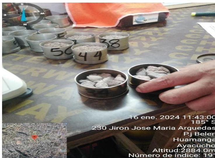
Muestra para contenido de humedad agregado grueso
