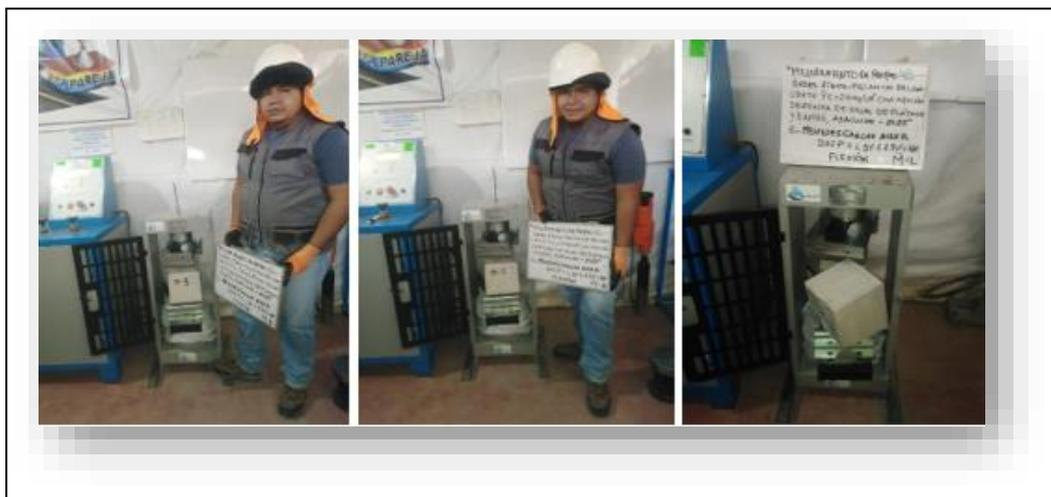
Figura 33. Ensayo Flexión del concreto 28 días
