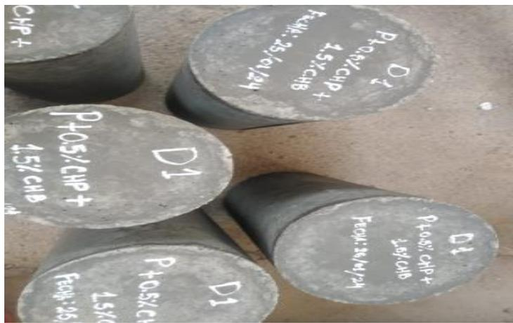
Probetas de la muestra D1= P+0.5%CHP+1.5%CHB
