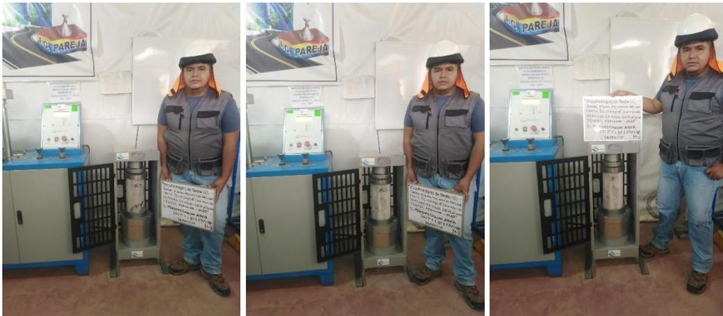
Ensayo a compresión D3: P+1.5%CHP+2.5CHB muestra M1, M2, M3 a los 28 días
