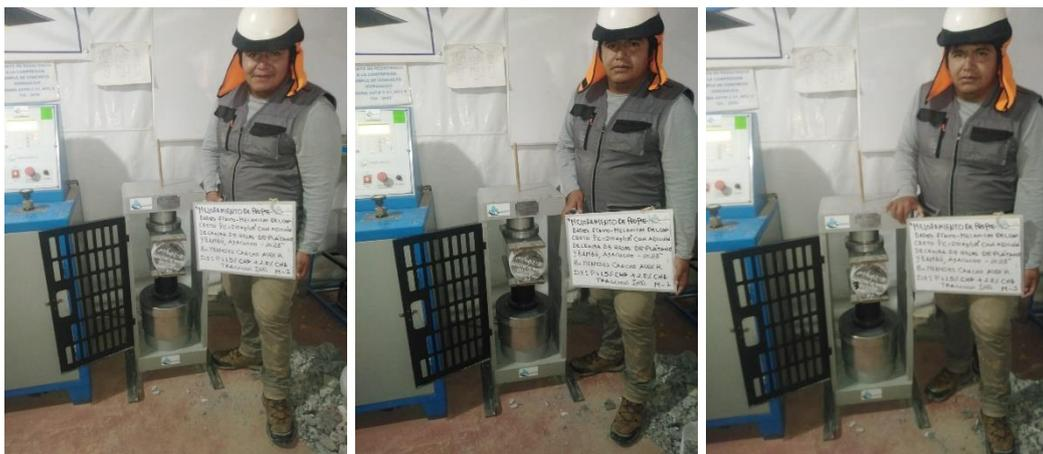
Ensayo a tracción indirecta muestra D3=P+1.5%CHP+2.5%CHB muestra M1, M2, M3 a los 14 días
