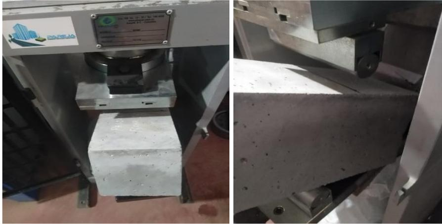
Ensayo a flexión muestra D1=P+0.5%CHP+1.5%CHB muestra M1, M2, M3 a los 7 días
