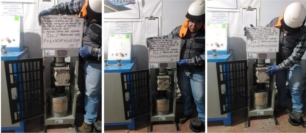
Ensayo a tracción indirecta muestra D2=P+1.0%CHP+2.0%CHB muestra M1, M2, M3 a los 7 días
