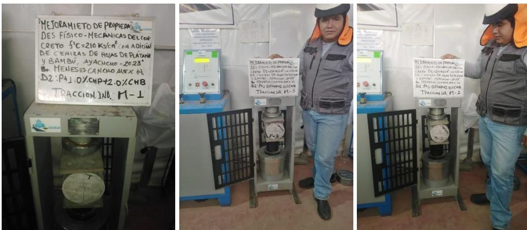
Ensayo a tracción indirecta muestra  $D2=P+1.0\%CHP+2.0\%CHB$  muestra M1, M2, M3 a los 14 días
