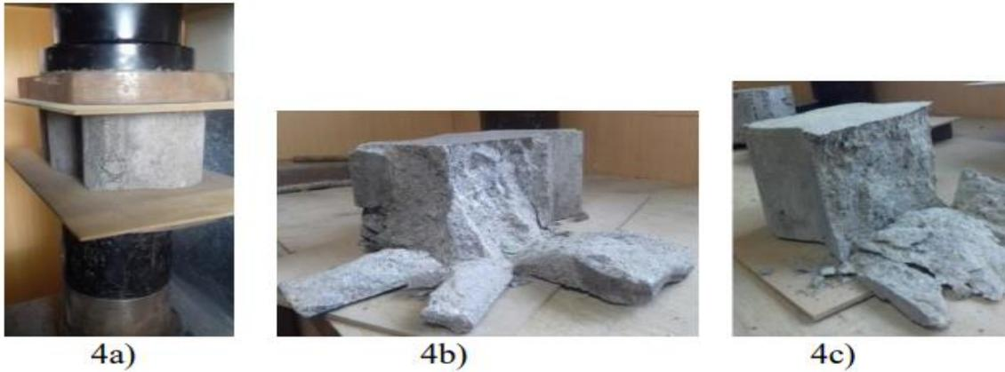
Figura 16. Adoquín entero y liso (4 a) en rotura típica de adoquín entero (4 b) rotura típica de medio adoquín (4 c)
