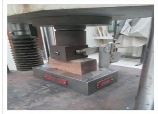
Ensayo de compresión perpendicular
