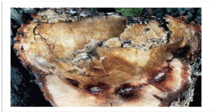
Figura 12: Pudrición blanda, cuando hay una pérdida significativa de resistencia
