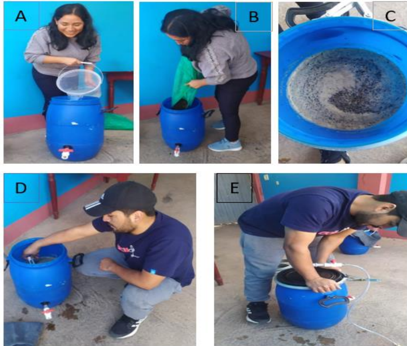
Figura 9. Llenado, mezclado, toma de pH y sellado de los biodigestores; A) Llenado de agua; B) Llenado de excreta; C) Mezclado; D) Toma de temperatura; E) Sellado.
