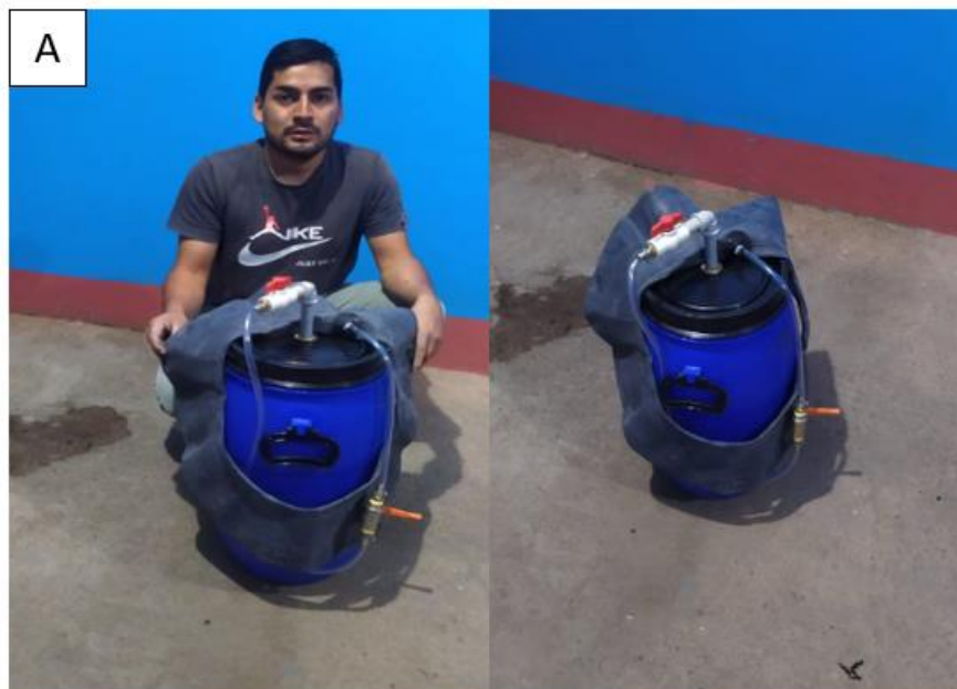
Figura 14. Almacenamiento del biogás; A) Se concluyó la elaboración del biodigestor.
