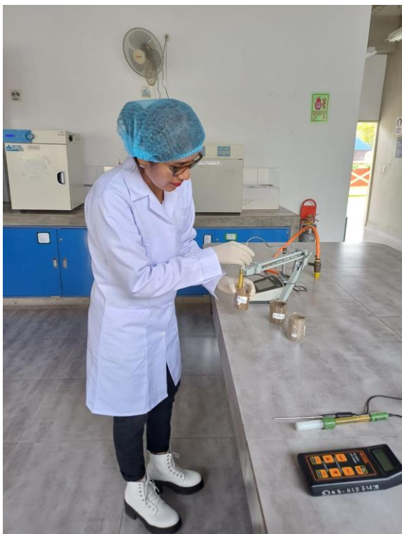
Caracterización del suelo de las muestras M1, M2, y M3, midiendo el grado de acidez, temperatura, entre otros parámetros.
