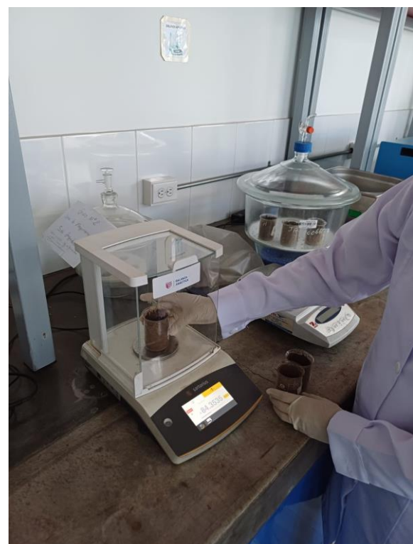
Pesado para la separación de 12 muestras de suelo por cada textura; con aproximadamente 100 g por muestra.
