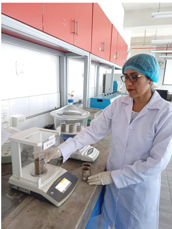
Separación de una porción de las muestras (M1, M2, y M3) antes de contaminarlas con petróleo crudo.
