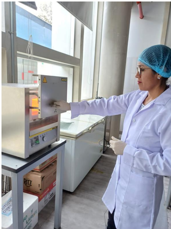
Se llevó el material trititado al horno a una temperatura de 300°C por 5 horas, para luego pasar por un segundo proceso de trititación y tamizado.
