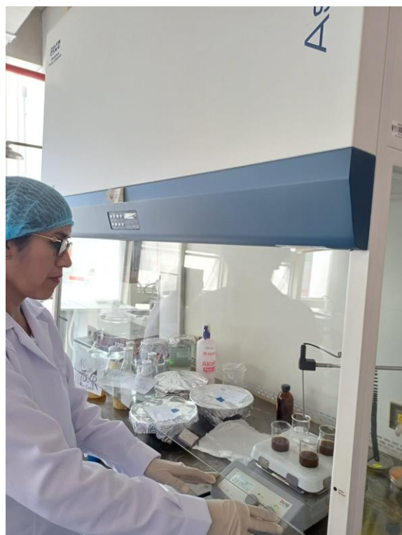
Evaluación de 3 tratamientos con diferentes dosis de oxidante peróxido de hidrogeno siendo de 5, 10 y 15 mL de H 2 O 2 respectivamente y como agente catalizador al sulfato ferroso (FeSO 4 ) con una dosis constante de 20 mL.
