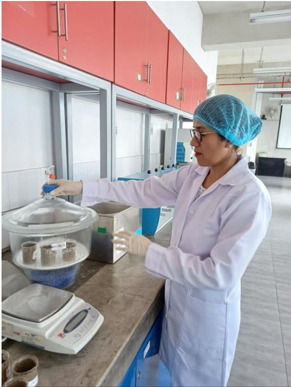
Almacenamiento de los 3 tratamientos con dosis de 10, 30 y 50 gramos de biochar respectivamente. Cada tratamiento fue de 4 experimentaciones (R1, R2, R3 y R4), almacenadas por un periodo de 20 días.
