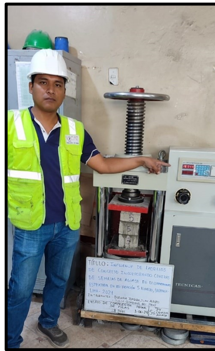
Ensayo a compresión a pilas - 5 % CSA
