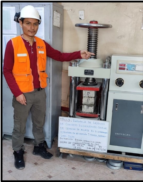
Ensayo a compresión a pilas - patrón
