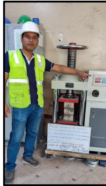
Ensayo a compresión a pilas - 1% CSA
