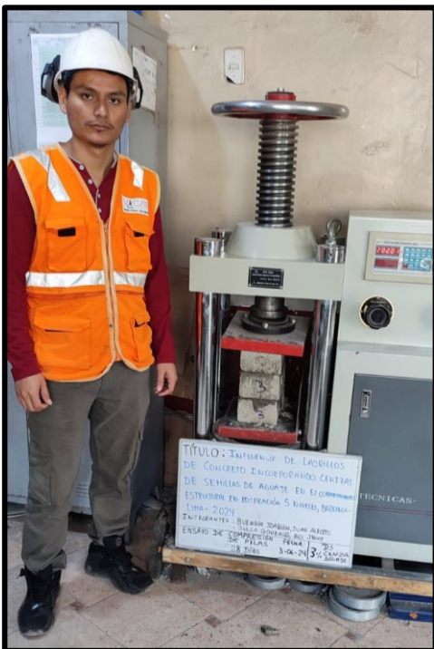
Ensayo a compresión a pilas - 3 % CSA
