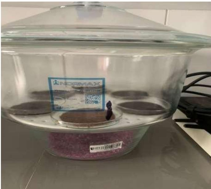
**Figura 2118.** *Uso del desecador para determinar la humedad*
