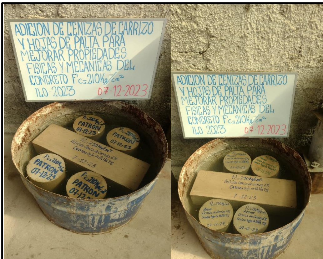
Fotografía 35. Vista de curado de probetas sumergiéndolas en bateas cilíndricas con agua potable.
