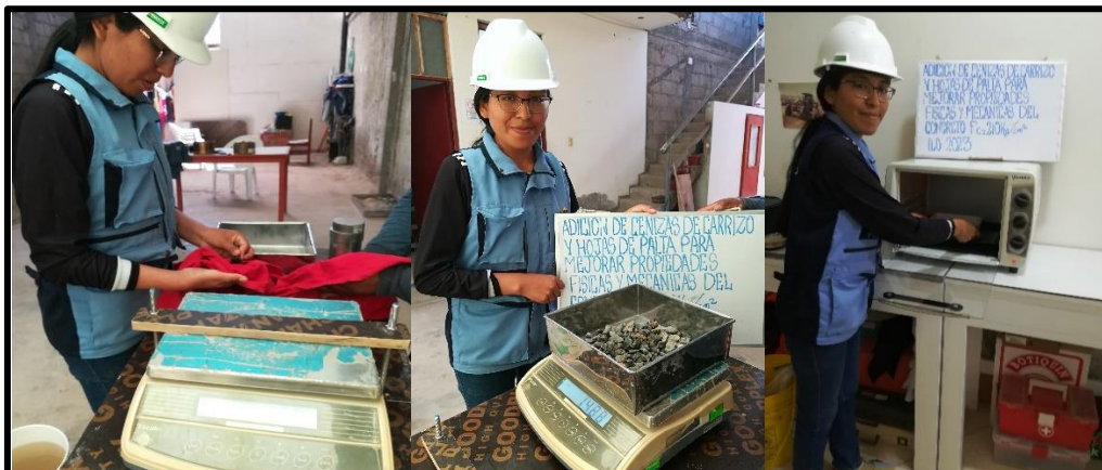
Fotografía 27. G. Especifica, una vez extraído la piedra chancada se secó, luego se taró y peso el recipiente y después se pesó la piedra en el recipiente, finalmente se colocó en el horno por 24hrs.
