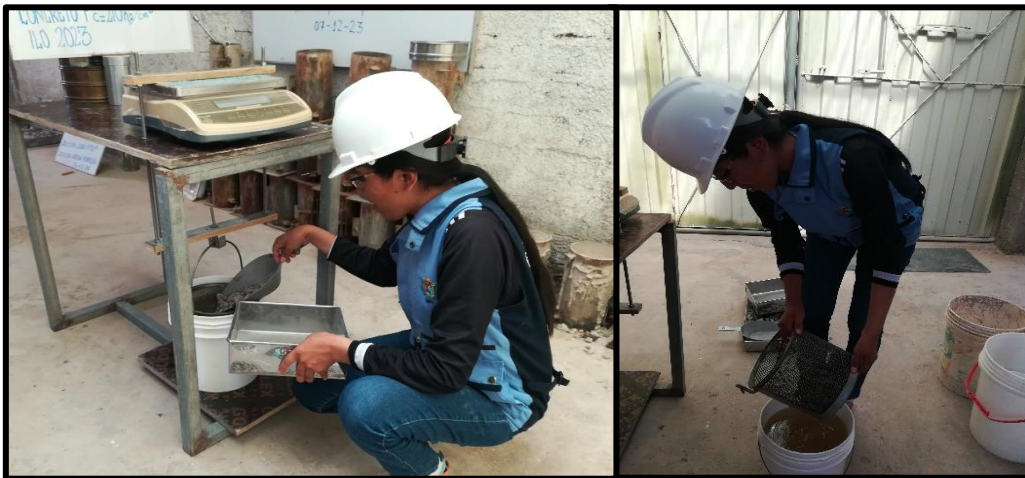
Fotografía 26. G. Especifica material grueso, se sumergió al agua esto previo al pesaje realizado antes, después de 24 hrs se extrajo del agua
