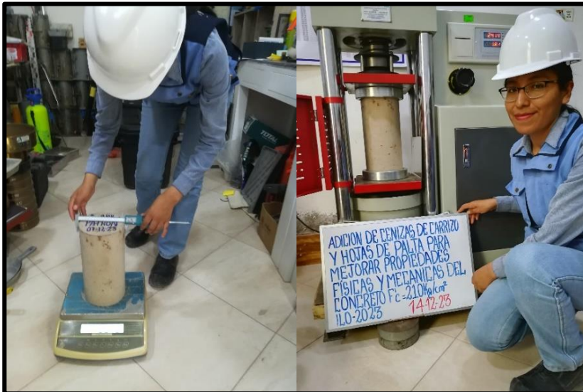
Fotografía 36. Compresión, rotura a los 07, 14 y 28 días de curado las probetas tipo cilíndricas
