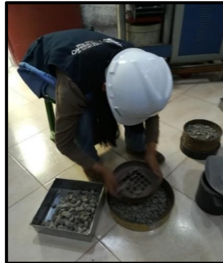
Fotografía 09. Tamizado de agregados
