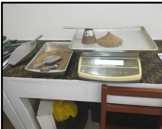
Fotografía 22. P.U. Compactado de agregado fino: se retira a un costado el molde cónico.
