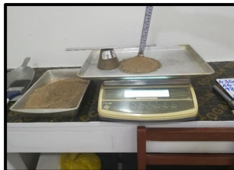
Fotografía 19. P.U. Suelto: Medición de altura que cedió el agregado fino.
