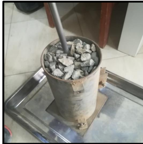
Fotografía 15. Desarrollo de peso unitario varillado agregado grueso.
