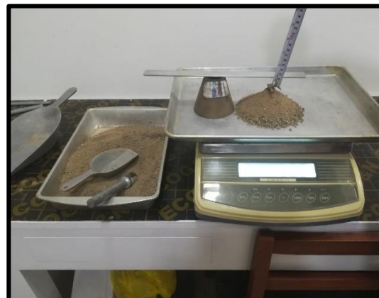
Fotografía 23. P.U. Compactado: Medición de altura que cedió el agregado fino.
