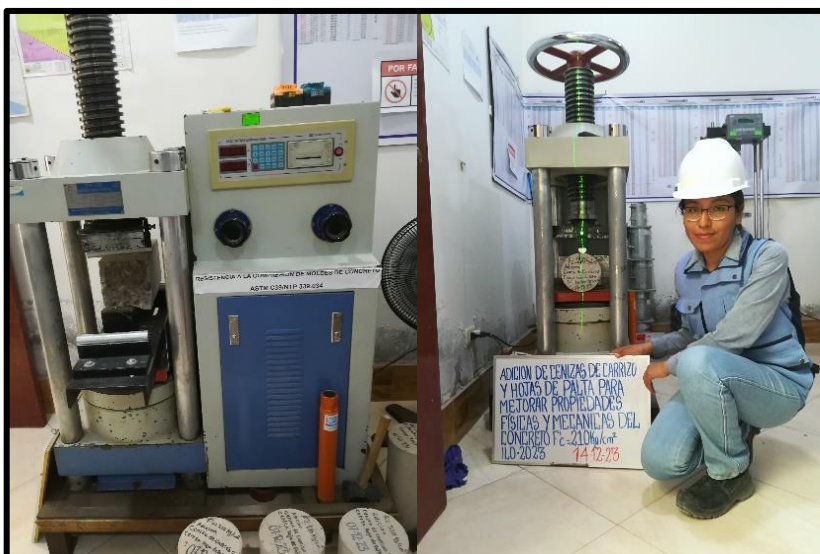
Fotografía 38. Tracción Rotura a los 07, 14 y 28 días de curado las probetas tipo cilíndricas
