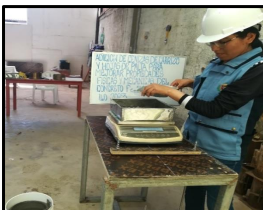
Fotografía 24. Desarrollo para hallar gravedad específica y absorción de material grueso.
