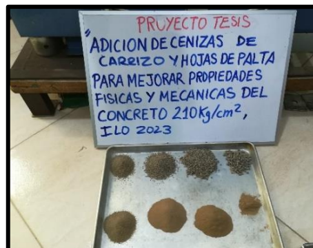
Fotografía 13. Granulometría de agregado fino.
