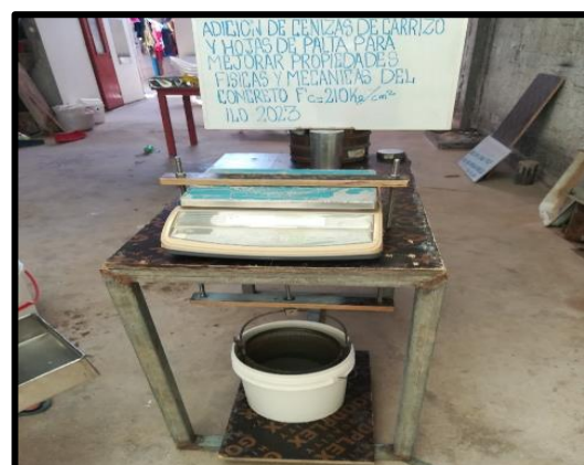
Fotografía 25. Tara de balde con agua para sumergir el agregado (piedra chancada)
