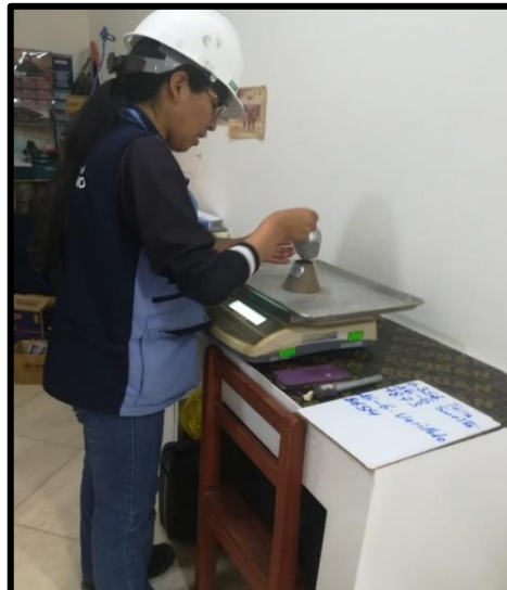
Fotografía 17. P.U. Suelto Llenado y pesaje de agregado fino.
