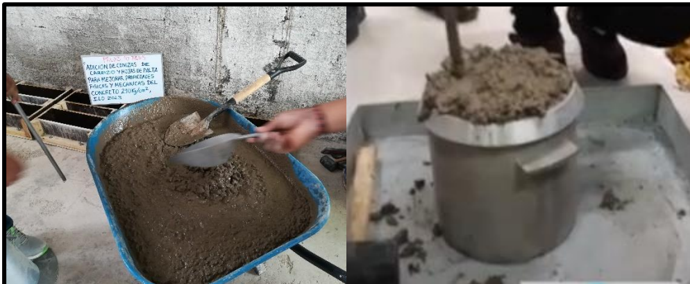
Fotografía 33. Realización de Peso unitario de C° y Contenido de Aire con olla Washington
