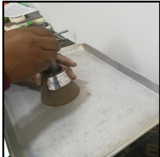
Fotografía 21. P.U. Compactado: compactación en 03 capas de 25 golpes.
