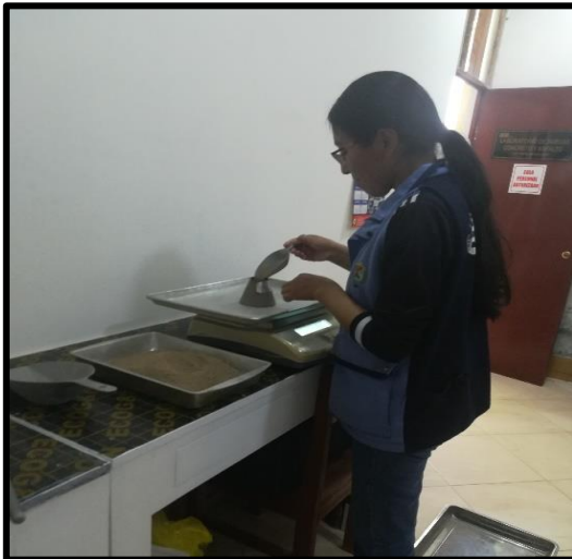
Fotografía 20. P.U. Compactado de agregado fino: llenado, pesaje
