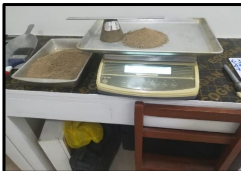
Fotografía 18. Retiro de molde después de haber llenado el agregado fino.
