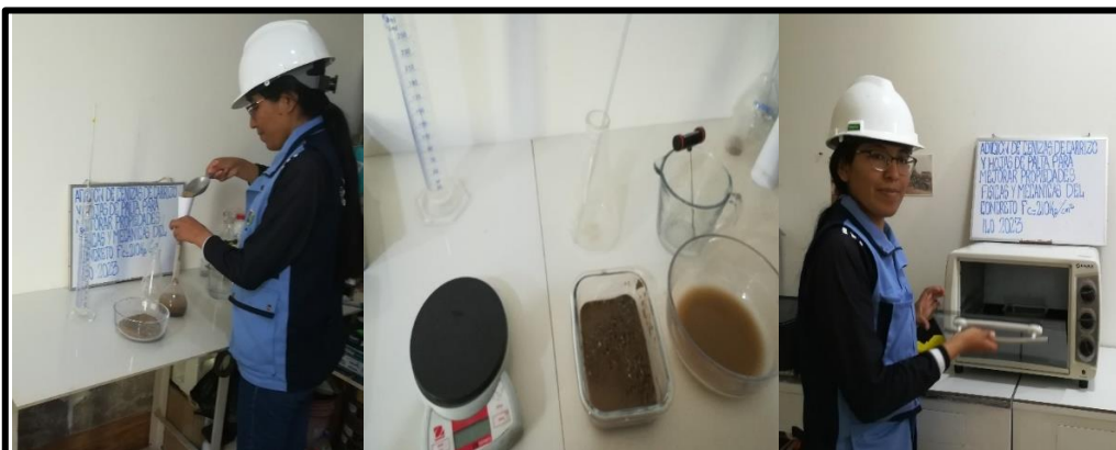
Fotografía 28. G. Especifica material fino (arena), sumergido de arena en la fiola por 24hrs., extraerlo en un frasco, pesarlo y finalmente poner al horno por 24hrs.
