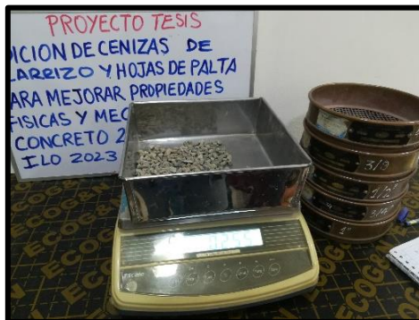
Fotografía 10. Pesaje de los pasantes por cada tamiz de agregado grueso.
