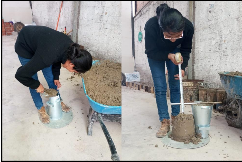
Fotografía 32. Verificación de asentamiento (Slump), mediante el cono de abrahams.
