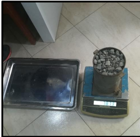
Fotografía 14. Desarrollo de peso unitario suelto agregado grueso.
