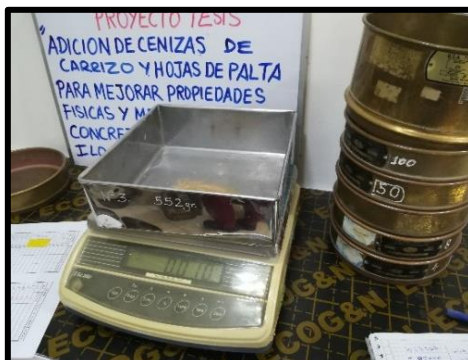
Fotografía 12. Pesaje de los pasantes por cada tamiz de aaregado fino.
