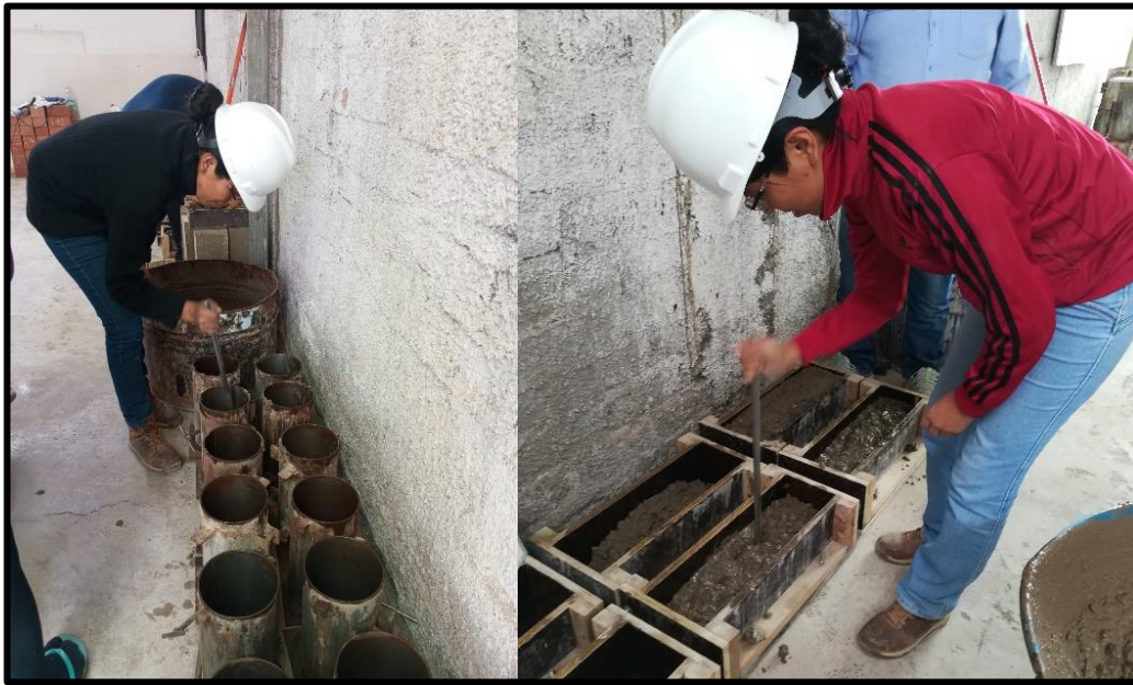
Fotografía 34. Elaborado de probetas tipo cilindro y vigas para los ensayos de propiedad mecánica.
