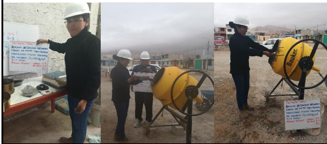
Fotografía 30. Mezcla C° adicionando cenizas de carrizo + cenizas de hoja de palta. Primero se tamizo las cenizas por la malla N°200. Se hizo el pesado de todos los materiales según el diseño de mezcla, se consideró el pesaje de los porcentajes de cenizas que se muestran en el gráfico, que se plantearon adicionar lo cual sustituyen al cemento en la cantidad del porcentaje de cenizas, posterior a ello se preparó la mezcla del mismo.
