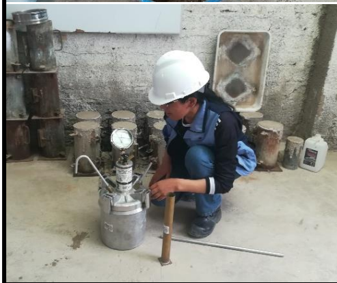
Fotografía 33. Realización de Peso unitario de C° y Contenido de Aire con olla Washington
