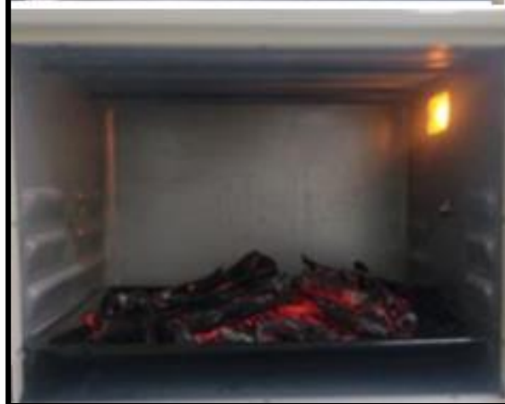
Fotografía 06. Calcinación de carrizo con T° de 600°C
