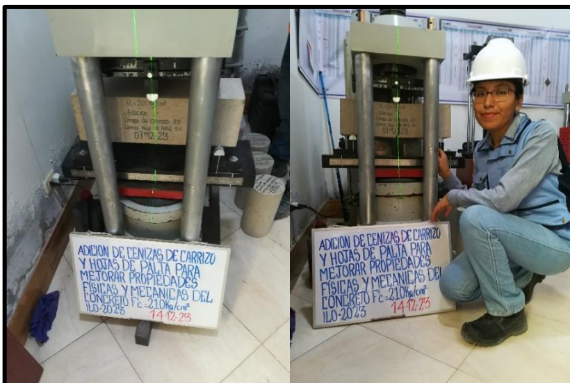
Fotografía 37. Flexión Rotura a los 07, 14 y 28 días de curado | los testigos tipo viga
