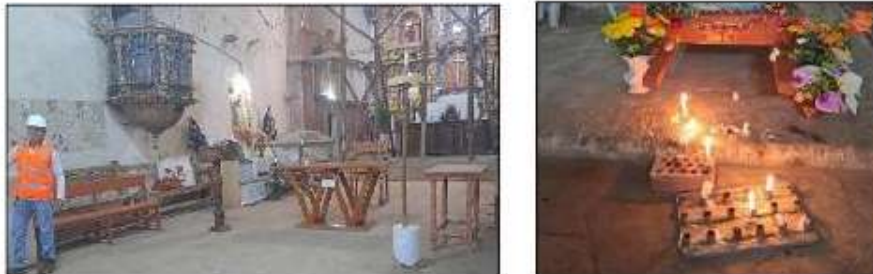
Figura: Presencia de ornamentos y muebles inflamables.
