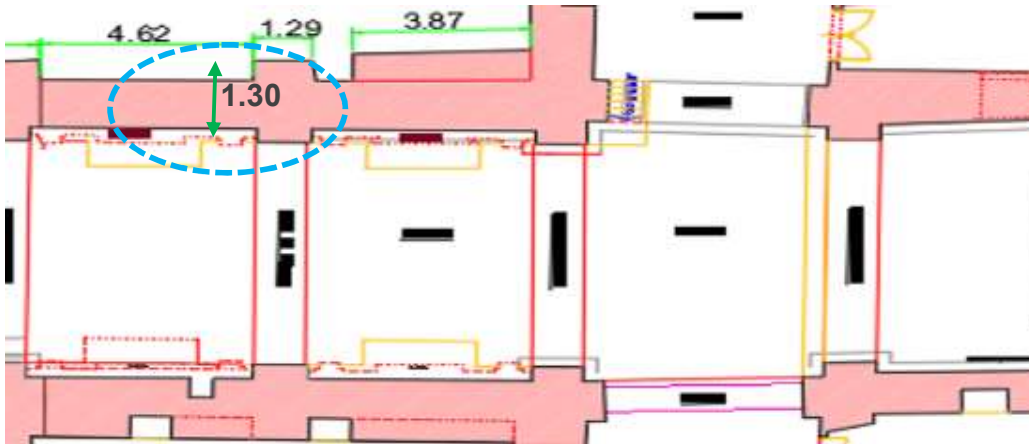
Figura 27. Espesor promedio de muros de la iglesia
