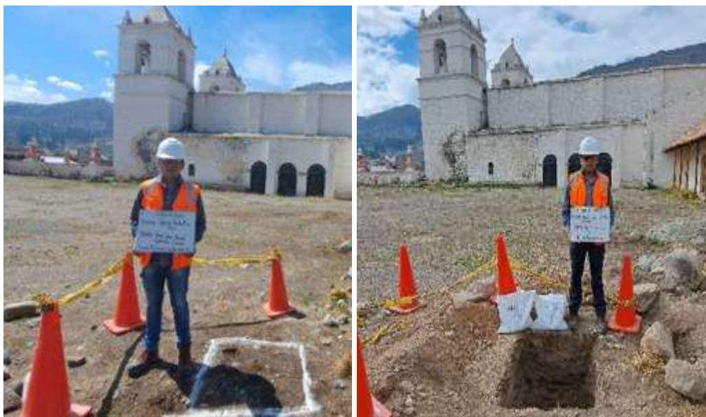
Figura 22. Calicata y extracción de muestras de suelo (Iglesia Santa Ana)
