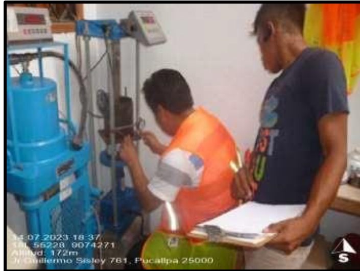
Figura 15. Prueba de penetración para la determinación del CBR
