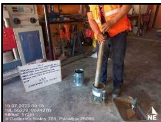
Figura 20. Ensayo de CBR incorporación de Mezcla Asfáltica reciclada
