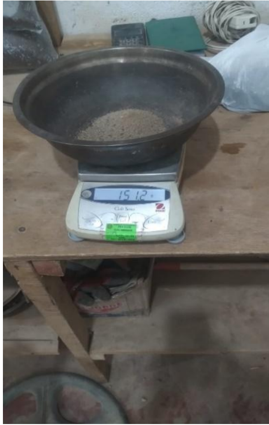
Foto 04: Pesaje de agregados y materiales
