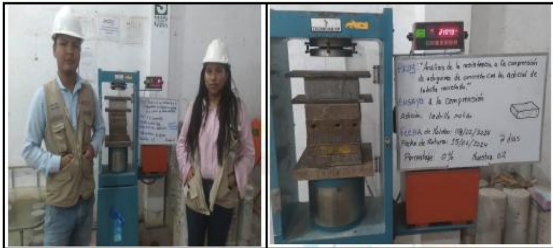
Fotos n° 13-14: En las imágenes podemos observar la resistencia a la compresión axial de los adoquines de concreto.
