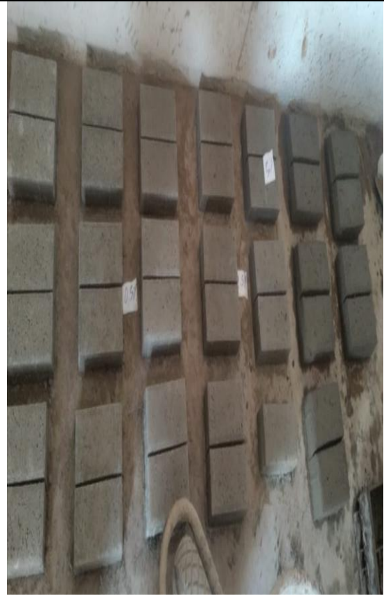
Foto 10: Adoquines luego del curado
