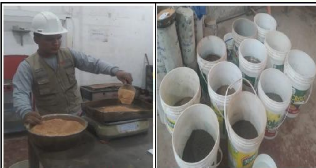
Fotos nº 09-10: En las imágenes podemos apreciar los materiales a utilizar para el diseño de concreto con incorporación de ladrillo reciclado.
