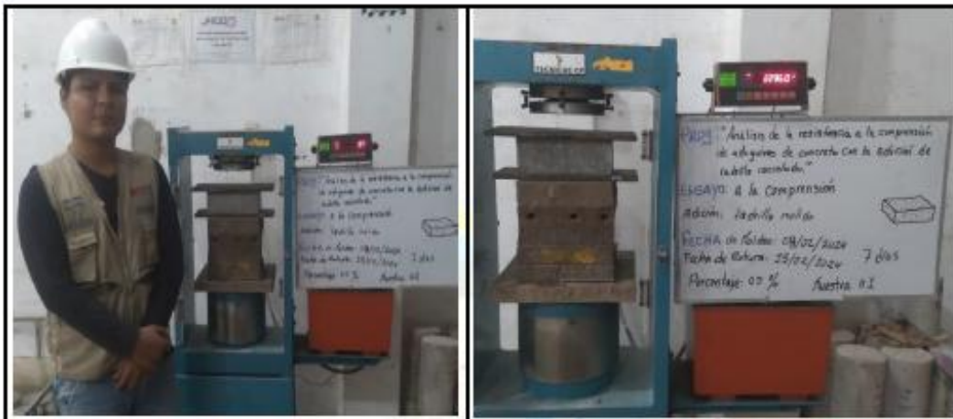
Fotos nº 17-18: En las imágenes podemos observar la resistencia a la compresión axial de los adoquines de concreto.
