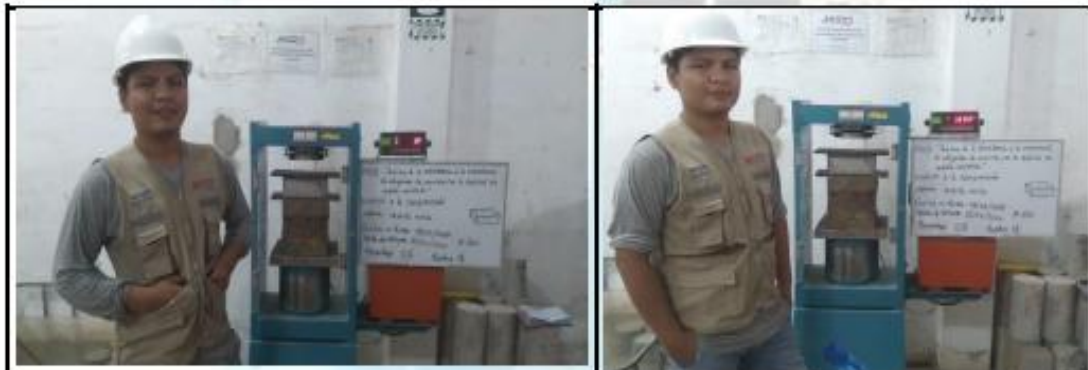
Fotos n° 15-16: En las imágenes podemos observar la resistencia a la compresión axial de los adoquines de concreto.
