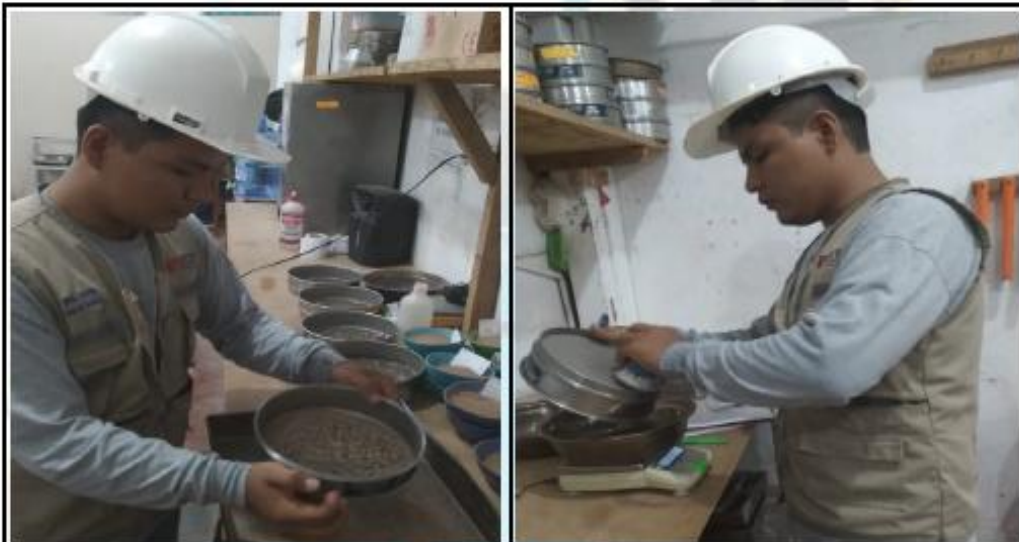
Fotos nº 03-04: En las imágenes se puede apreciar el ensayo de análisis granulométricos.
